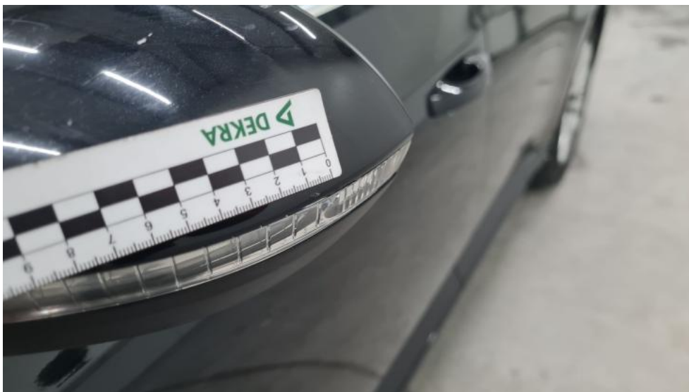
Fot. 51. Lusterko zew L - Rysa/odprysk 1
