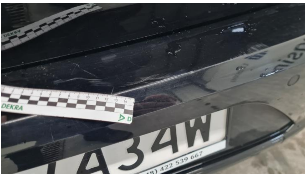
Fot. 102. Zderzak tylny - Rysa/odprysk 1
