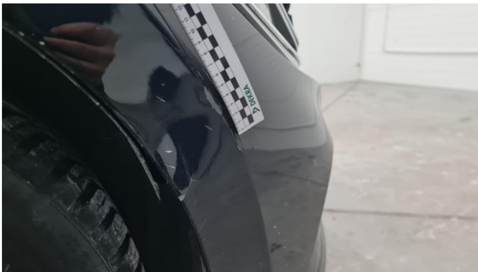
Fot. 41. Zderzak - Wgniecenie/odkształcenie 1
