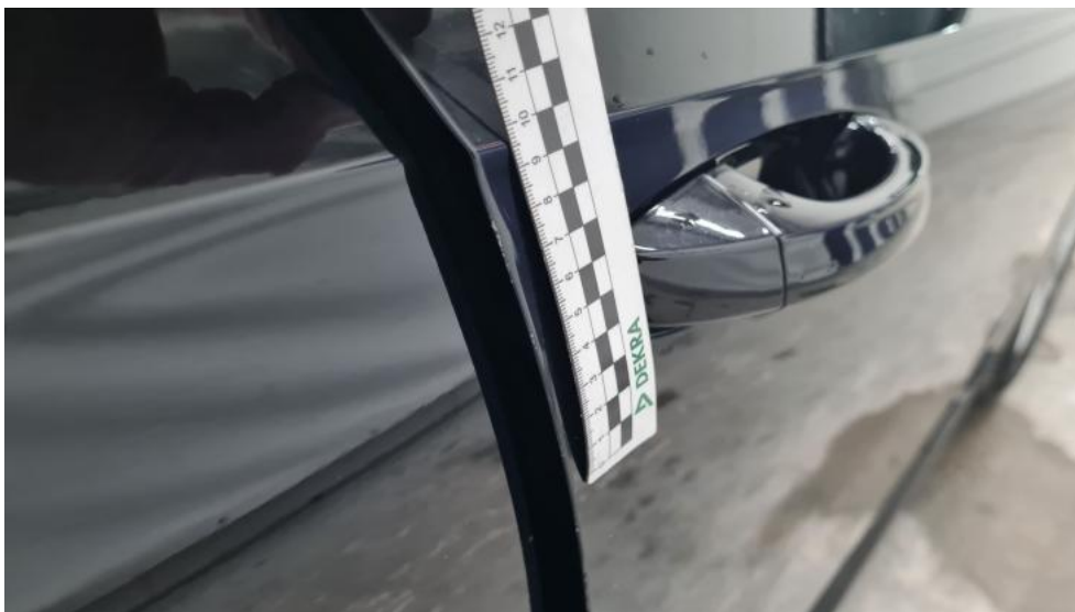
Fot. 43. Drzwi przednie P - Rysa/odprysk 1
