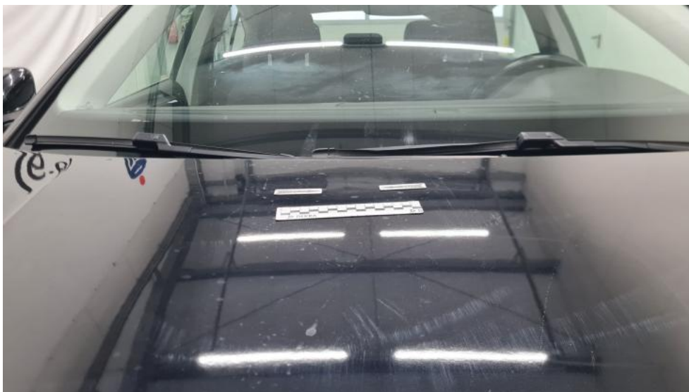
Fot. 37. Pokrywa komory silnika - Wgniecenie/odkształcenie 1
