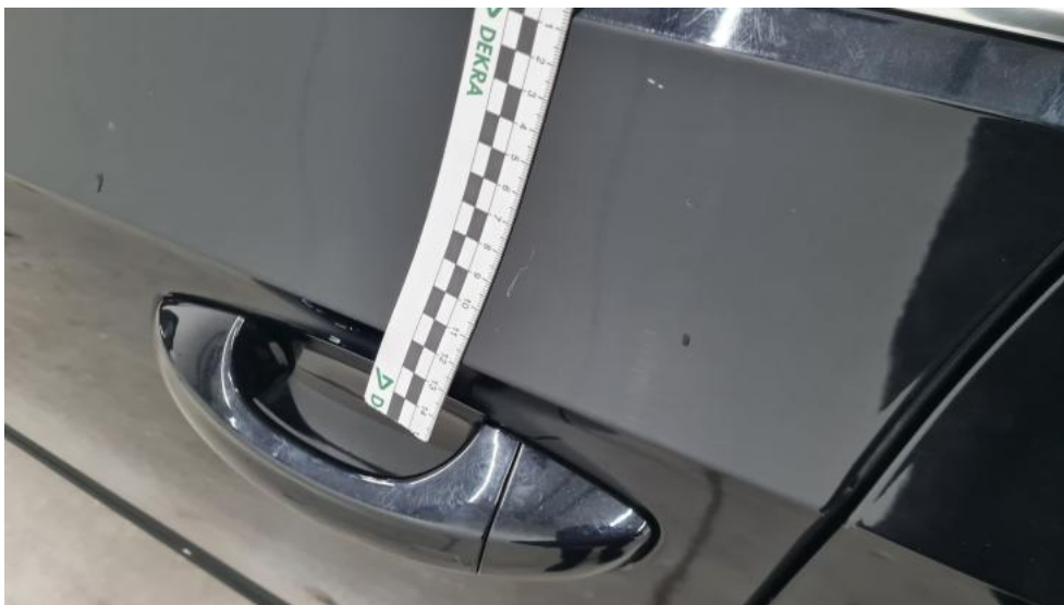
Fot. 49. Drzwi przed L - Rysa/odprysk 1
