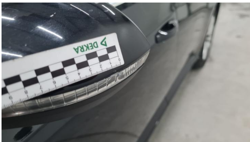
Fot. 107. Lusterko zew L - Rysa/odprysk 1
