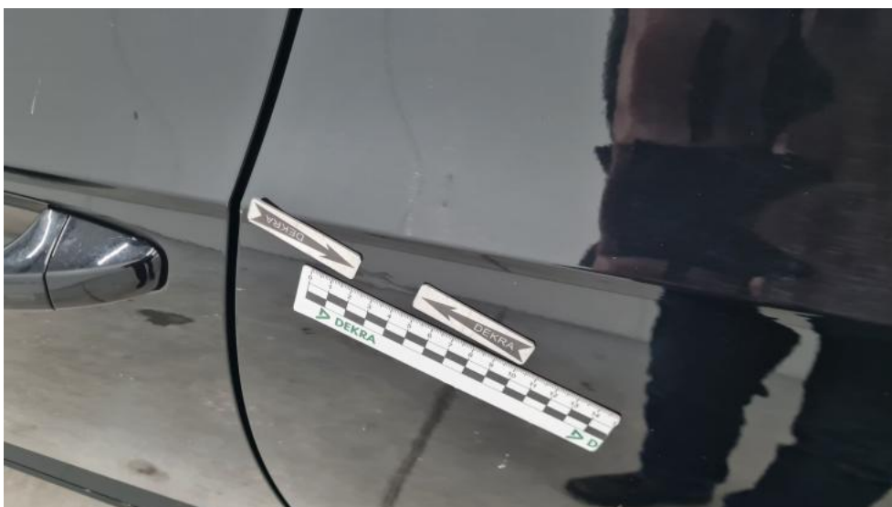
Fot. 106. Drzwi tylne L - Wgniecenie/odkształcenie 1
