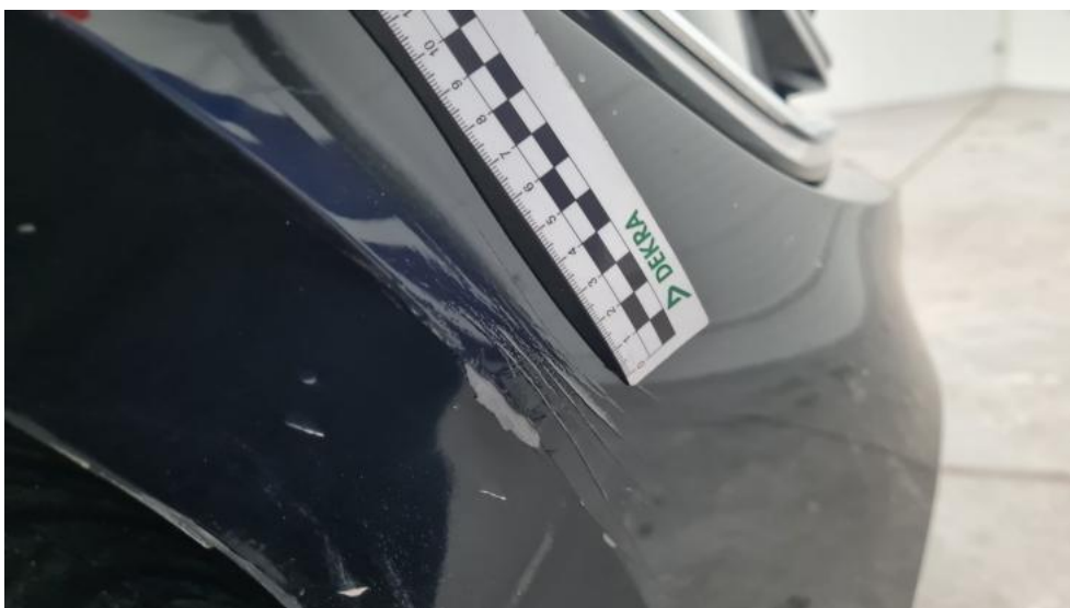
Fot. 42. Zderzak - Pęknięcie/rozerwanie 1
