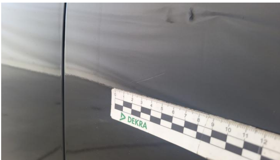
Fot. 63. Błotnik przedni P - Rysa/odprysk 1
