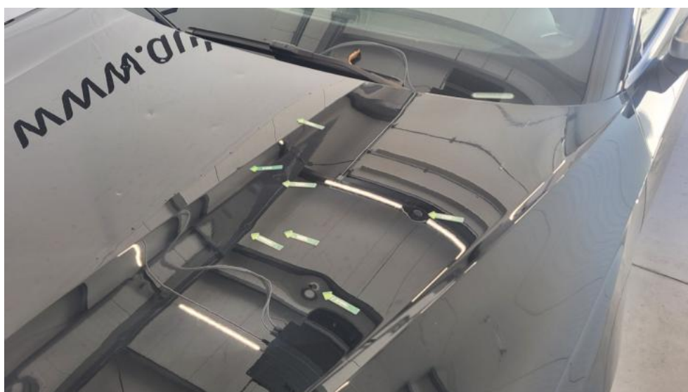
Fot. 54. Pokrywa komory silnika - Wgniecenie/odkształcenie 1
