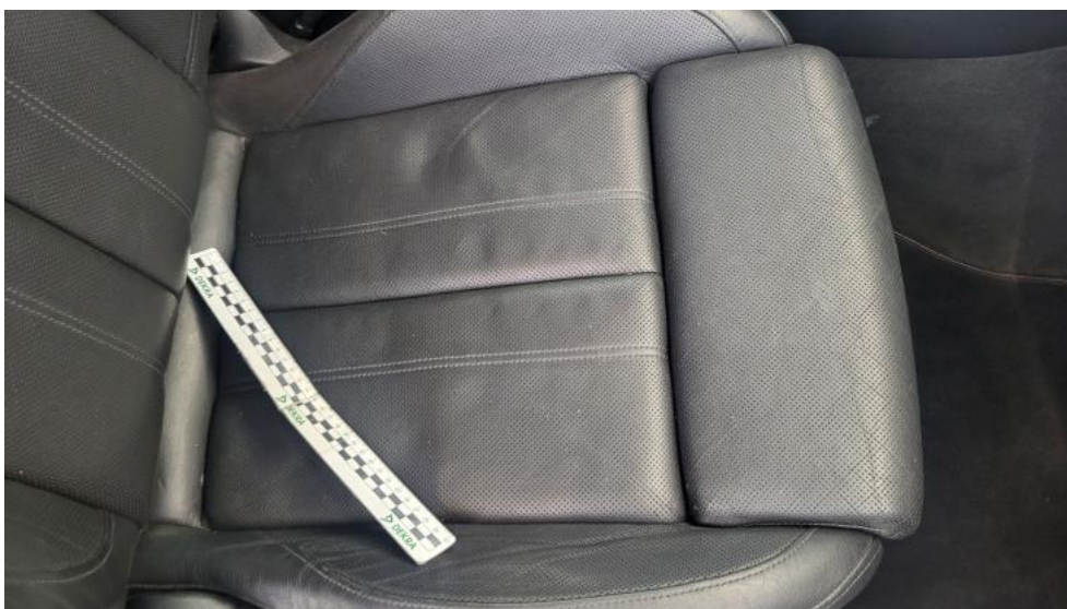
Fot. 116. Fotel prz. praw. - Wgniecenie/odkształcenie 1
