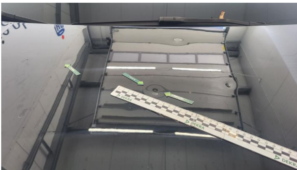
Fot. 56. Pokrywa komory silnika() - Wgniecenie/odkształcenie 3
