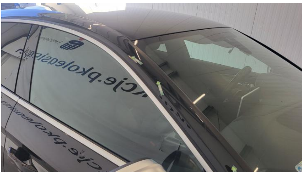
Fot. 80. Słupek przedni P - Wgniecenie/odkształcenie 2
