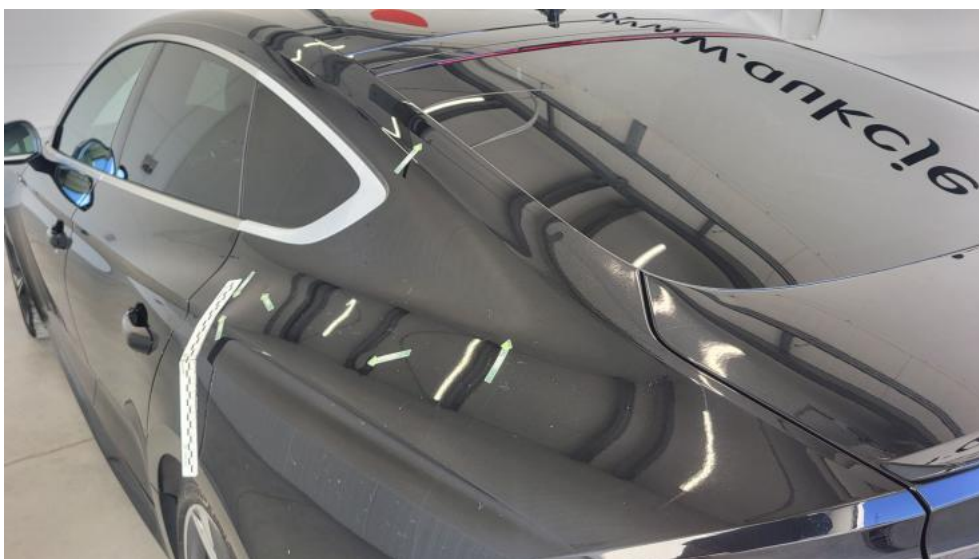
Fot. 101. Błotnik tylny L / Ściana boczna L - Wgniecenie/odkształcenie 2
