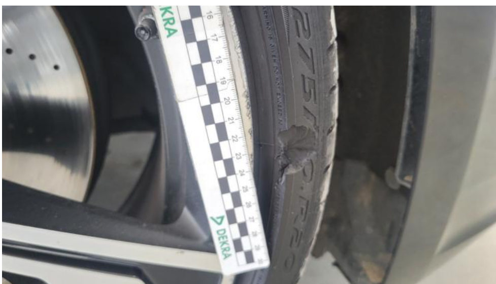
Fot. 68. Opona przednia P - Wgniecenie/odkształcenie 1
