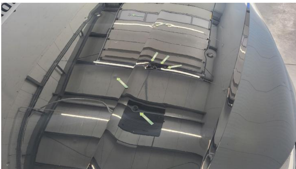
Fot. 55. Pokrywa komory silnika - Wgniecenie/odkształcenie 2
