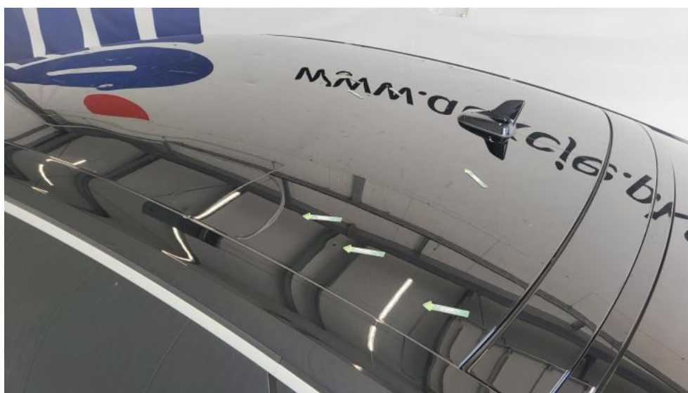
Fot. 98. Dach - Wgniecenie/odkształcenie 2
