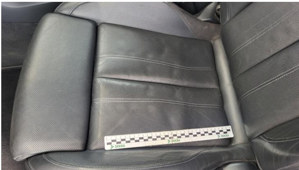
Fot. 115. Fotel prz. lew. - Wgniecenie/odkształcenie 1
