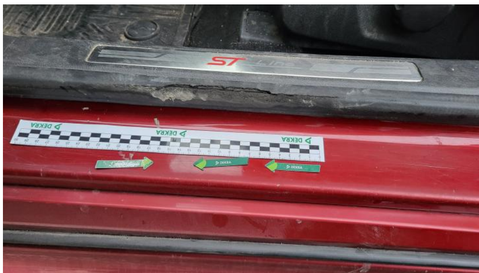
Fot. 97. Próg L - Wgniecenie/odkształcenie 2
