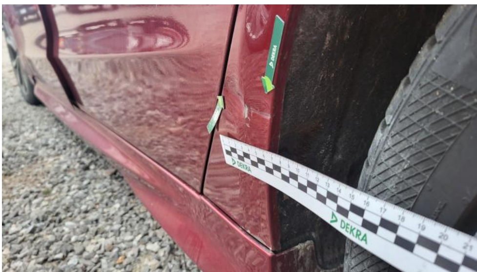
Fot. 84. Błotnik tylny L / Ściana boczna L - Wgniecenie/odkształcenie 2
