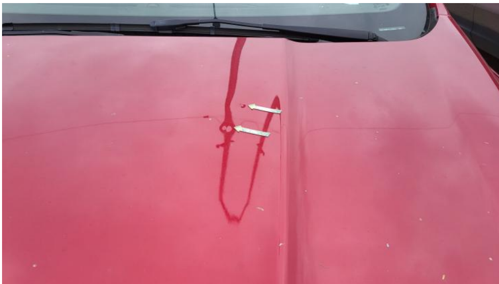
Fot. 47. Pokrywa komory silnika - Wgniecenie/odkształcenie 1
