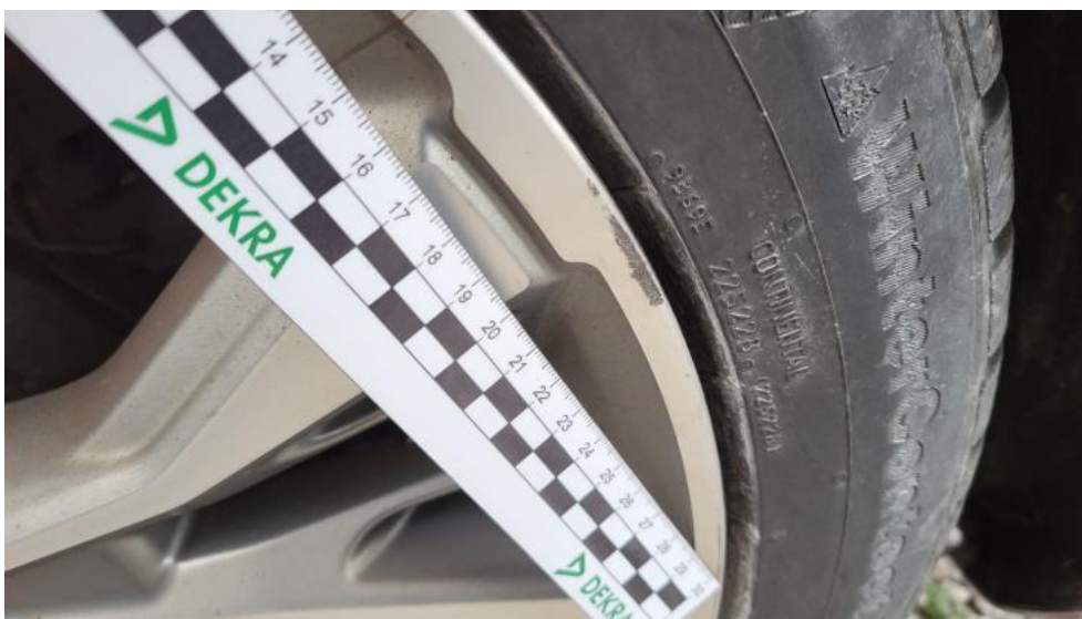
Fot. 87. Felga aluminiowa tylna L - Rysa/odprysk 2
