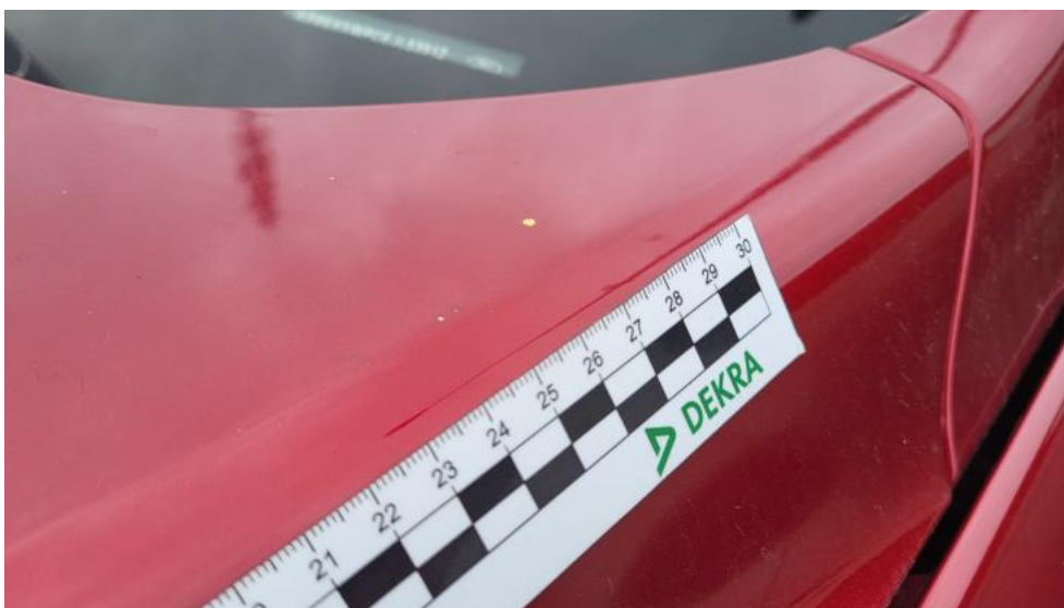
Fot. 44. Pokrywa komory silnika - Rysa/odprysk 1
