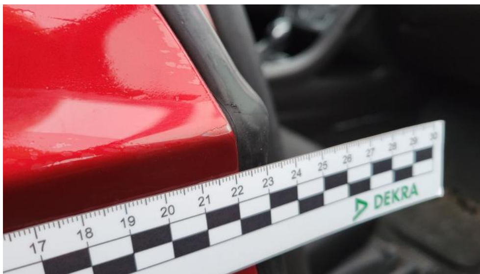
Fot. 61. Drzwi tylne P() - Rysa/odprysk 3
