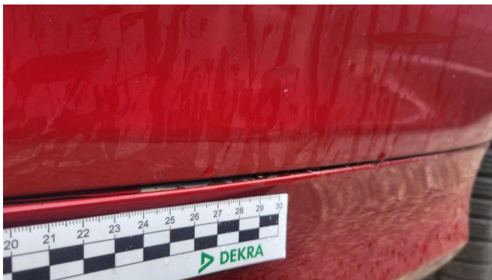
Fot. 78. Zderzak tylny - Rysa/odprysk 2
