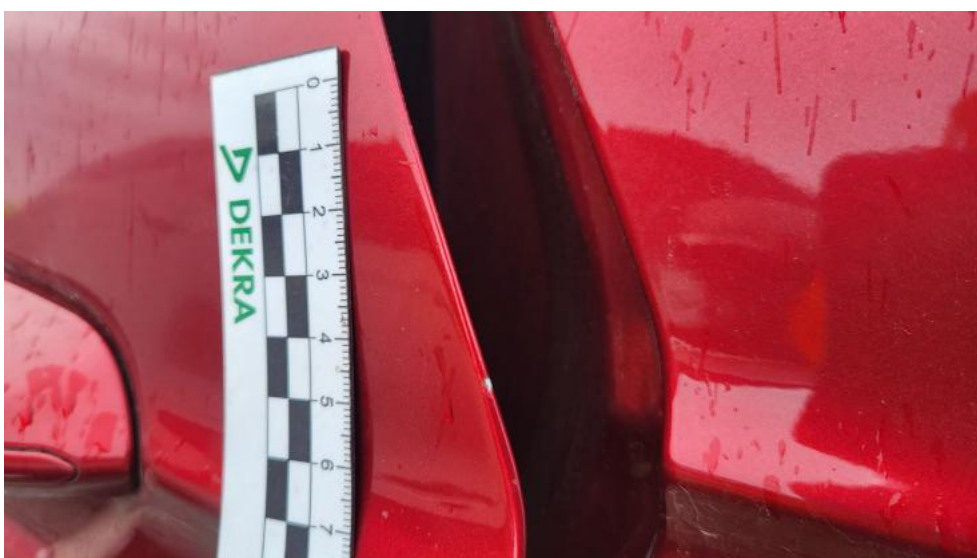
Fot. 92. Drzwi tylne L - Rysa/odprysk 1
