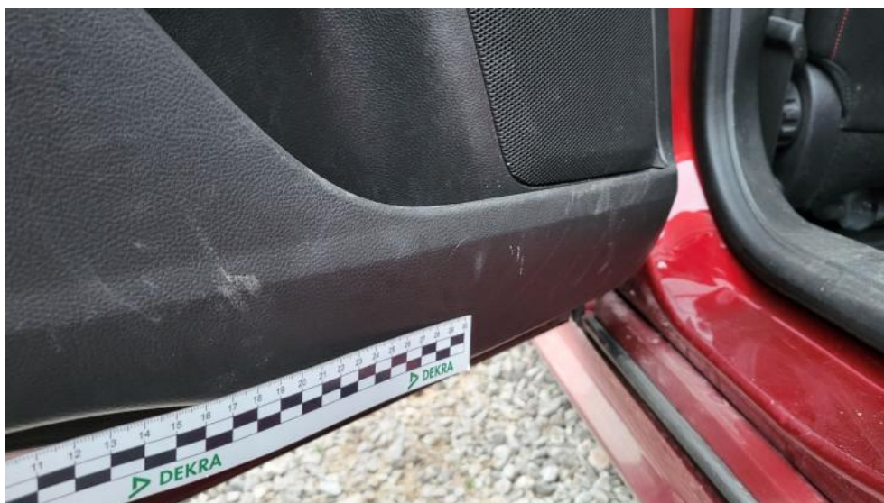
Fot. 122. Tapicerka drzwi tylnych L - Rysa/odprysk 1
