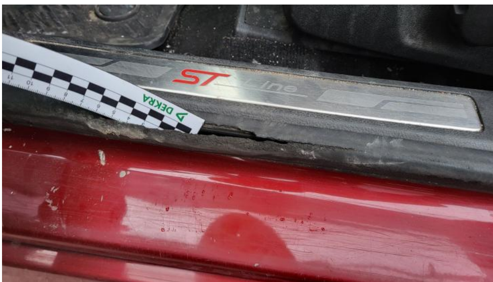
Fot. 125. Uszczelka drzwi przednich L - Pęknięcie/rozerwanie 1
