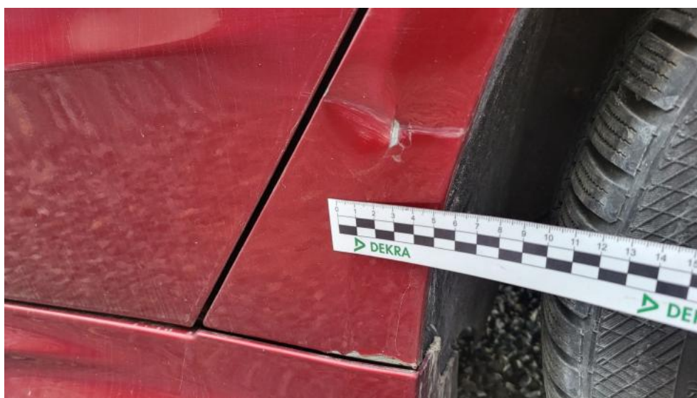
Fot. 82. Błotnik tylny L / Ściana boczna L - Rysa/odprysk 2
