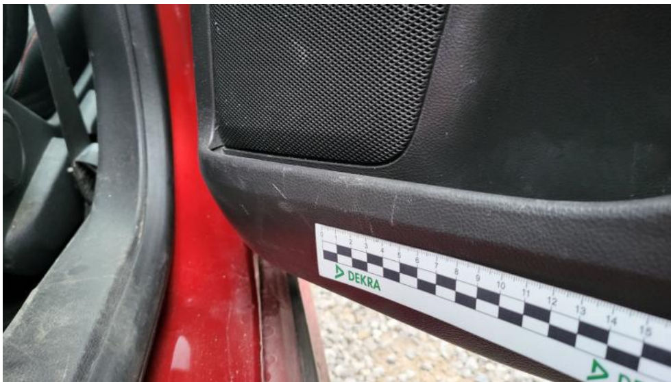
Fot. 123. Tapicerka drzwi tylnych P - Rysa/odprysk 1
