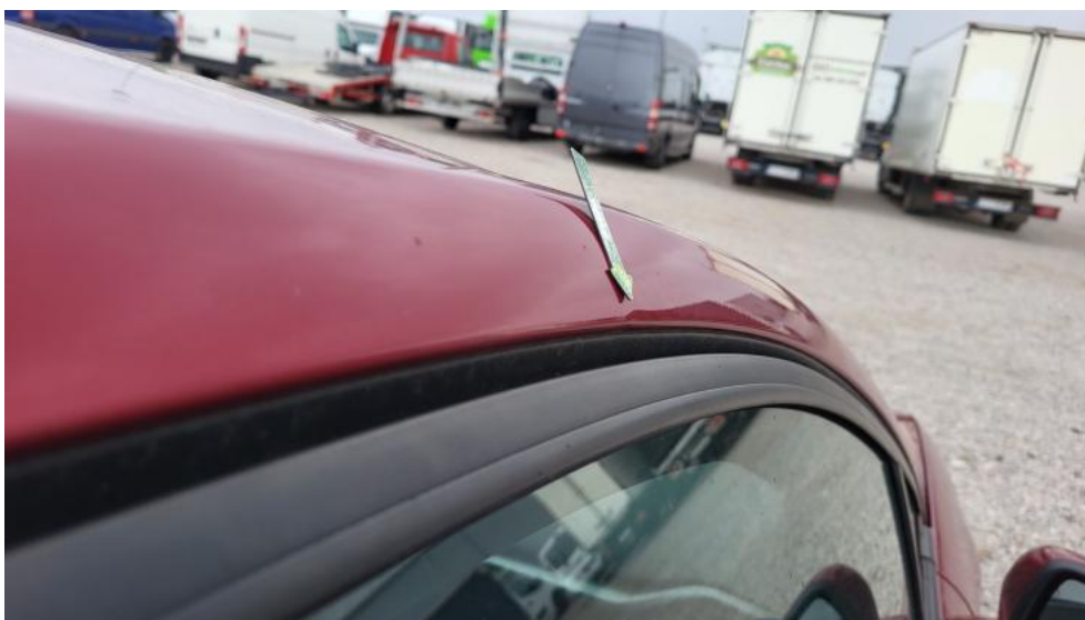
Fot. 64. Słupek przedni P - Wgniecenie/odkształcenie 1
