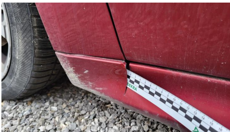
Fot. 98. Próg L - Pęknięcie/rozerwanie 1
