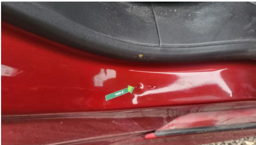
Fot. 69. Błotnik tylny P / Ściana boczna P - Wgniecenie/odkształcenie 2
