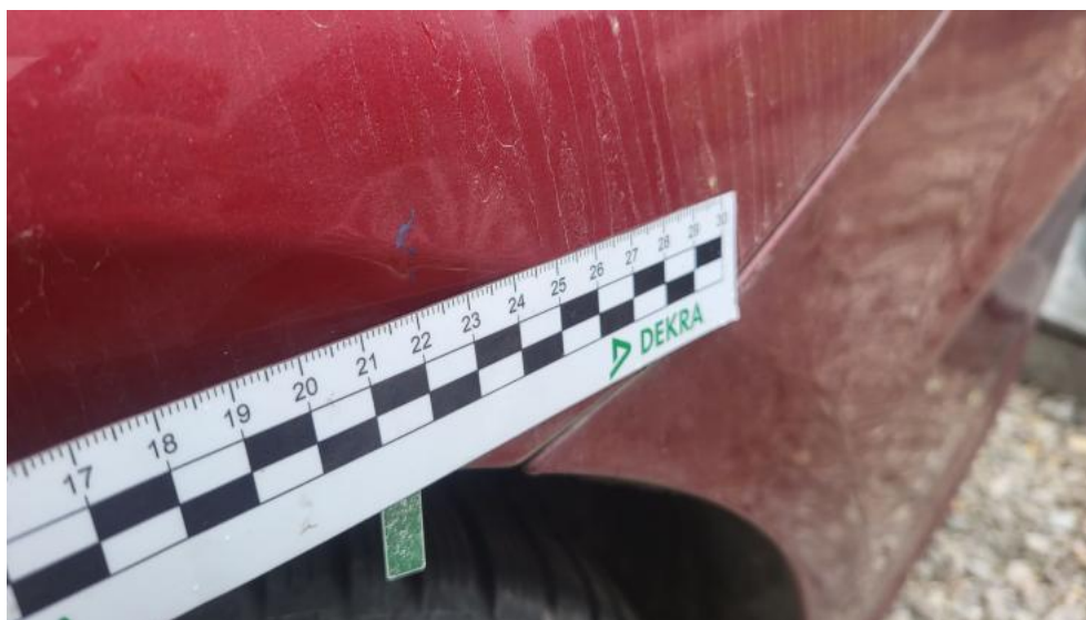
Fot. 81. Błotnik tylny L / Ściana boczna L - Rysa/odprysk 1
