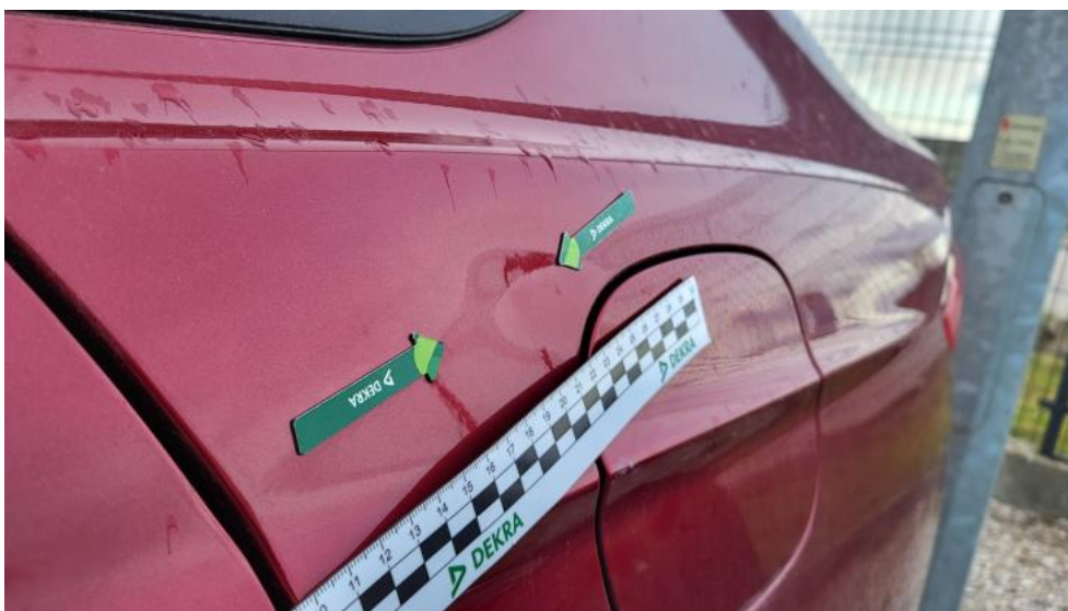
Fot. 85. Błotnik tylny L / Ściana boczna L() - Wgniecenie/odkształcenie 3
