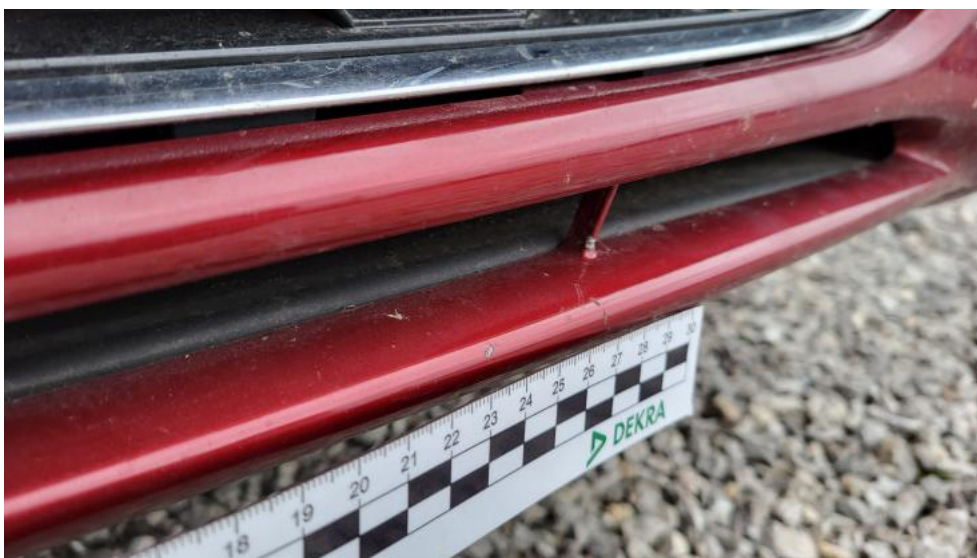
Fot. 48. Spoiler zderzaka przedniego - Rysa/odprysk 1
