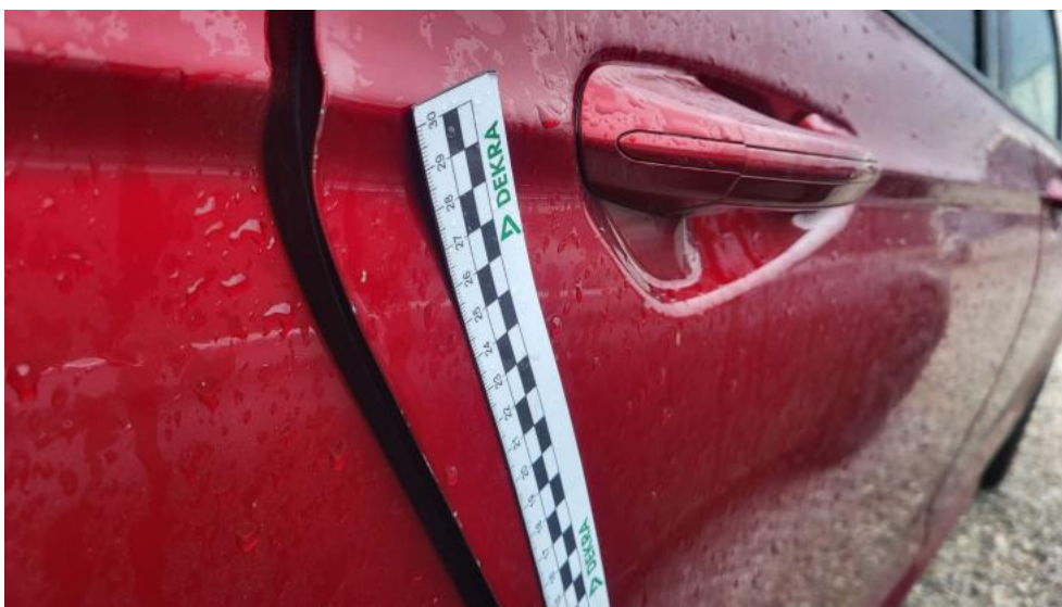
Fot. 59. Drzwi tylne P - Rysa/odprysk 1
