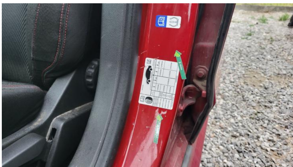
Fot. 102. Słupek środkowy L - Wgniecenie/odkształcenie 1
