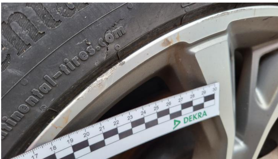
Fot. 86. Felga aluminiowa tylna L - Rysa/odprysk 1
