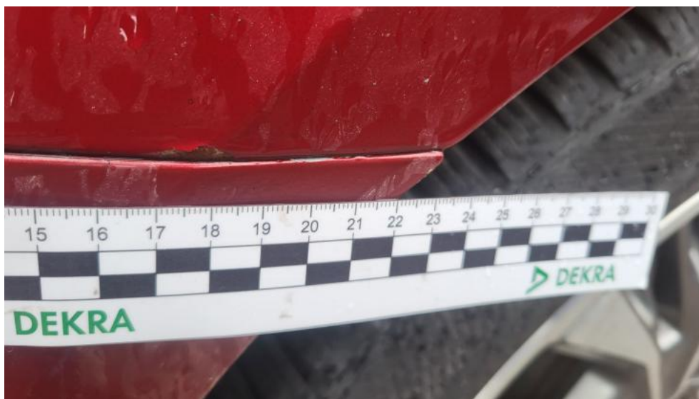
Fot. 77. Zderzak tylny - Rysa/odprysk 1
