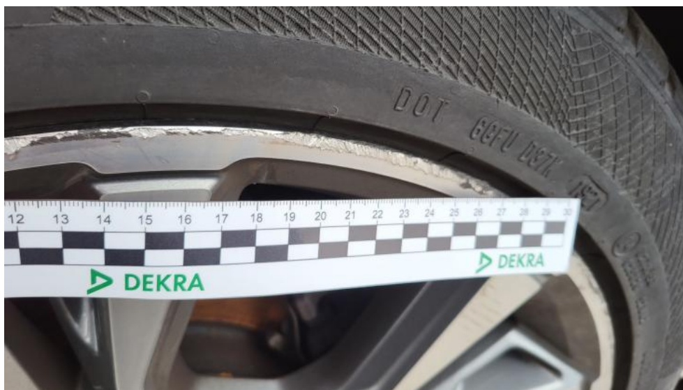
Fot. 55. Felga aluminiowa przednia P - Rysa/odprysk 1
