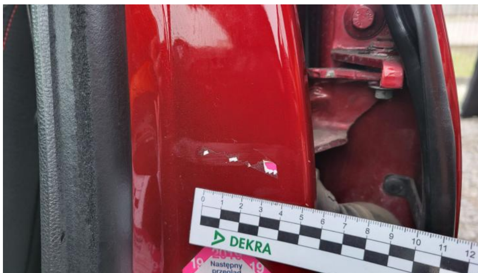
Fot. 99. Słupek środkowy L - Rysa/odprysk 1
