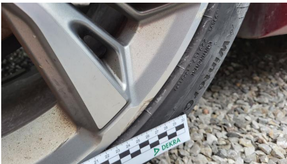
Fot. 73. Felga aluminiowa tylna P - Rysa/odprysk 2
