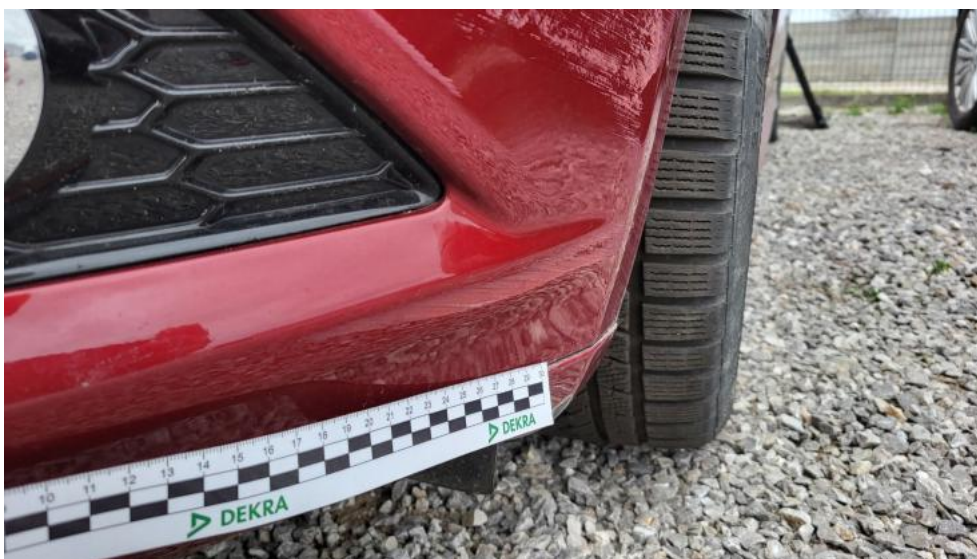
Fot. 51. Zderzak() - Rysa/odprysk 3
