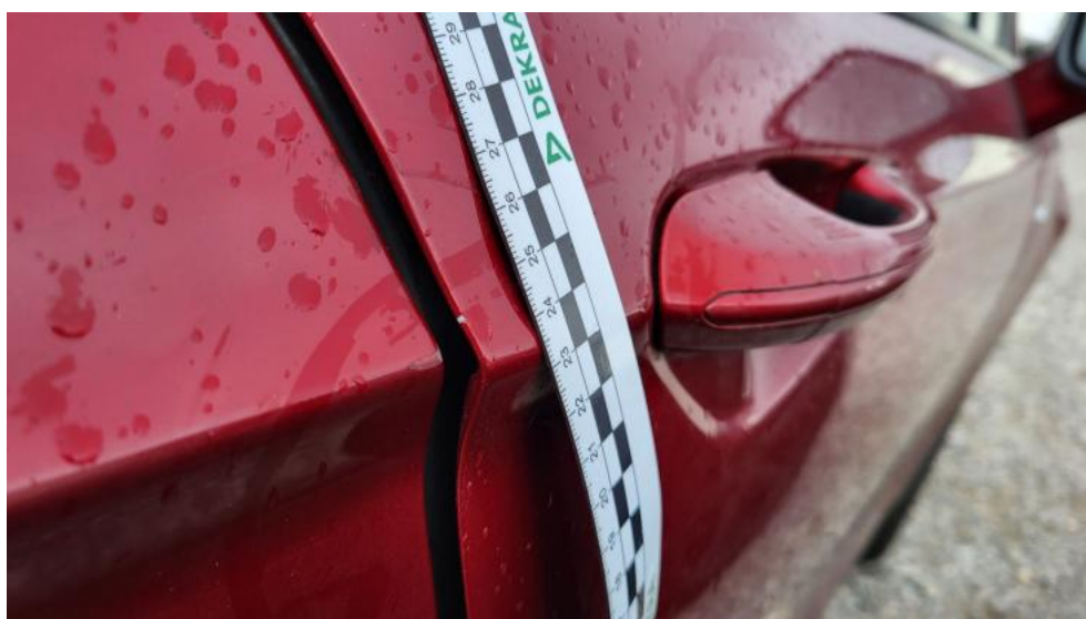
Fot. 58. Drzwi przednie P - Rysa/odprysk 2
