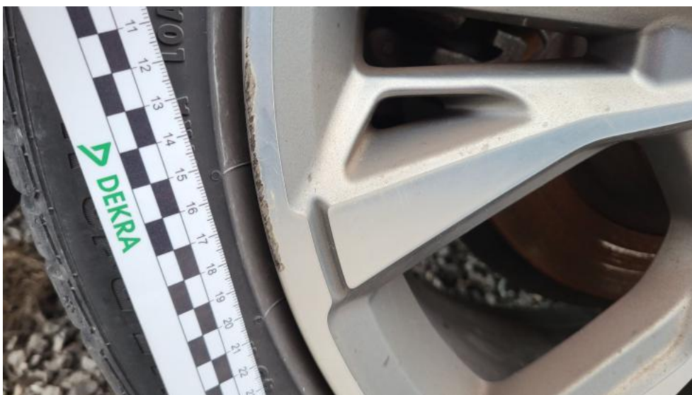
Fot. 72. Felga aluminiowa tylna P - Rysa/odprysk 1
