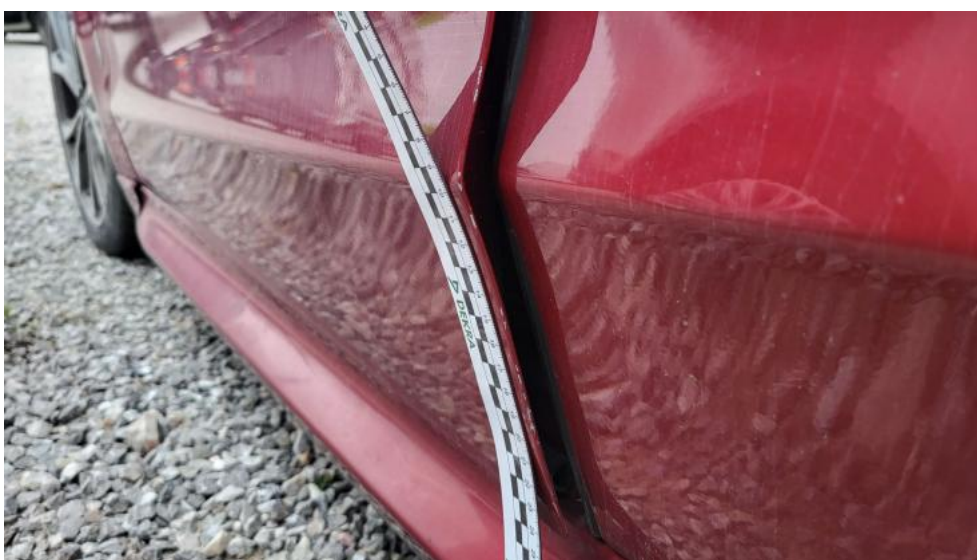
Fot. 90. Drzwi przed L() - Rysa/odprysk 3
