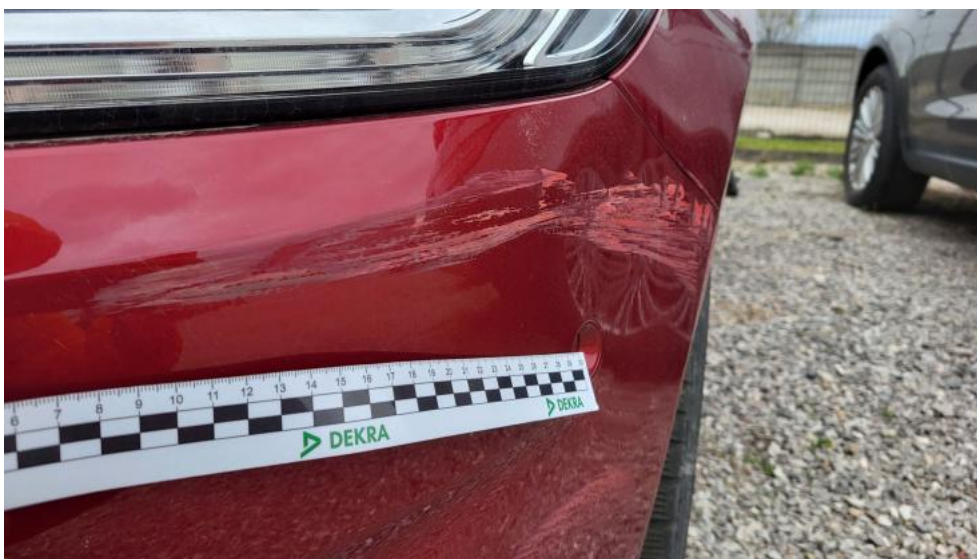
Fot. 49. Zderzak - Rysa/odprysk 1
