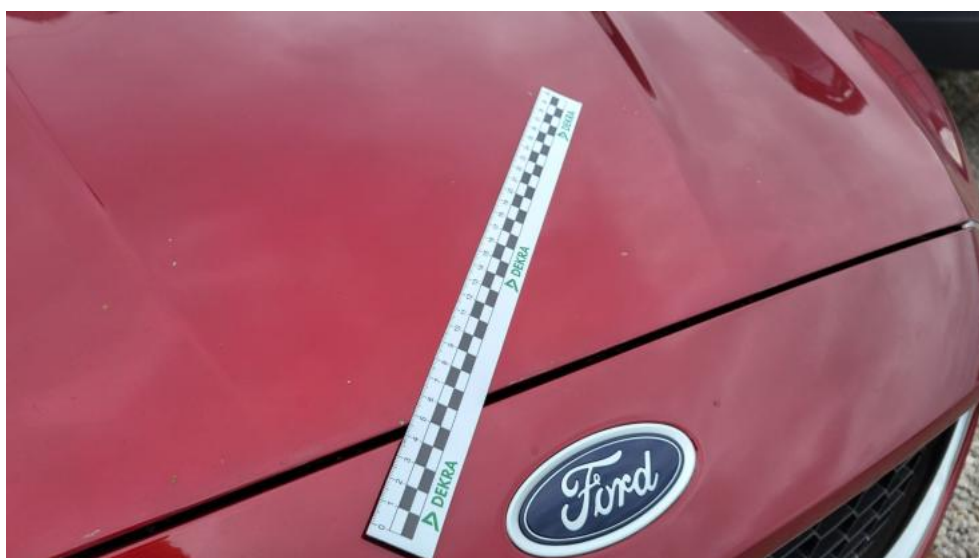
Fot. 46. Pokrywa komory silnika() - Rysa/odprysk 3
