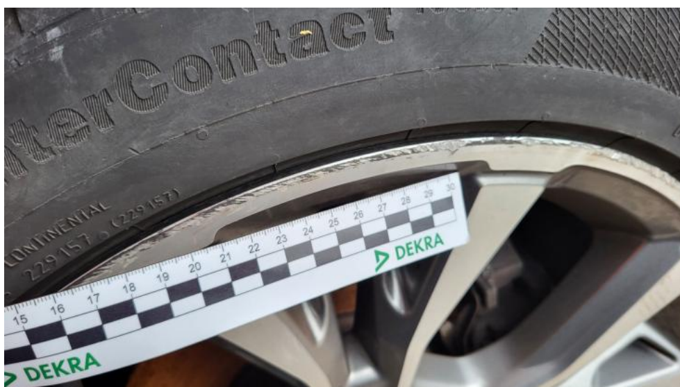
Fot. 56. Felga aluminiowa przednia P - Rysa/odprysk 2
