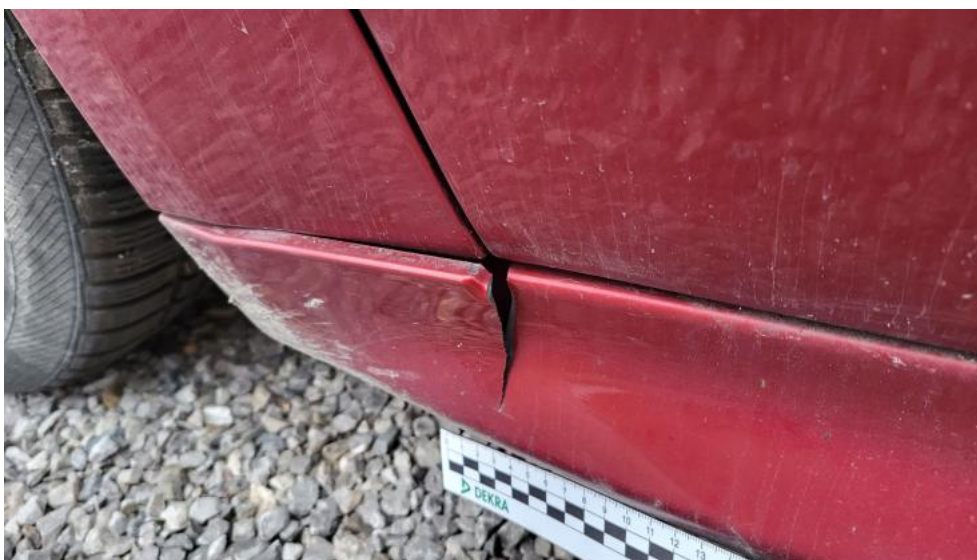
Fot. 96. Próg L - Wgniecenie/odkształcenie 1
