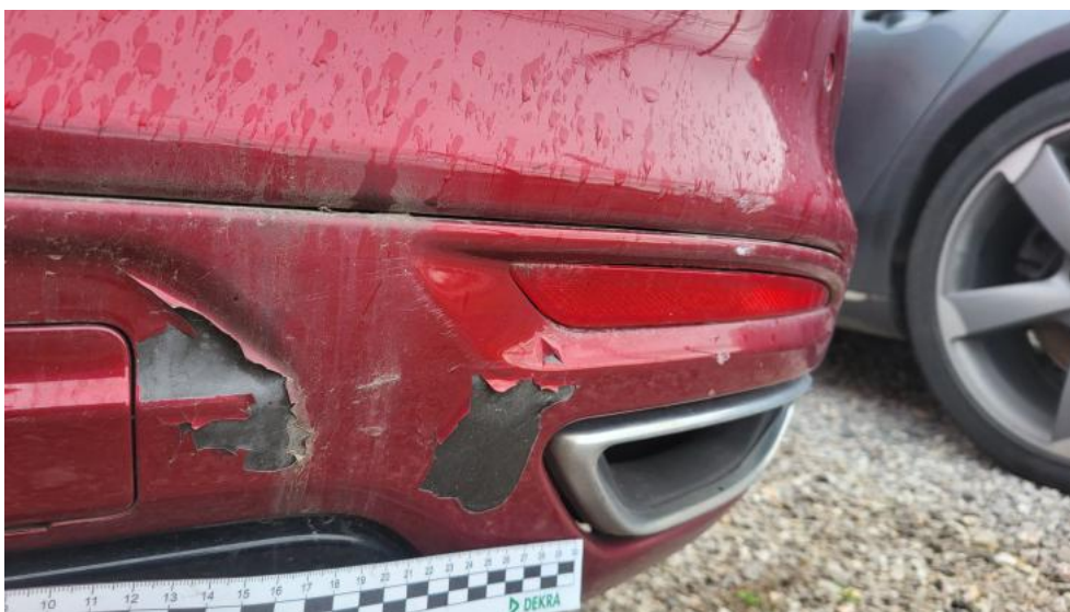
Fot. 79. Zderzak tylny() - Rysa/odprysk 3
