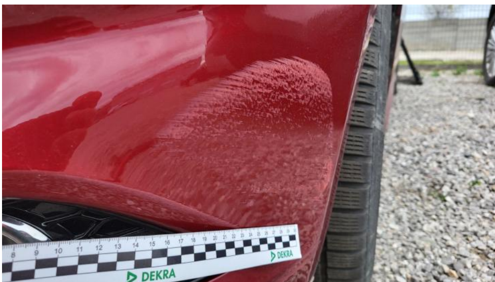
Fot. 50. Zderzak - Rysa/odprysk 2
