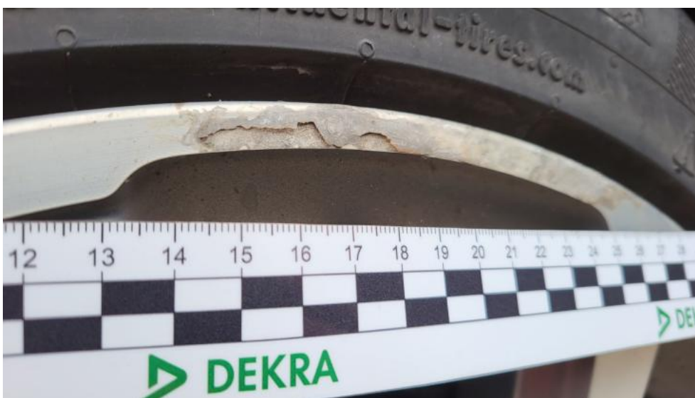
Fot. 74. Felga aluminiowa tylna P() - Rysa/odprysk 3
