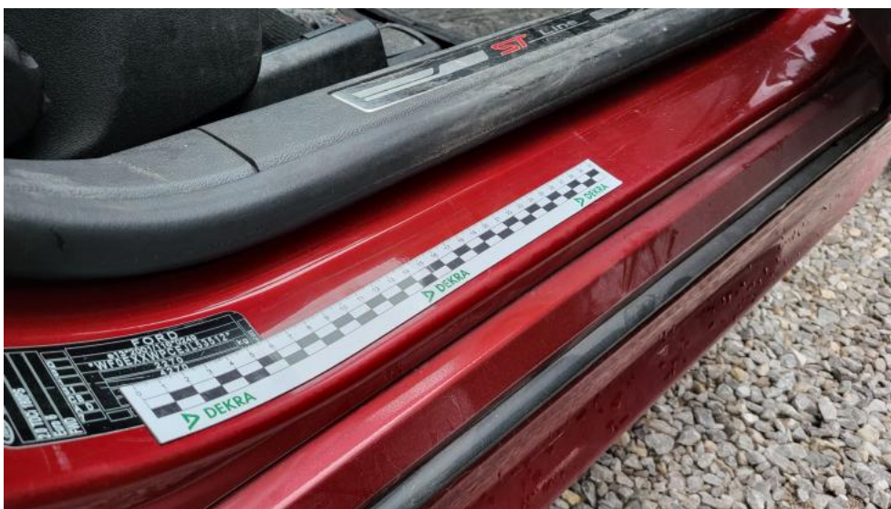
Fot. 63. Próg P - Rysa/odprysk 1
