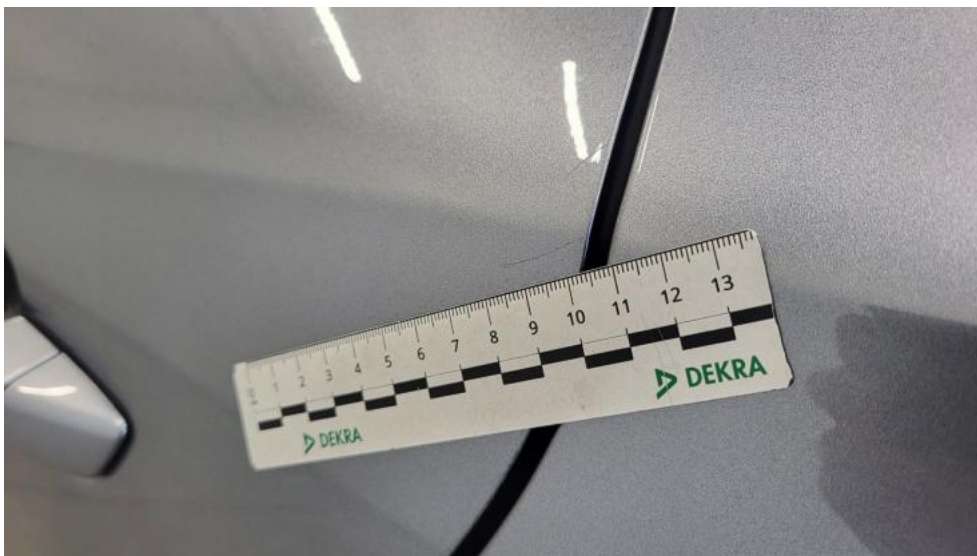
Fot. 57. Drzwi tylne L - Rysa/odprysk 1
