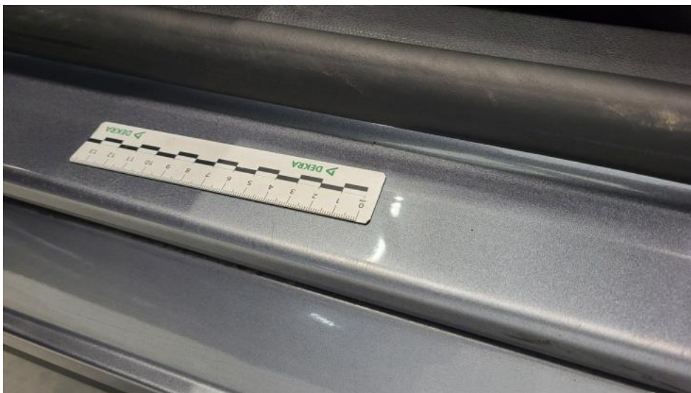
Fot. 59. Próg L - Rysa/odprysk 2
