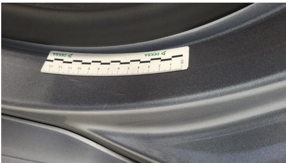
Fot. 58. Próg L - Rysa/odprysk 1
