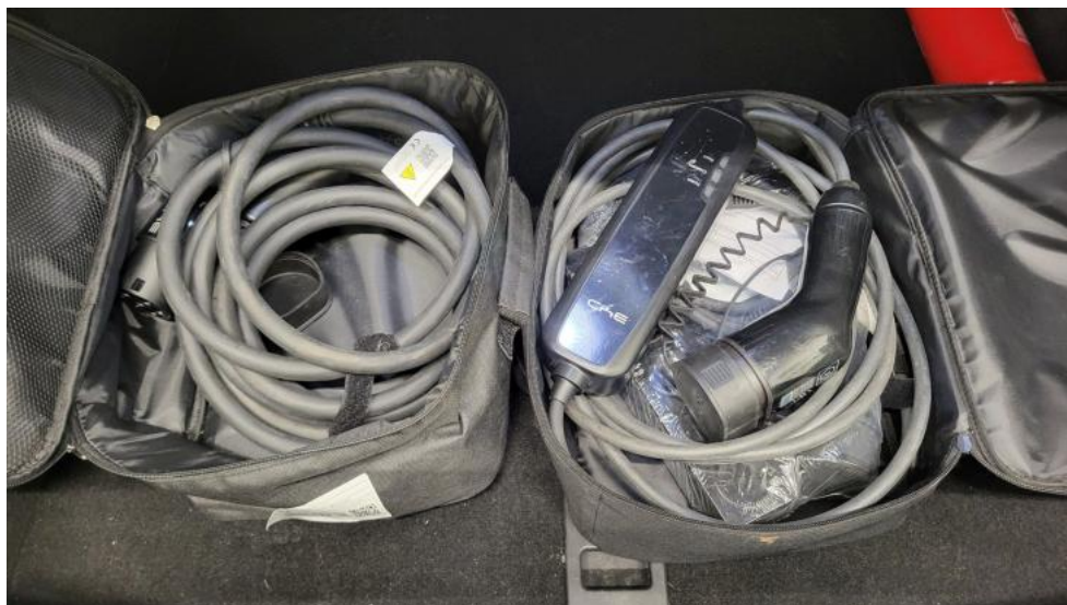
Fot. 33. Przewód ładowania baterii trakcyjnej
