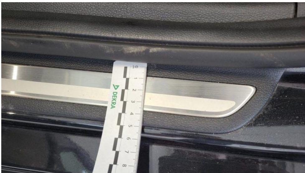
Photo 76. Listwy progowe lew. - Rysa/odprysk 1
