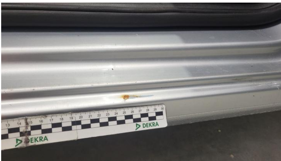
Fot. 43. Próg P - Rysa/odprysk 1
