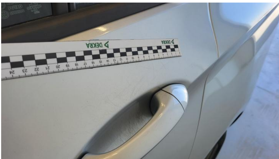
Photo 62. Drzwi tylne L - Rysa/odprysk 1
