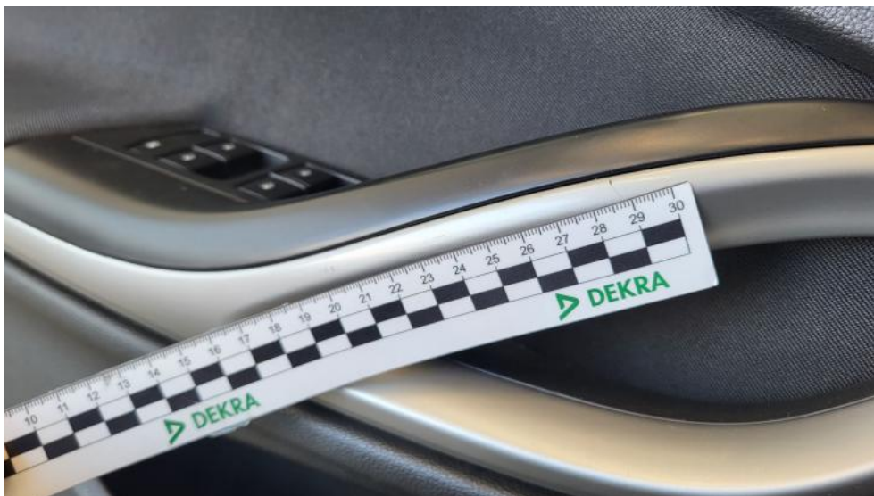
Photo 72. Uchwyt drzwi prze L - Rysa/odprysk 1
