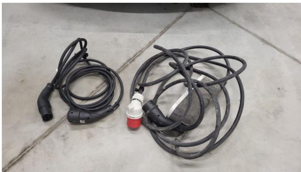
Photo 34. Przewód ładowania baterii trakcyjnej
