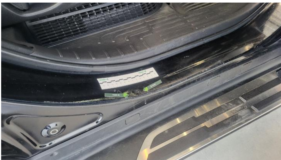
Photo 58. Próg P - Wgniecenie/odkształcenie 2
