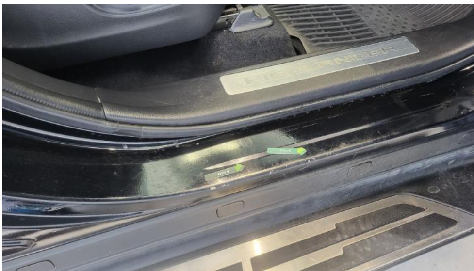
Photo 57. Próg P - Wgniecenie/odkształcenie 1
