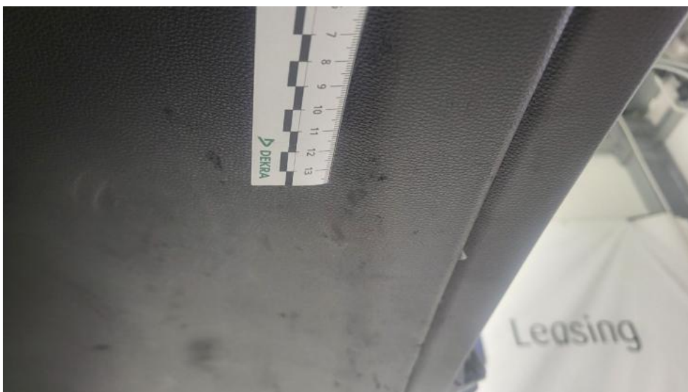
Photo 78. Wykładzina pokrywy tylnej - Rysa/odprysk 1
