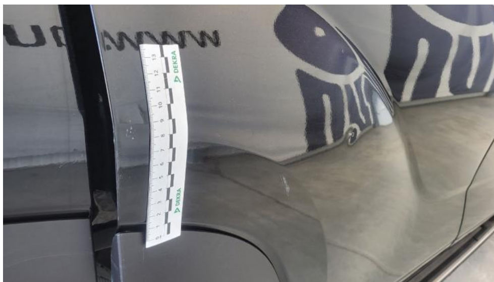
Photo 55. Drzwi tylne P - Rysa/odprysk 1
