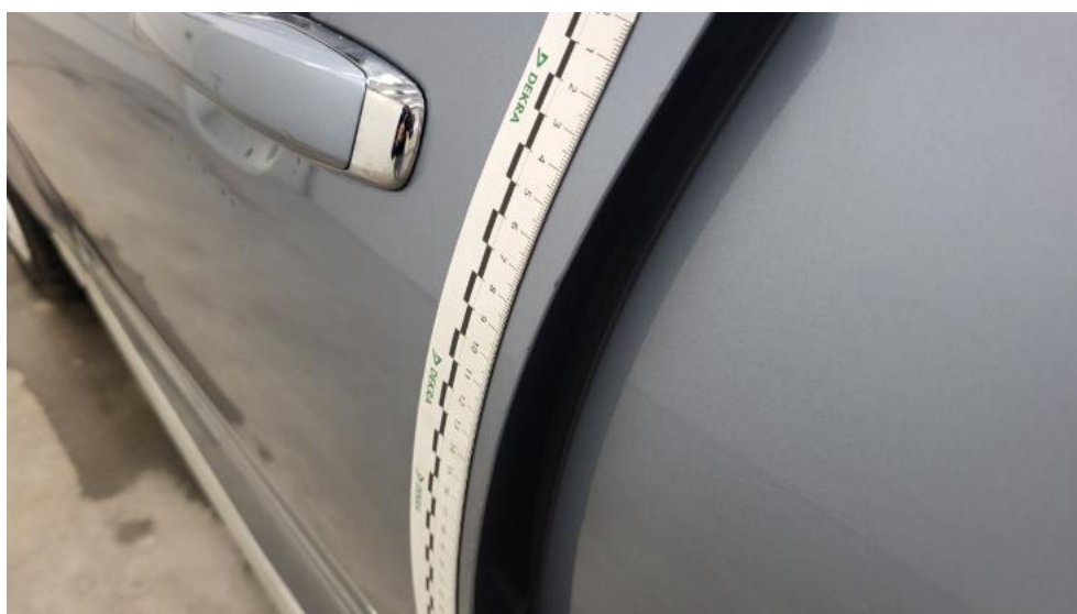
Fot. 74. Drzwi przed L - Rysa/odprysk 1
