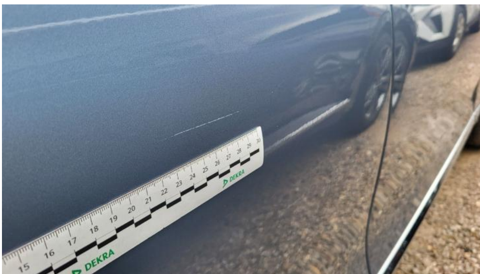
Fot. 55. Drzwi tylne P - Rysa/odprysk 1
