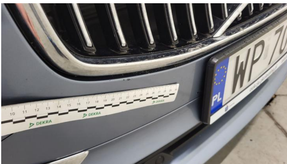
Fot. 52. Zderzak - Rysa/odprysk 2
