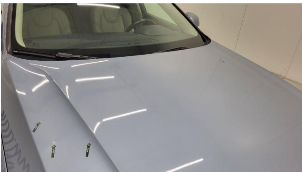
Fot. 46. Pokrywa komory silnika - Wgniecenie/odkształcenie 1
