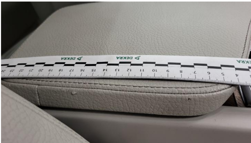
Fot. 83. Podkietnik środkowy przedni - Pęknięcie/rozerwanie 1
