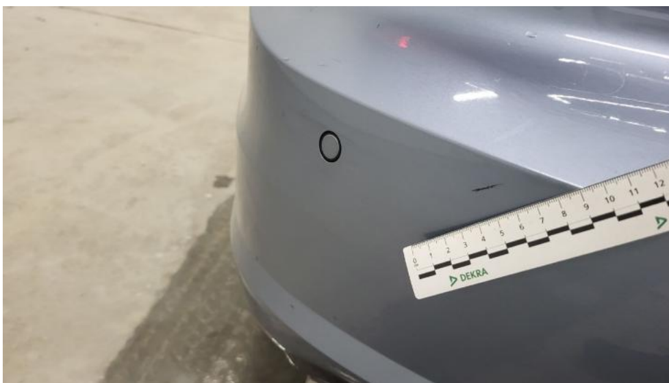
Fot. 65. Zderzak tylny - Rysa/odprysk 2
