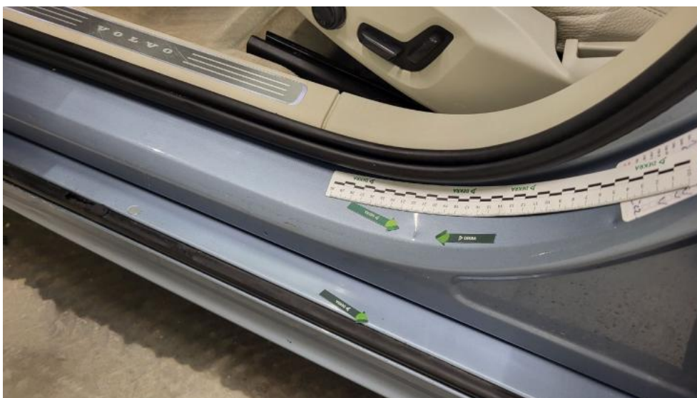
Fot. 78. Próg L - Wgniecenie/odkształcenie 1
