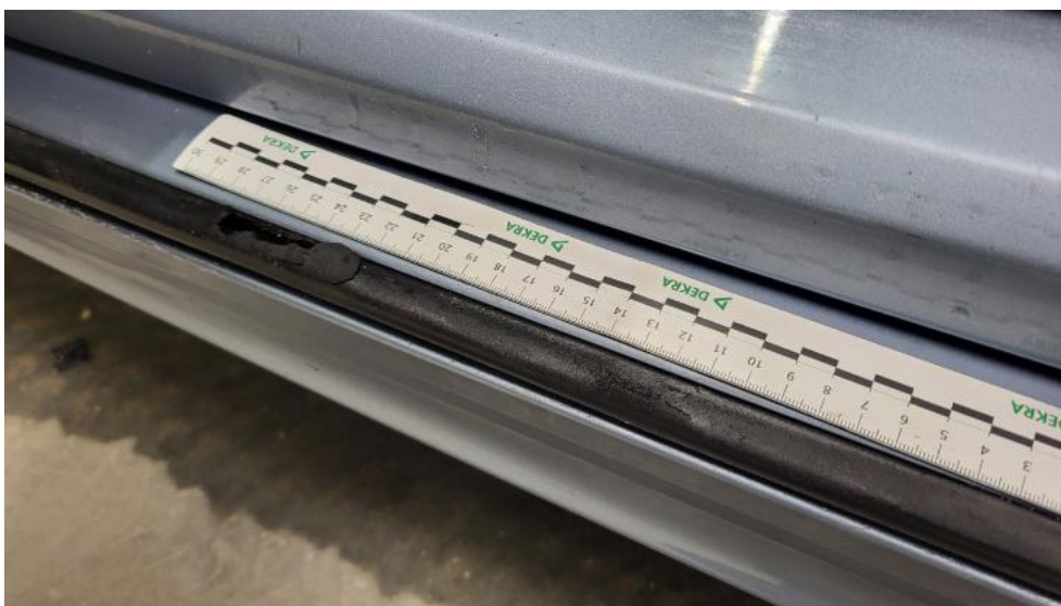
Fot. 94. Uszczelki progowe lew. - Pęknięcie/rozerwanie 1
