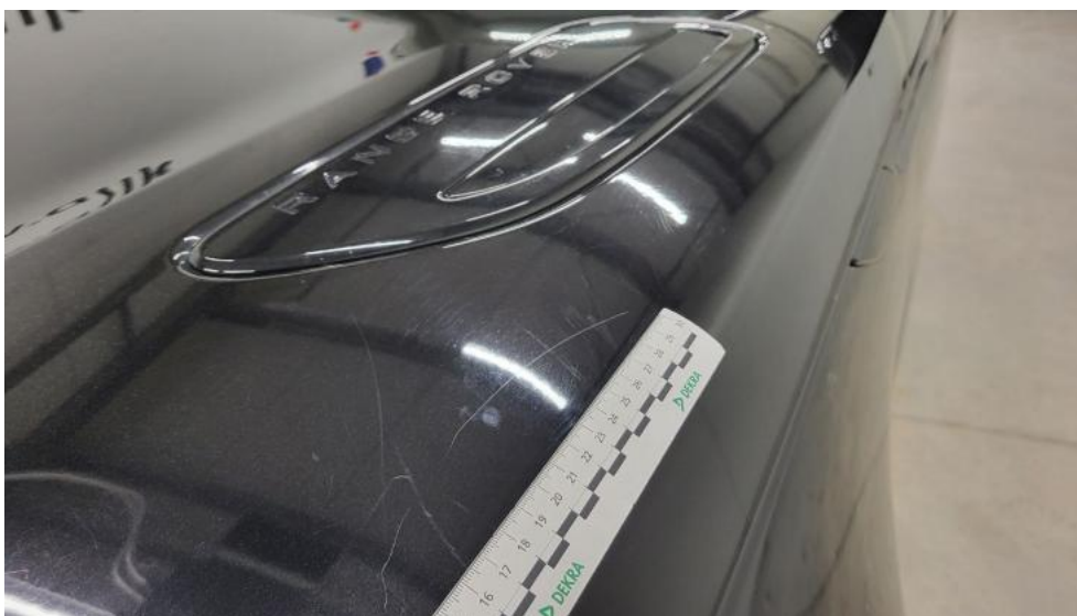
Photo 45. Pokrywa komory silnika - Rysa/odprysk 1
