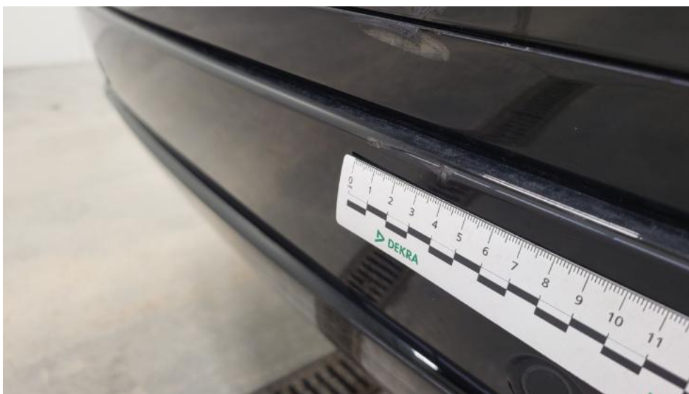
Photo 61. Zderzak tylny cz dolna - Wgniecenie/odkształcenie 1
