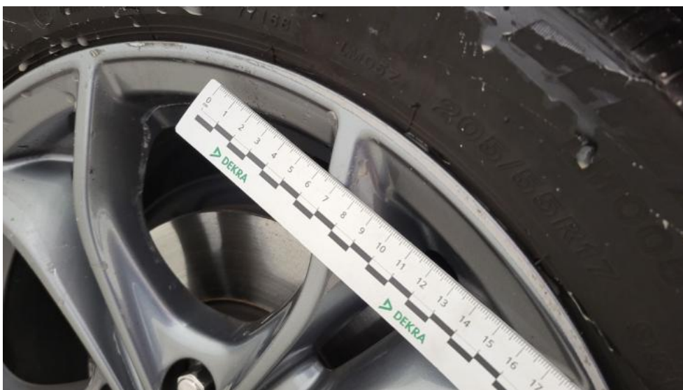
Photo 48. Felga aluminiowa przednia P - Rysa/odprysk 1
