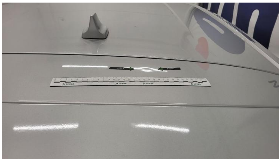
Photo 55. Pokrywy bagażnika - Wgniecenie/odkształcenie 1
