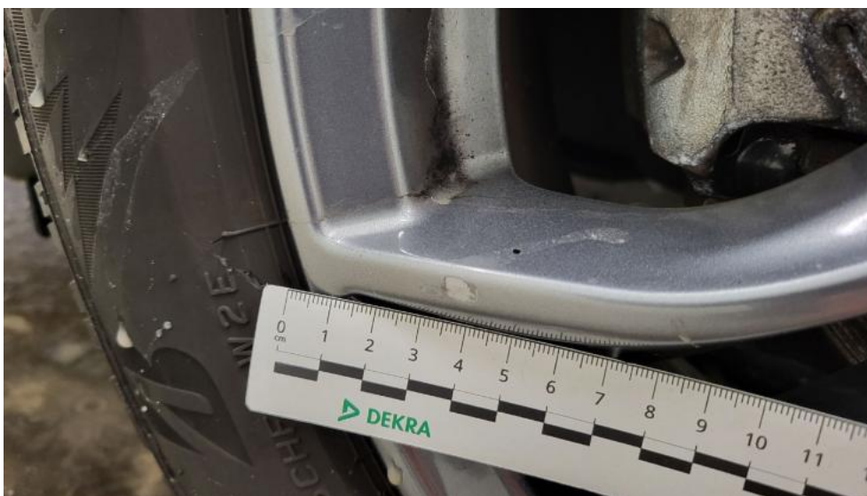
Photo 67. Felga Aluminiowa przednia L - Rysa/odprysk 1
