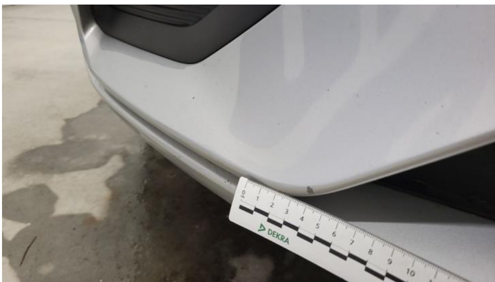
Photo 40. Kratka/zaślepka halogenu P - Rysa/odprysk 1
