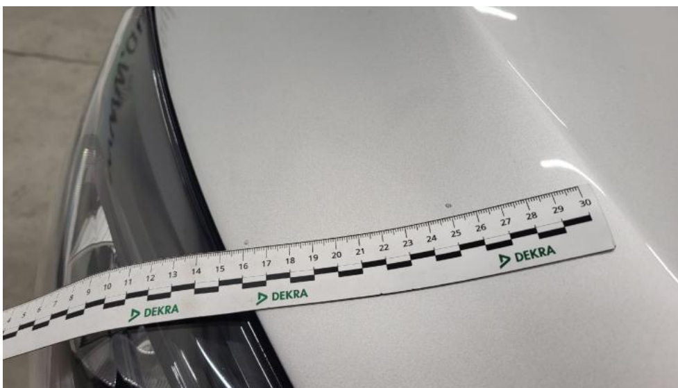
Photo 41. Pokrywa komory silnika - Rysa/odprysk 1
