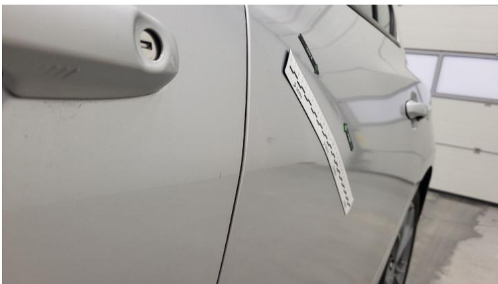
Photo 66. Drzwi tylne L - Wgniecenie/odkształcenie 1
