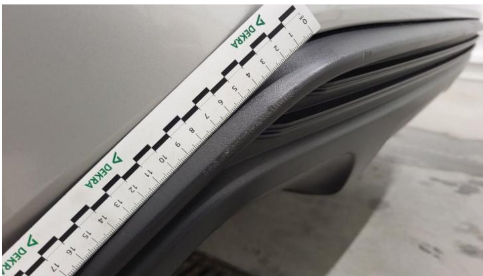
Photo 59. Zderzak tylny cz dolna - Rysa/odprysk 1
