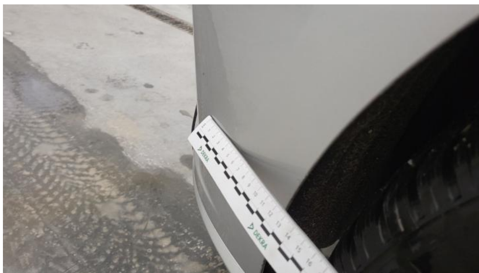
Photo 56. Zderzak tylny - Wgniecenie/odkształcenie 1
