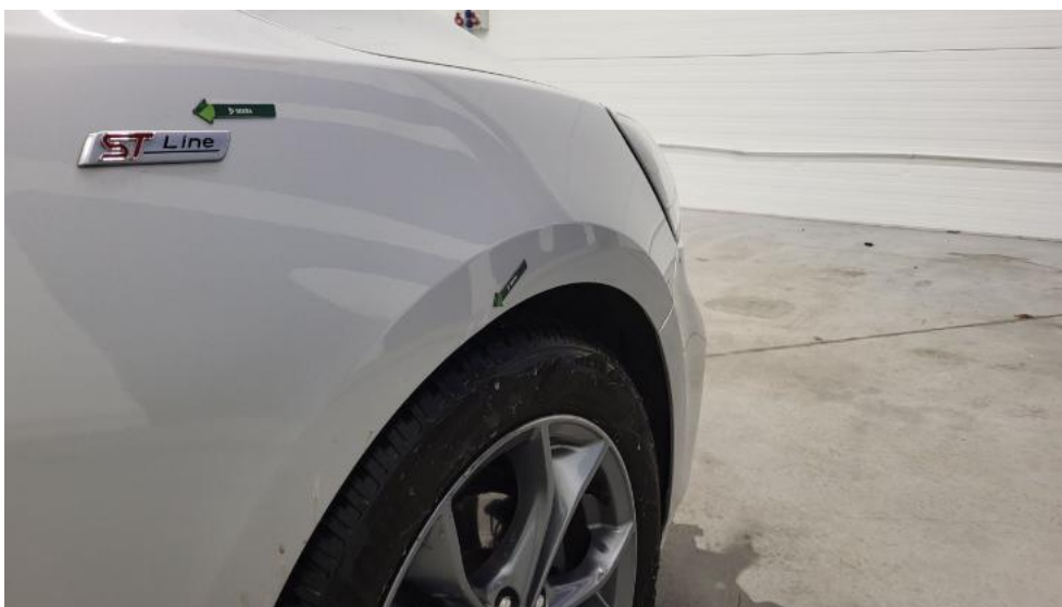
Photo 47. Błotnik przedni P - Wgniecenie/odkształcenie 1
