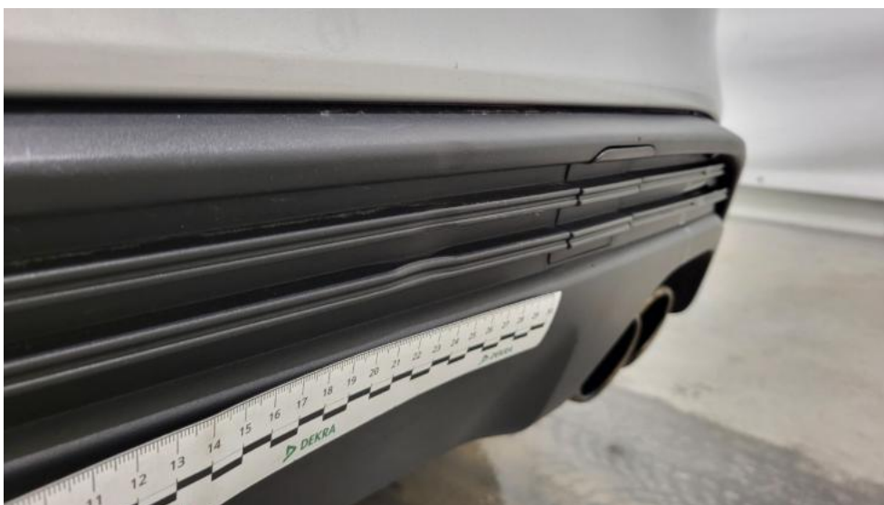
Photo 60. Zderzak tylny cz dolna - Wgniecenie/odkształcenie 1
