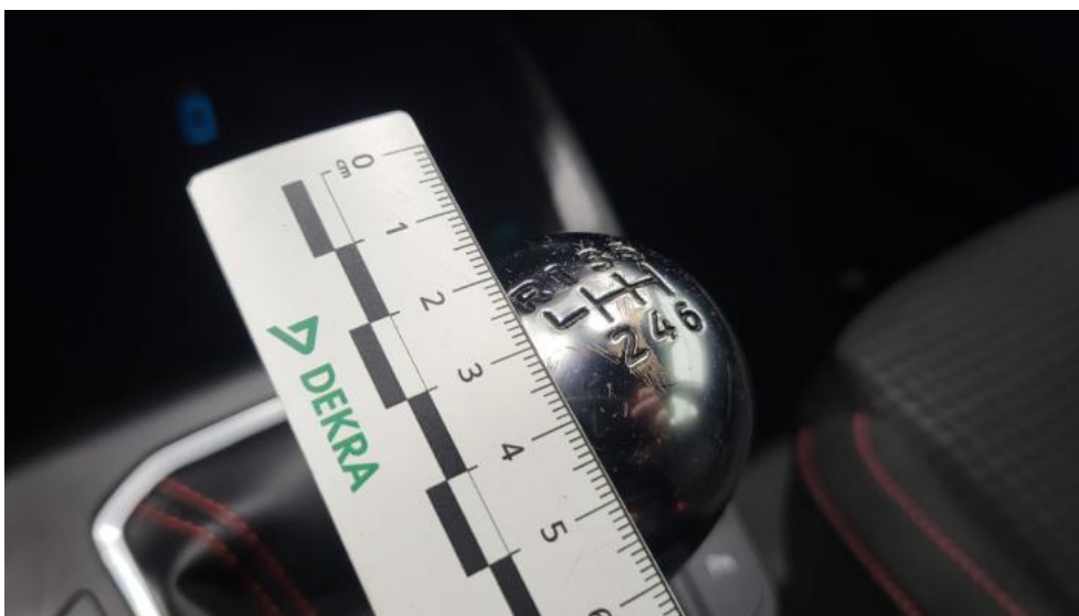
Photo 68. Gałka dźwigni zmiany biegów - Rysa/odprysk 1
