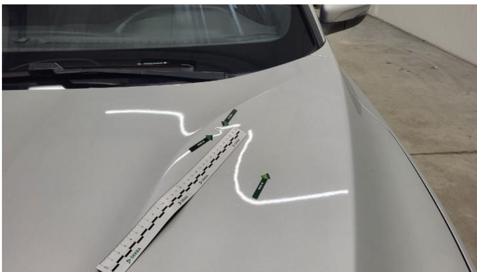
Photo 42. Pokrywa komory silnika - Wgniecenie/odkształcenie 1
