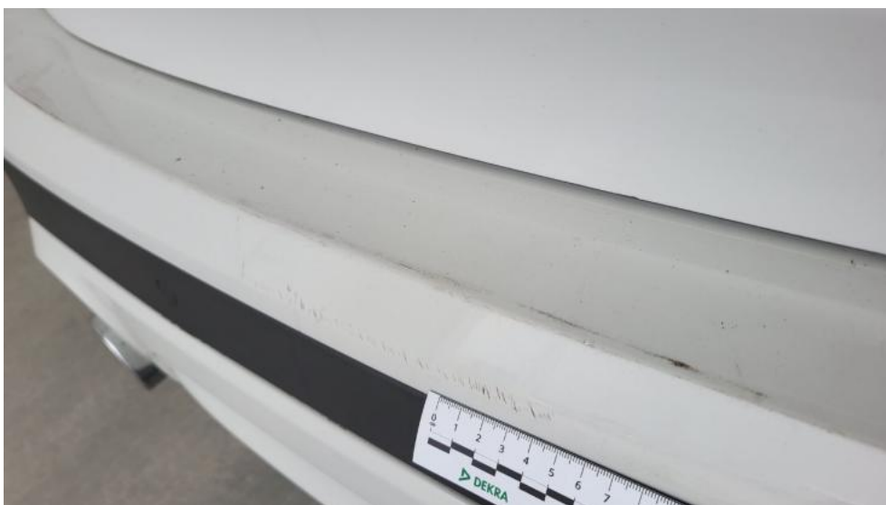
Photo 54. Zderzak tylny - Rysa/odprysk 1
