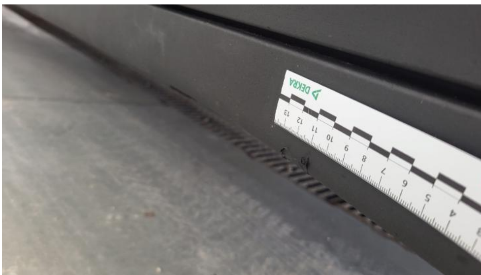
Photo 66. Próg L - Rysa/odprysk 2
