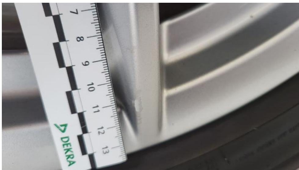
Photo 47. Felga aluminiowa tylna P - Rysa/odprysk 1
