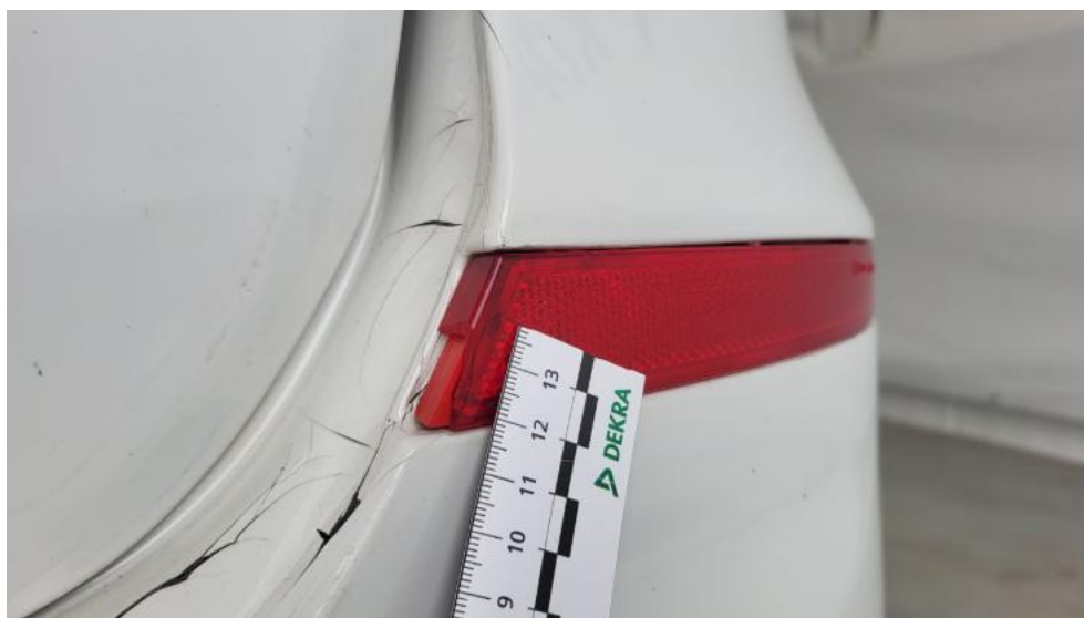
Photo 48. Lampa przeciwmgielna tylna P - Pęknięcie/rozerwanie 1
