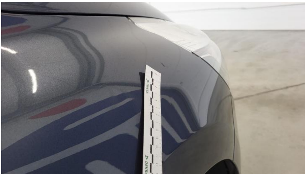
Photo 37. Błotnik przedni P - Wgniecenie/odkształcenie 1
