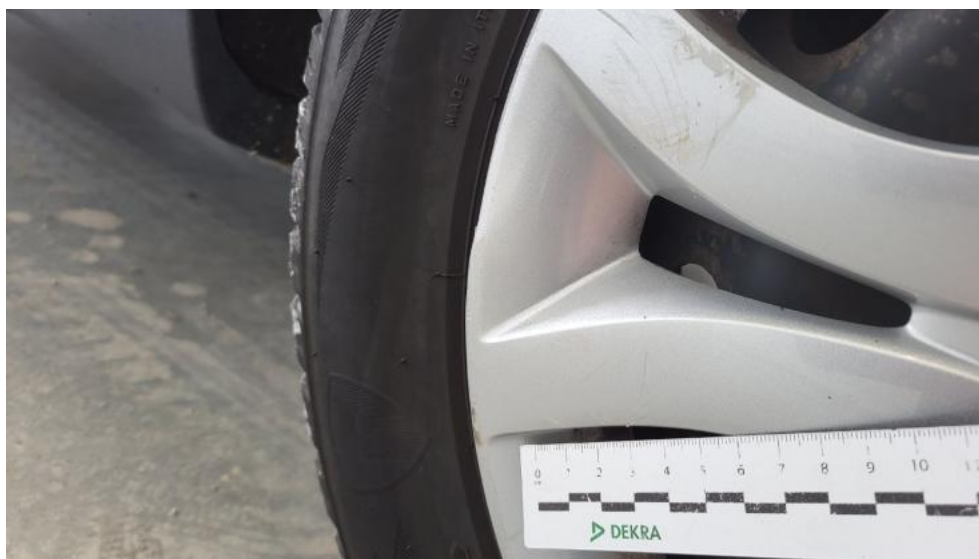
Photo 39. Kołpak przedni P - Rysa/odprysk 1
