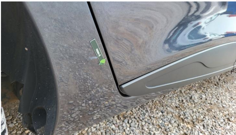
Photo 47. Błotnik tylny P / Ściana boczna P - Wgniecenie/odkształcenie 2
