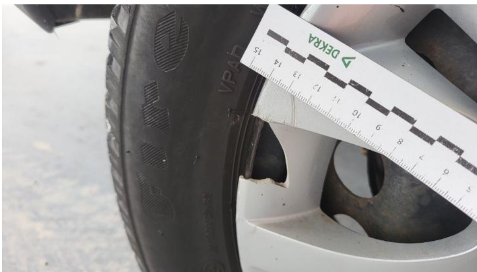
Photo 48. Kołpak tylny P - Pęknięcie/rozerwanie 1
