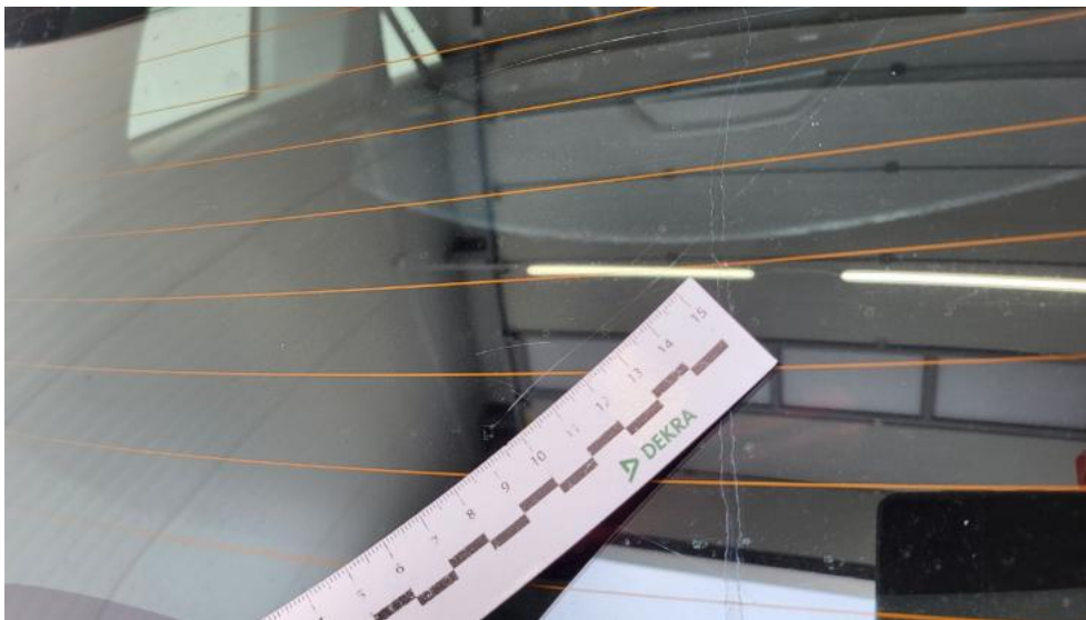
Photo 49. Szyba tylna - Rysa/odprysk 1
