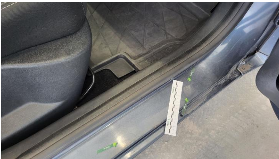
Photo 45. Próg P - Wgniecenie/odkształcenie 1
