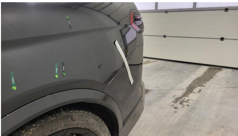
Fot. 57. Błotnik tylny L / Ściana boczna L - Wgniecenie/odkształcenie 1
