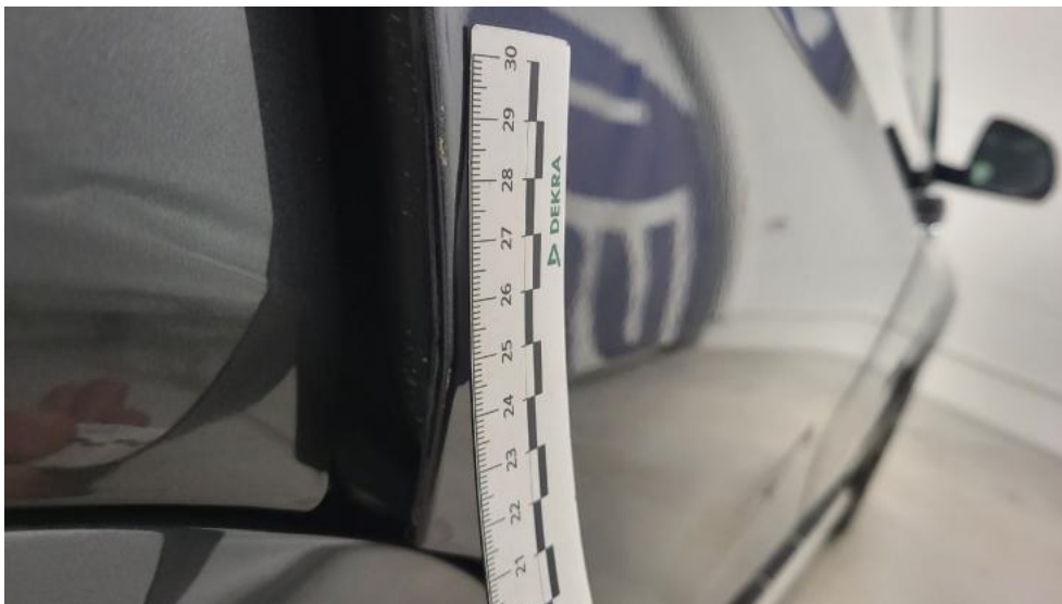
Fot. 53. Drzwi tylne P - Rysa/odprysk 1
