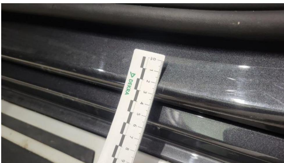
Fot. 62. Próg L - Rysa/odprysk 1
