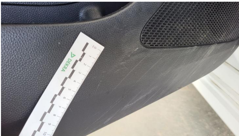
Photo 68. Tapicerka drzwi przednich L - Rysa/odprysk 1
