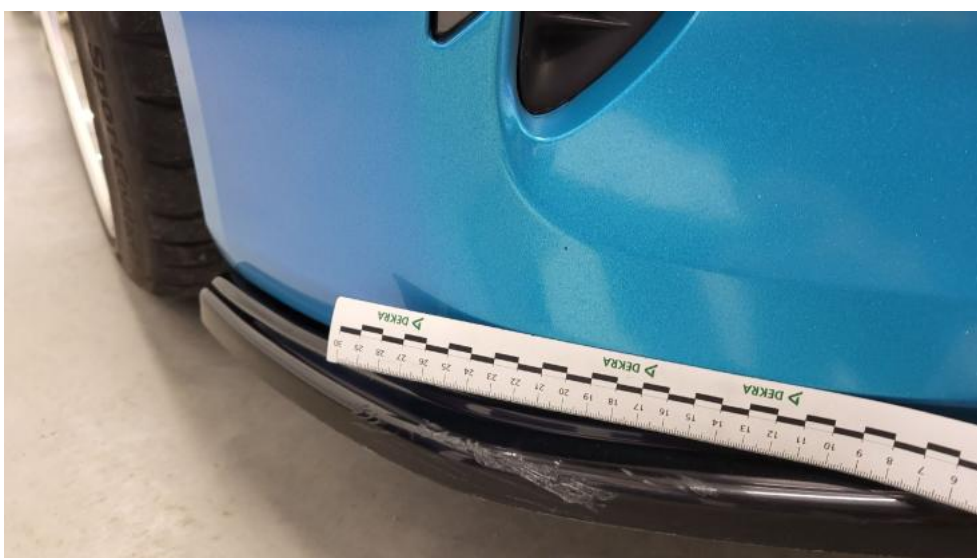
Fot. 44. Spoiler zderzaka przedniego - Rysa/odprysk 1
