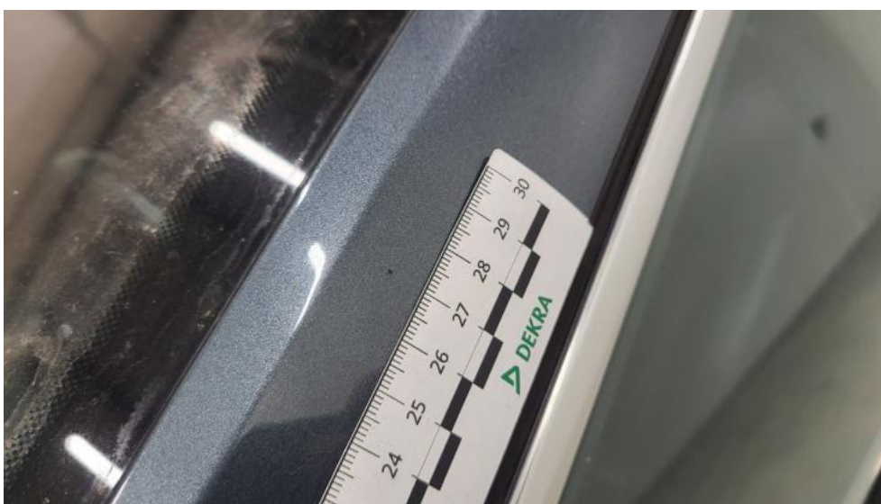
Fot. 66. Słupek przedni L - Rysa/odprysk 1
