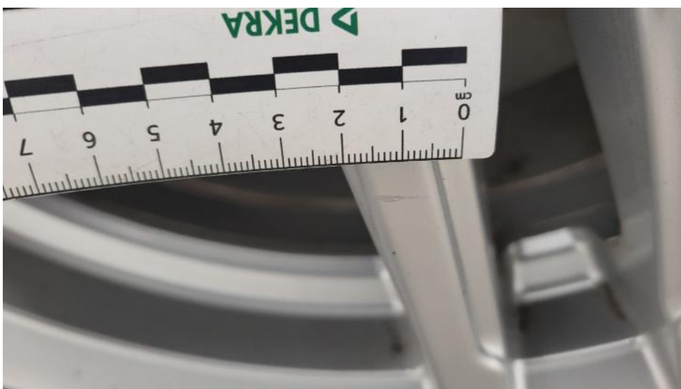
Fot. 54. Felga aluminiowa tylna P - Rysa/odprysk 1
