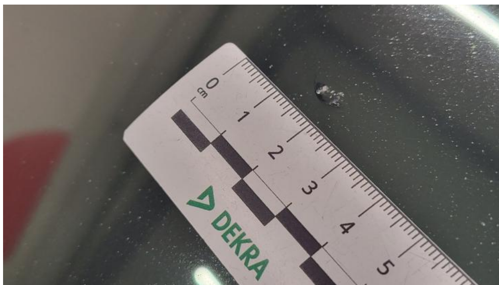
Fot. 45. Szyba czołowa - Pęknięcie/rozerwanie 1
