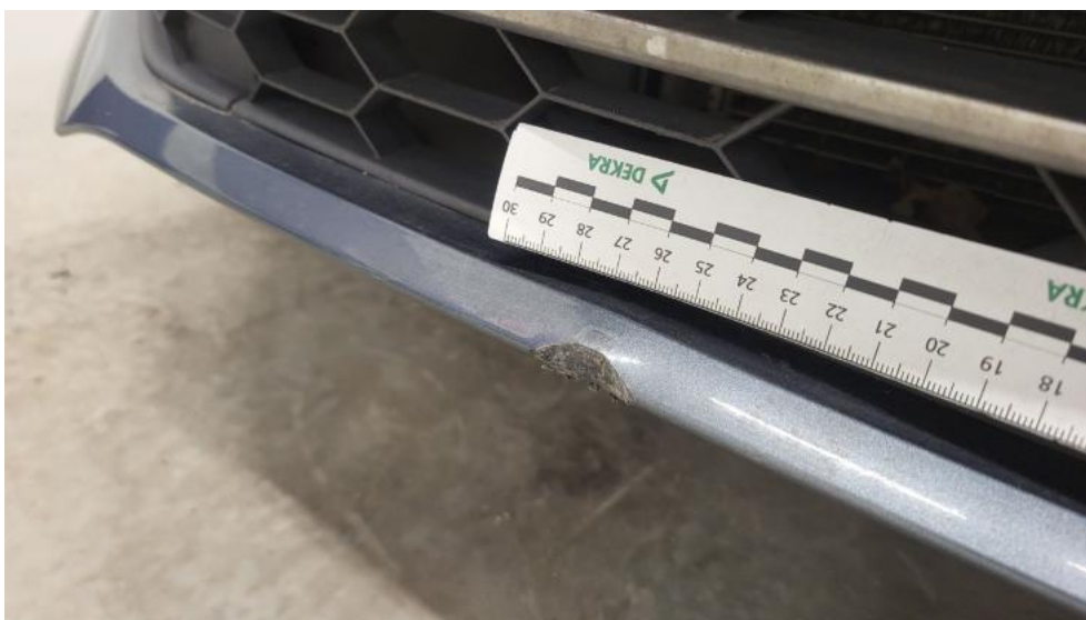
Fot. 48. Zderzak - Wgniecenie/odkształcenie 1
