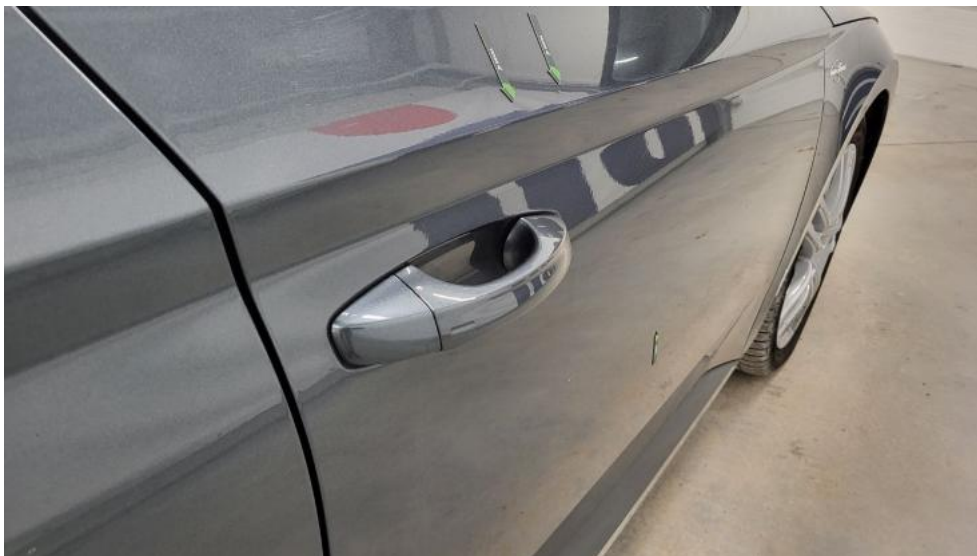
Fot. 51. Drzwi przednie P - Wgniecenie/odkształcenie 1
