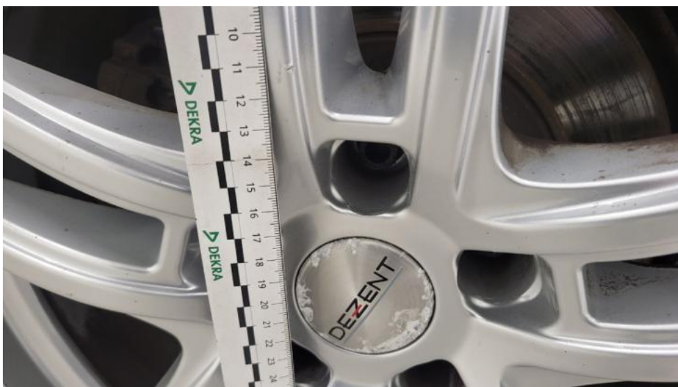
Fot. 60. Felga aluminiowa tylna L - Rysa/odprysk 1
