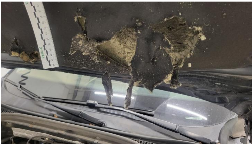
Fot. 47. Wykładzina pokrywy komory silnika - Pęknięcie/rozerwanie 1
