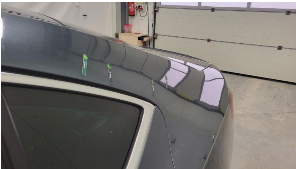
Fot. 59. Błotnik tylny L / Ściana boczna L - Wgniecenie/odkształcenie 1
