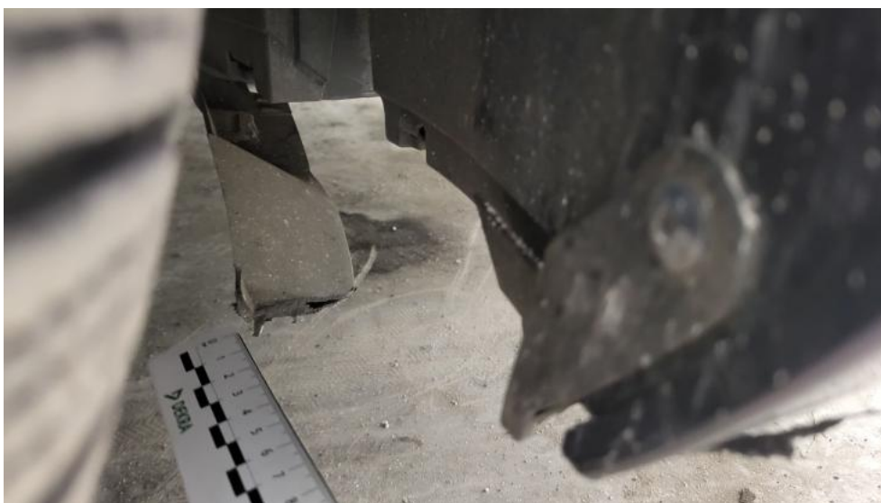
Fot. 50. Nadkole przednie P - Pęknięcie/rozerwanie 1
