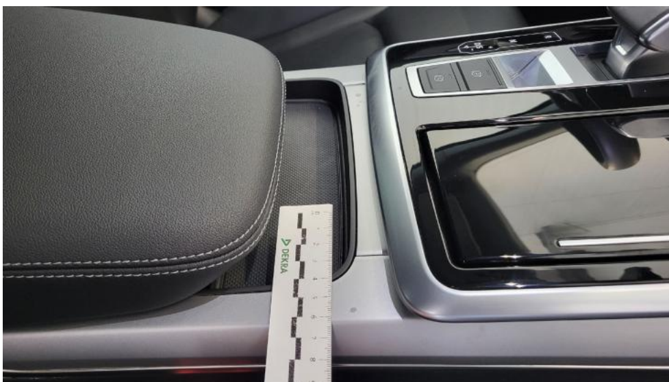
Photo 48. Konsola tunelu śr. - Rysa/odprysk 1
