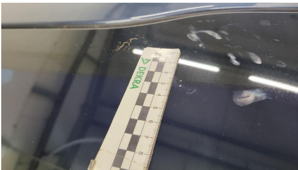
Photo 45. Szyba czółowa - Rysa/odprysk 1
