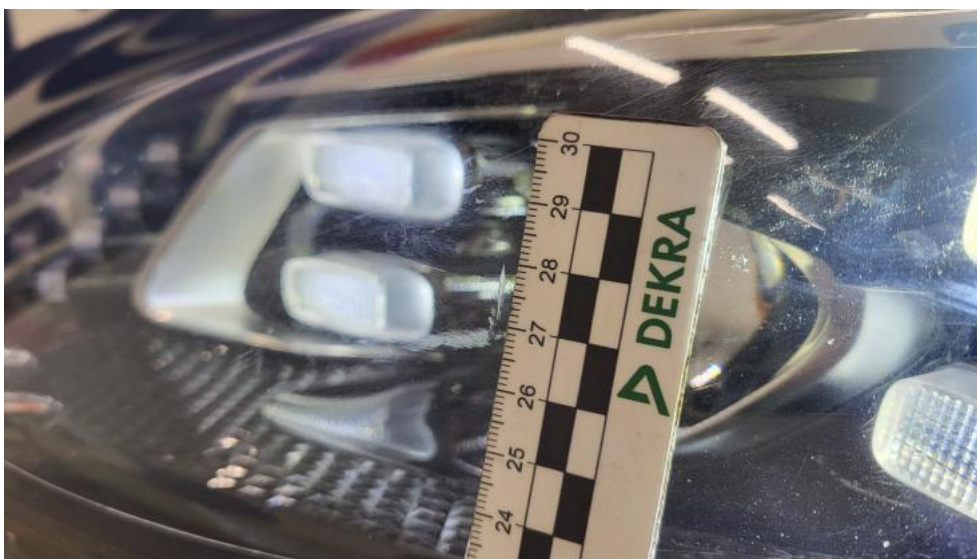
Photo 71. Reflektor L - Rysa/odprysk 1
