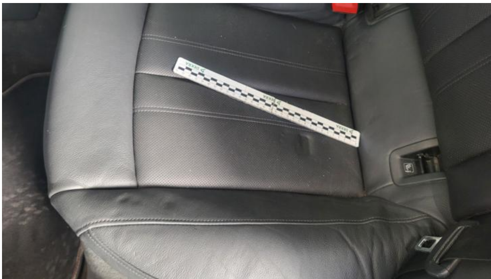
Photo 117. Kanapa tyl. - Wgniecenie/odkształcenie 1
