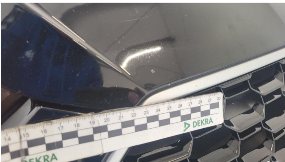
Photo 52. Pokrywa komory silnika - Rysa/odprysk 1
