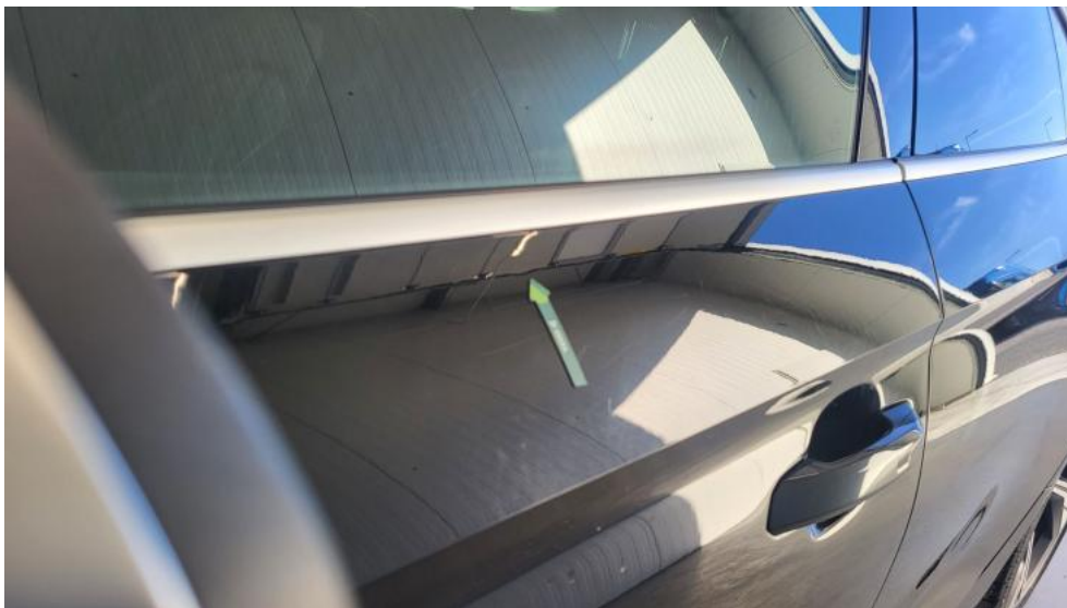
Photo 107. Drzwi przed L - Wgniecenie/odkształcenie 1
