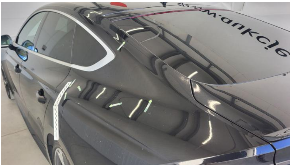
Photo 101. Błotnik tylny L / Ściana boczna L - Wgniecenie/odkształcenie 2
