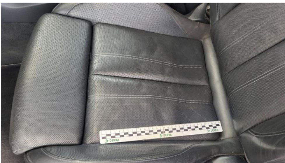
Photo 115. Fotel prz. lew. - Wgniecenie/odkształcenie 1
