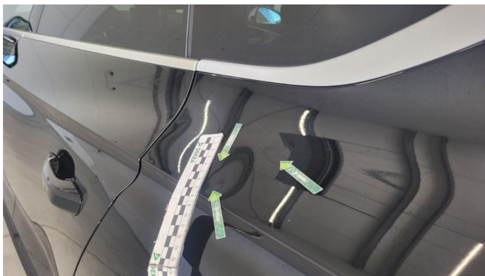
Photo 100. Błotnik tylny L / Ściana boczna L - Wgniecenie/odkształcenie 1
