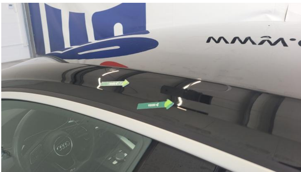
Photo 112. Słupek przedni L() - Wgniecenie/odkształcenie 3
