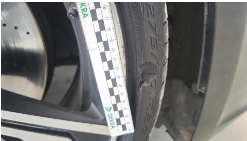
Photo 68. Opona przednia P - Wgniecenie/odkształcenie 1
