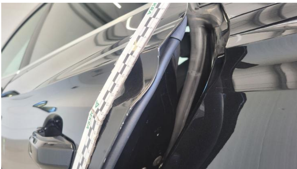
Photo 108. Drzwi tylne L - Rysa/odprysk 1
