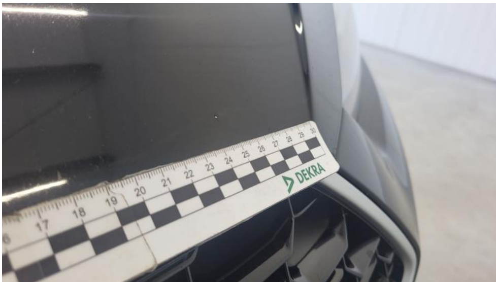
Photo 53. Pokrywa komory silnika - Rysa/odprysk 2
