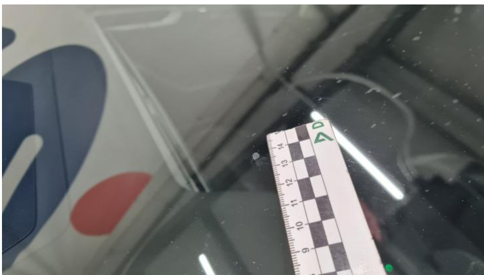
Photo 96. Szyba czołowa - Pęknięcie/rozerwanie 2
