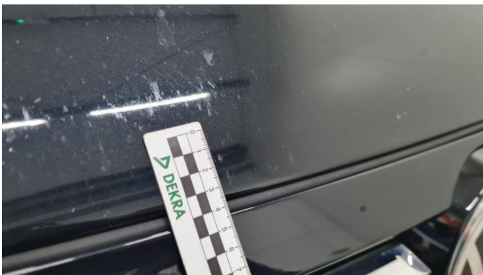
Photo 92. Pokrywa komory silnika - Rysa/odprysk 1
