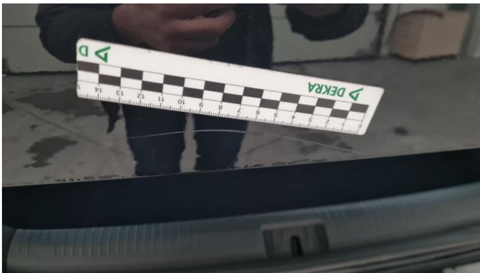
Photo 45. Pokrywy bagażnika - Rysa/odprysk 1
