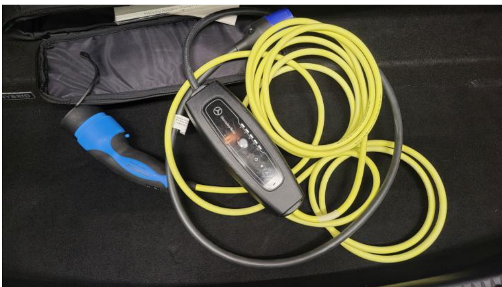
Fot. 35. Przewód ładowania baterii trakcyjnej
