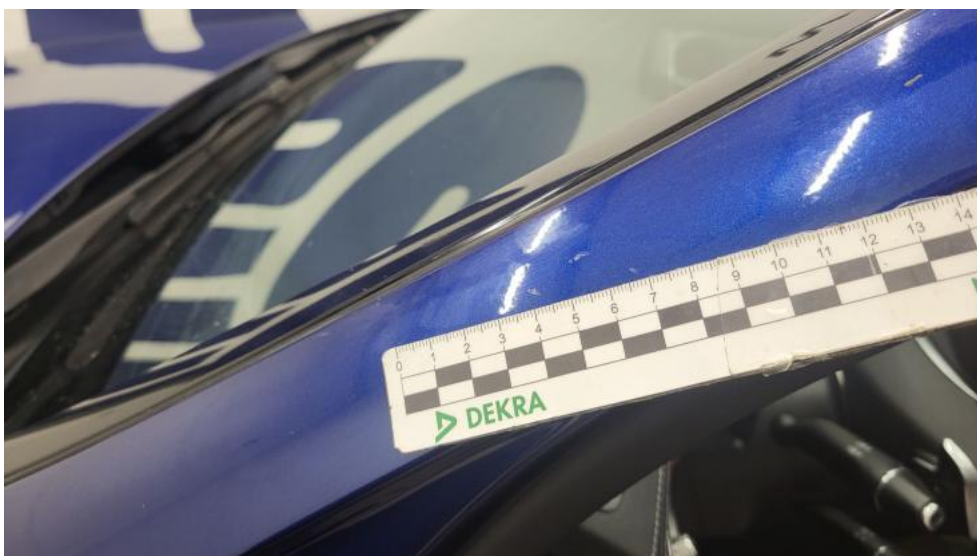
Fot. 70. Słupek przedni L - Rysa/odprysk 1
