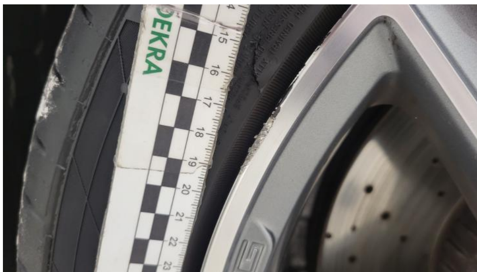
Fot. 71. Felga Aluminiowa przednia L - Rysa/odprysk 1
