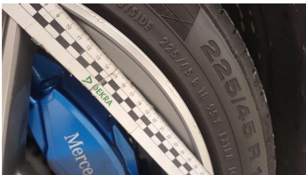
Fot. 72. Felga Aluminiowa przednia L - Rysa/odprysk 2
