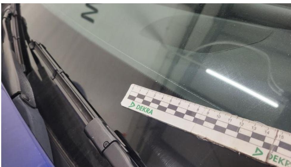
Fot. 60. Szyba czołowa - Rysa/odprysk 2
