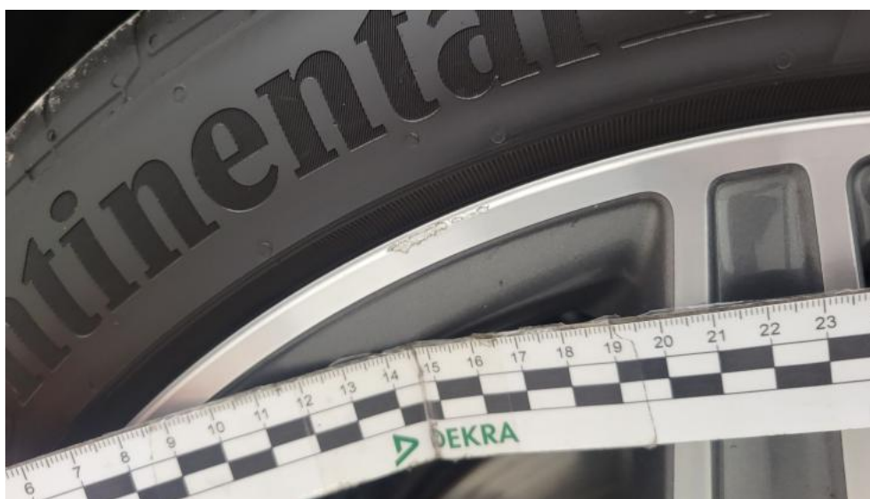
Fot. 67. Felga aluminiowa tylna L - Rysa/odprysk 1
