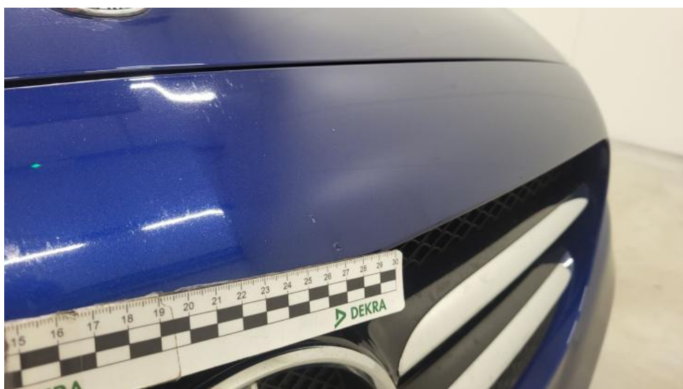
Fot. 52. Zderzak - Rysa/odprysk 6
