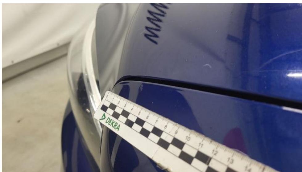
Fot. 54. Zderzak - Rysa/odprysk 4
