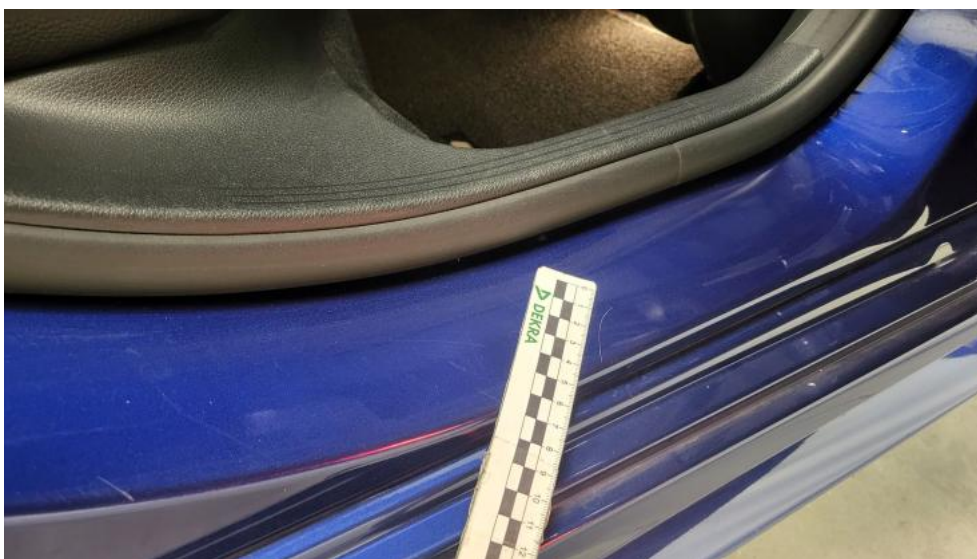
Fot. 63. Próg P - Rysa/odprysk 1
