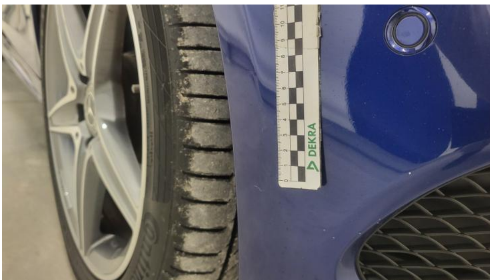
Fot. 62. Zderzak - Rysa/odprysk 1
