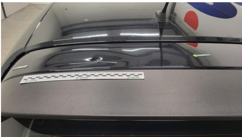
Fot. 64. Pokrywy bagażnika - Wgniecenie/odkształcenie 1
