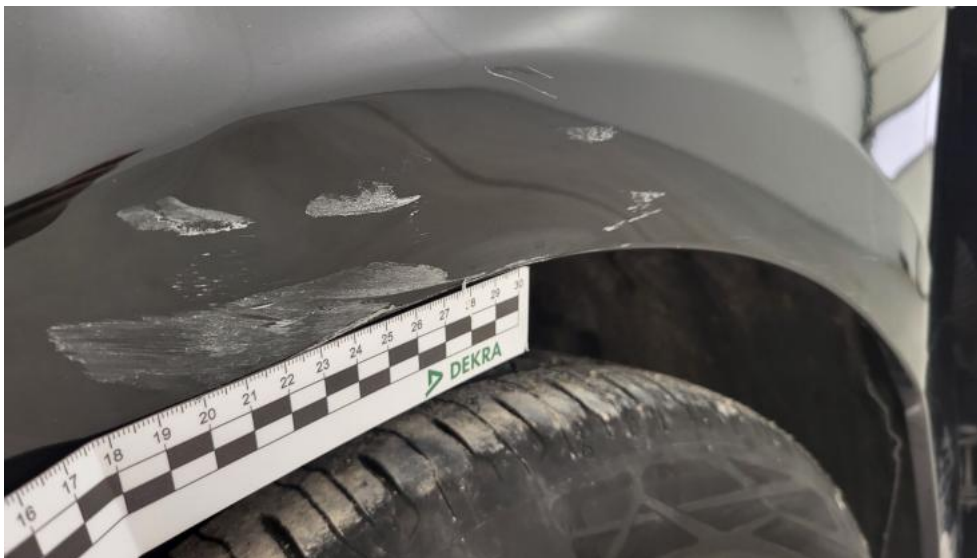
Fot. 83. Błotnik przedni L - Rysa/odprysk 1
