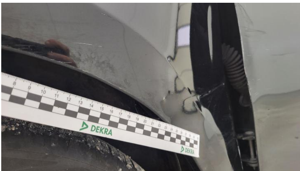
Fot. 84. Błotnik przedni L - Rysa/odprysk 2
