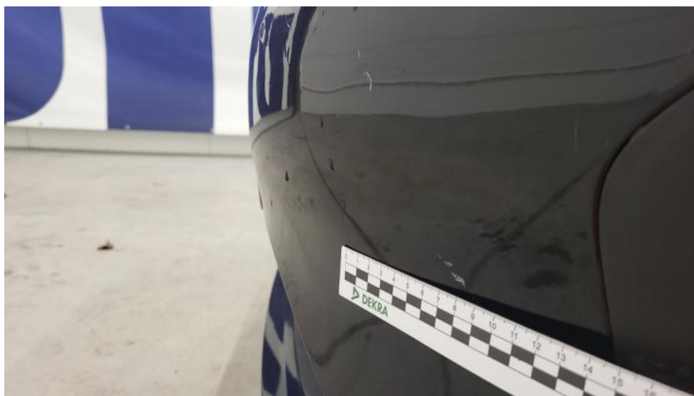
Fot. 46. Zderzak - Rysa/odprysk 2
