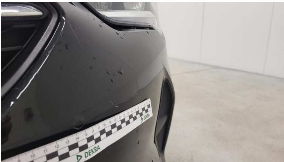
Fot. 49. Zderzak - Wgniecenie/odkształcenie 2
