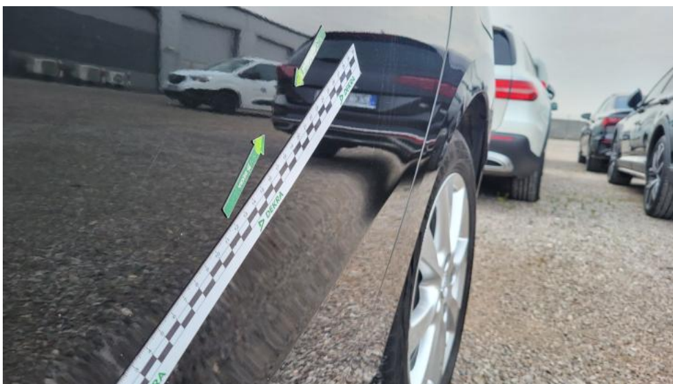
Fot. 82. Drzwi tylne L - Wgniecenie/odkształcenie 2
