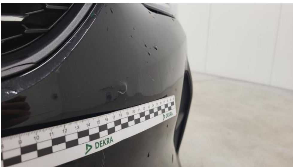
Fot. 48. Zderzak - Wgniecenie/odkształcenie 1
