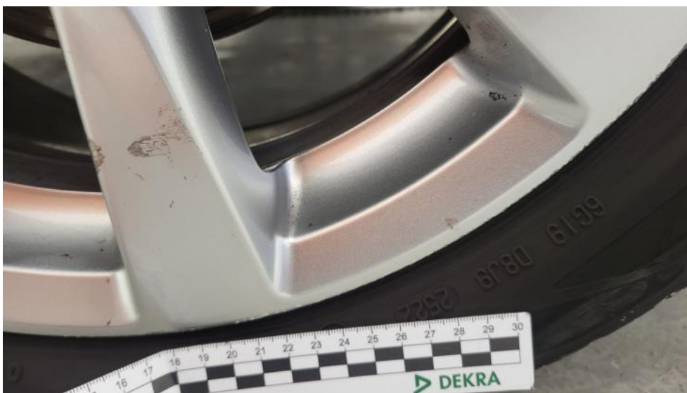
Fot. 55. Felga aluminiowa przednia P - Rysa/odprysk 2
