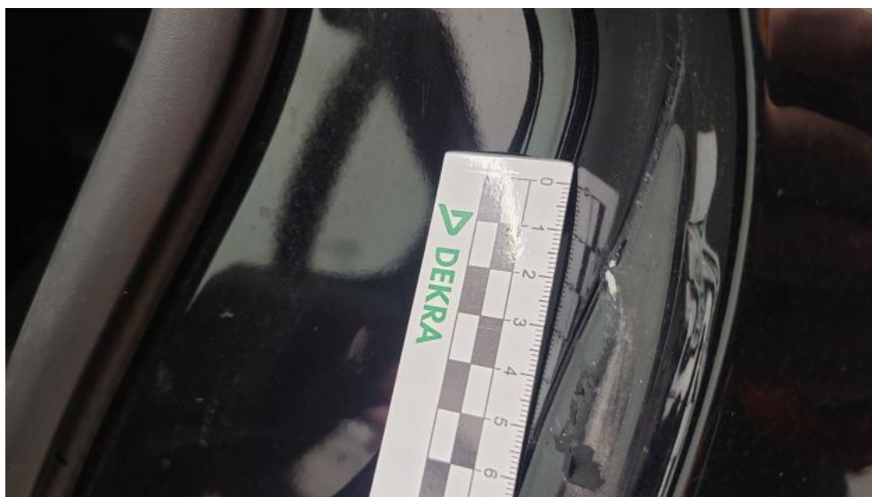
Fot. 72. Błotnik tylny L / Ściana boczna L - Rysa/odprysk 1
