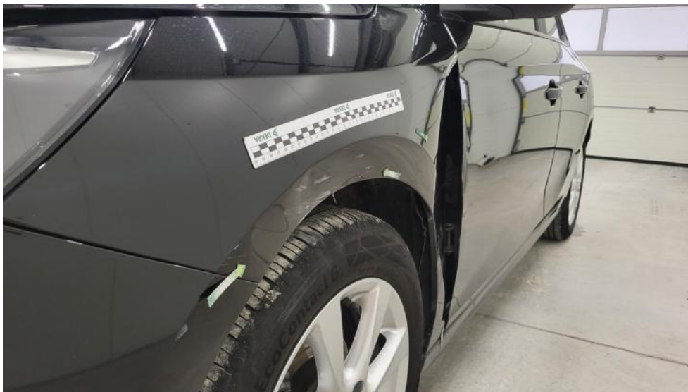
Fot. 87. Błotnik przedni L - Wgniecenie/odkształcenie 2
