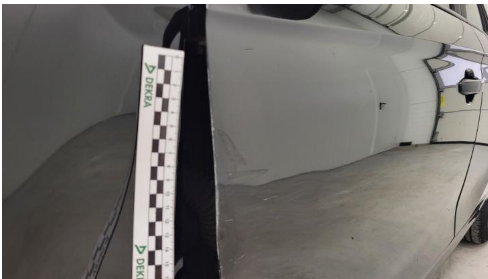
Fot. 76. Drzwi przed L - Rysa/odprysk 1
