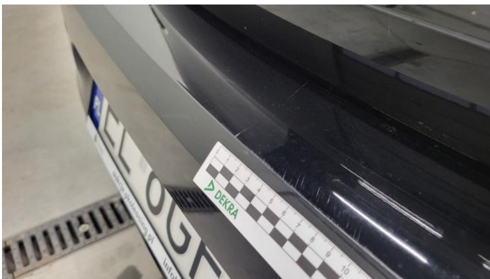
Fot. 66. Zderzak tylny - Rysa/odprysk 2
