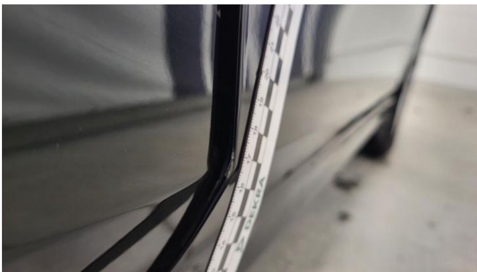
Fot. 56. Drzwi przednie P - Rysa/odprysk 1
