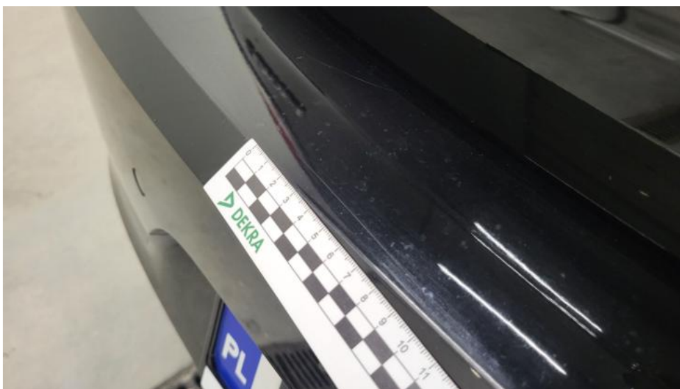
Fot. 67. Zderzak tylny() - Rysa/odprysk 3
