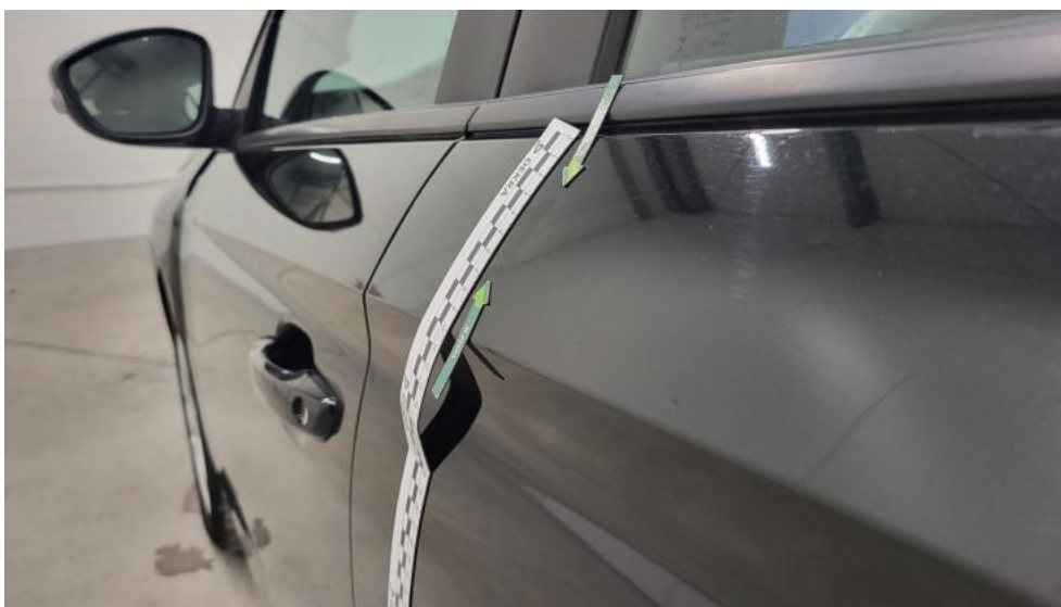
Fot. 81. Drzwi tylne L - Wgniecenie/odkształcenie 1
