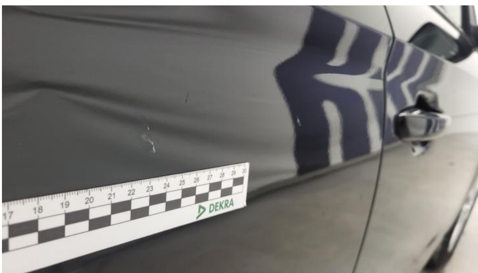
Fot. 58. Drzwi tylne P - Rysa/odprysk 1
