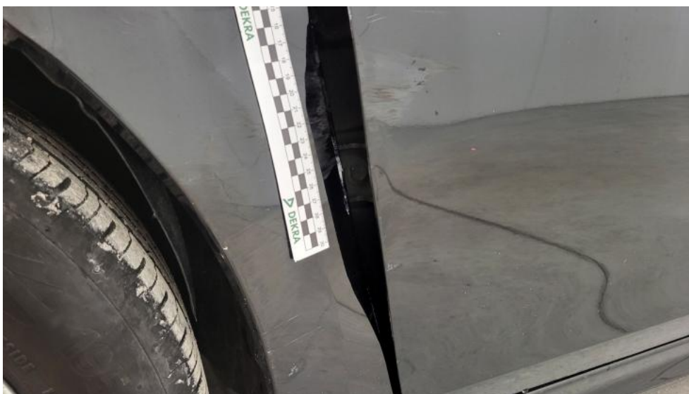
Fot. 85. Błotnik przedni L() - Rysa/odprysk 3
