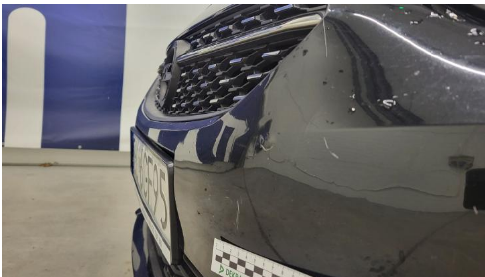
Fot. 47. Zderzak() - Rysa/odprysk 3
