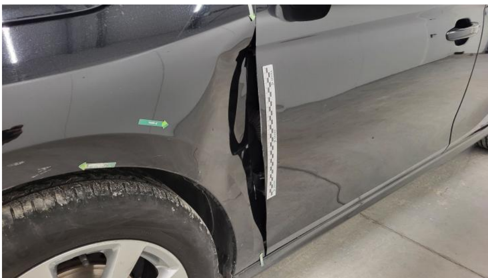
Fot. 86. Błotnik przedni L - Wgniecenie/odkształcenie 1
