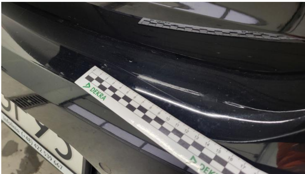
Fot. 65. Zderzak tylny - Rysa/odprysk 1
