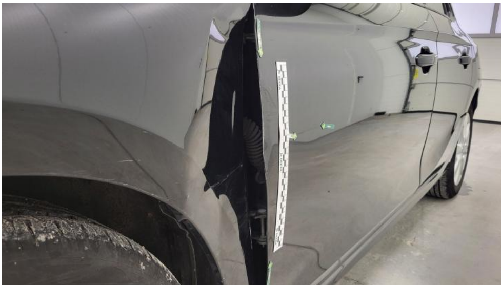
Fot. 79. Drzwi przed L - Wgniecenie/odkształcenie 1
