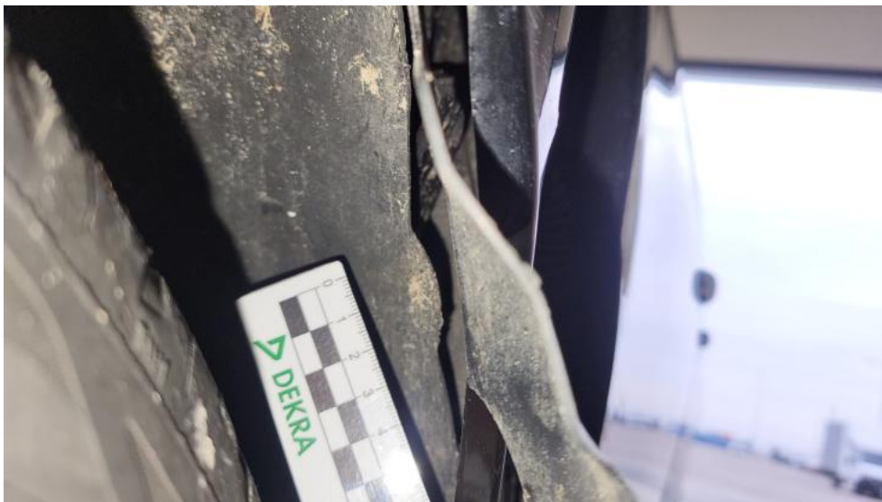
Fot. 89. Nadkole przednie L - Pęknięcie/rozerwanie 1
