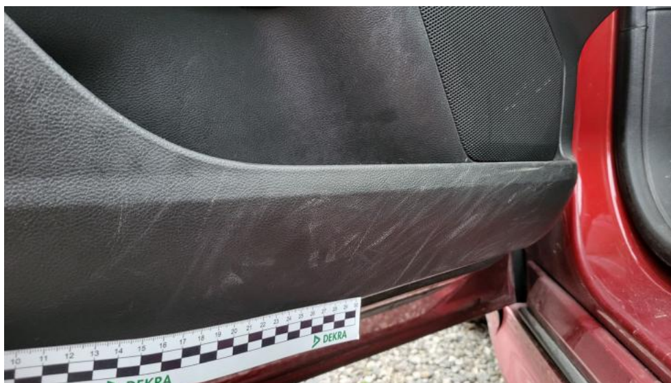
Photo 119. Tapicerka drzwi przednich L - Rysa/odprysk 1
