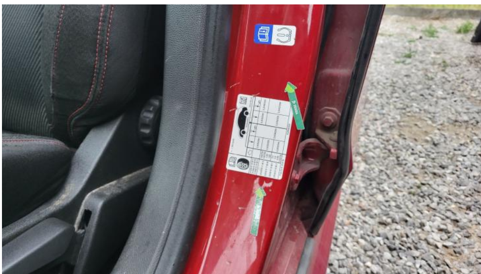
Photo 102. Słupek środkowy L - Wgniecenie/odkształcenie 1
