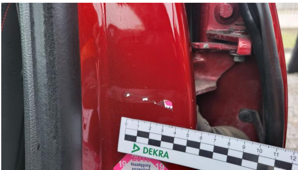
Photo 99. Słupek środkowy L - Rysa/odprysk 1
