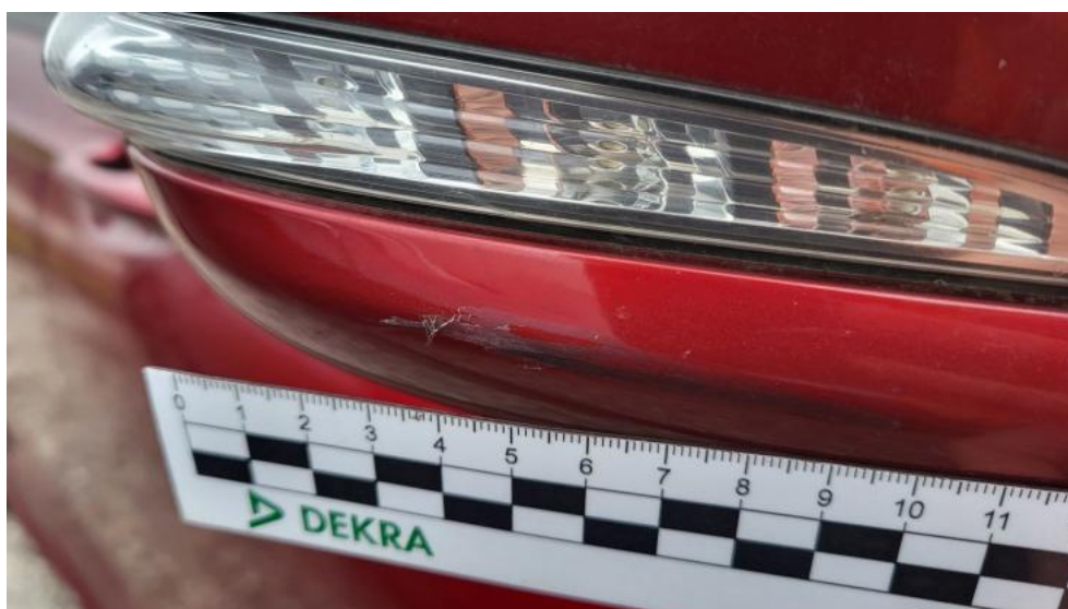
Photo 62. Lusterko zew P - Rysa/odprysk 1
