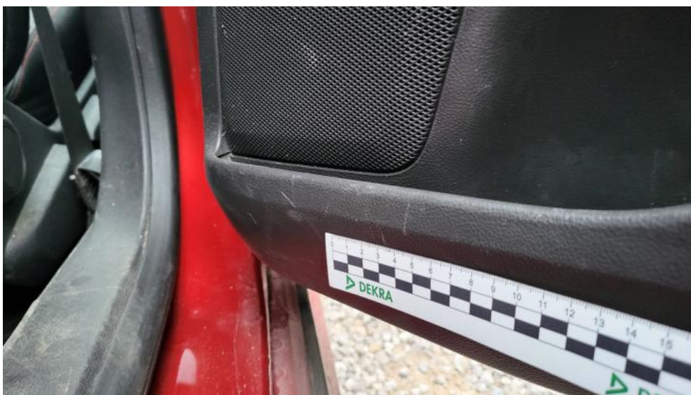
Photo 123. Tapicerka drzwi tylnych P - Rysa/odprysk 1
