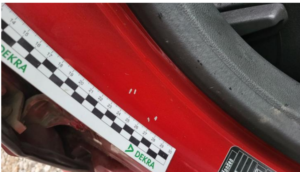
Photo 65. Słupek środkowy P - Rysa/odprysk 1
