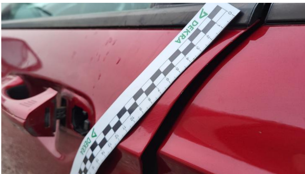
Photo 88. Drzwi przed L - Rysa/odprysk 1
