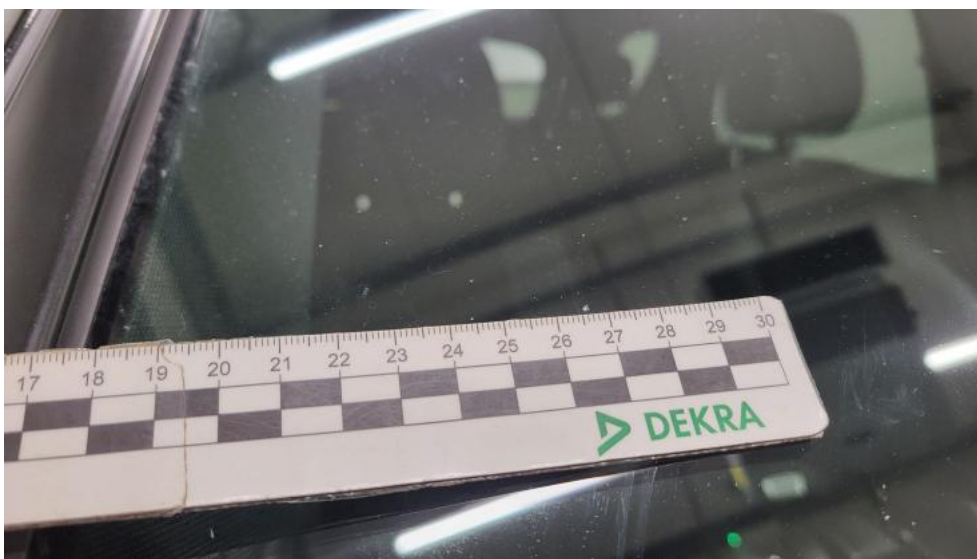
Fot. 53. Szyba czołowa - Rysa/odprysk 1
