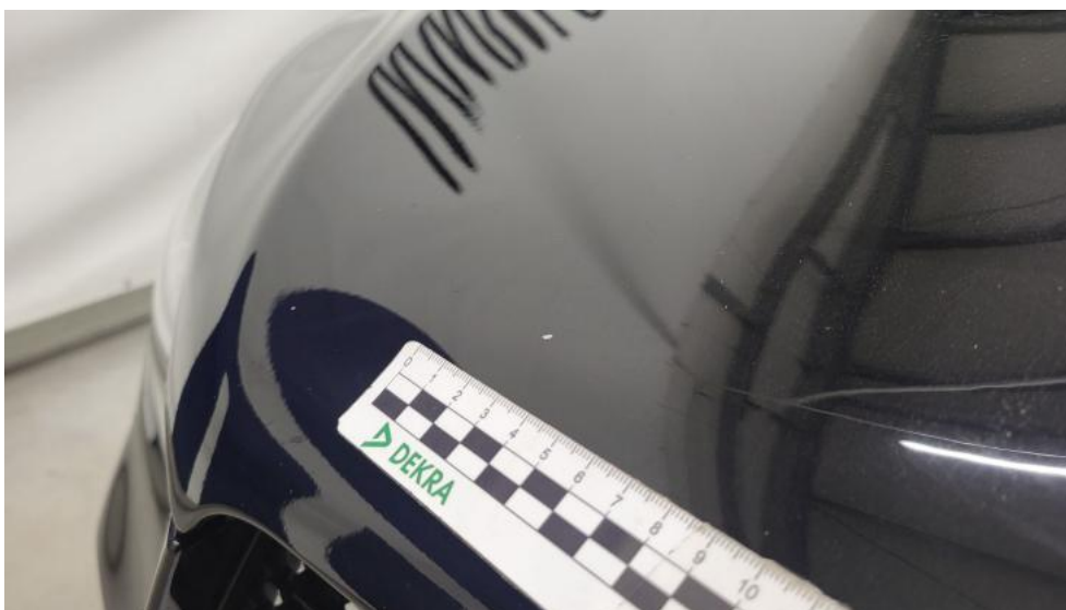
Fot. 49. Pokrywa komory silnika - Rysa/odprysk 1
