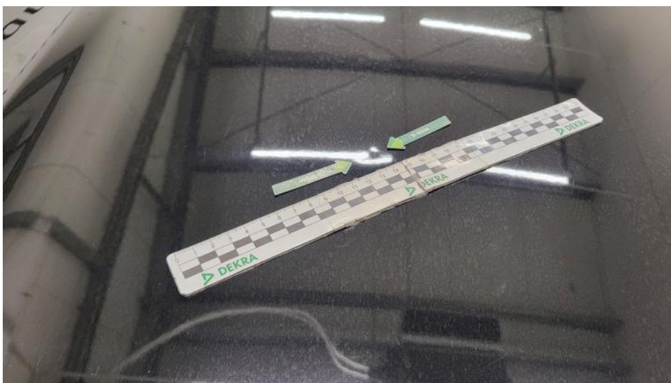
Fot. 50. Pokrywa komory silnika - Wgniecenie/odkształcenie 1
