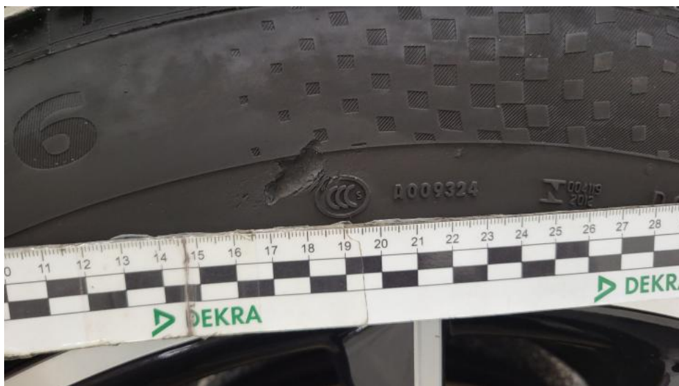
Fot. 73. Opona przednia L - Pęknięcie/rozerwanie 1
