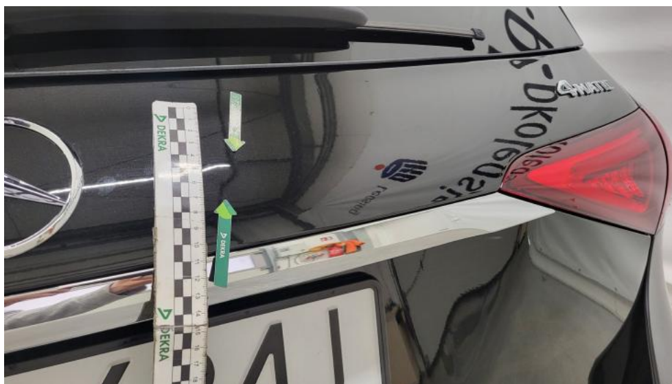
Fot. 61. Pokrywy bagażnika - Wgniecenie/odkształcenie 1
