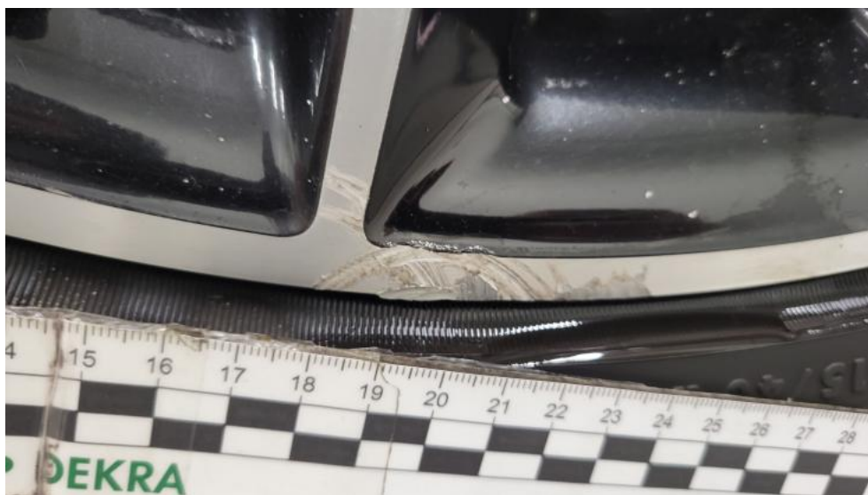
Fot. 65. Felga aluminiowa tylna L - Rysa/odprysk 2
