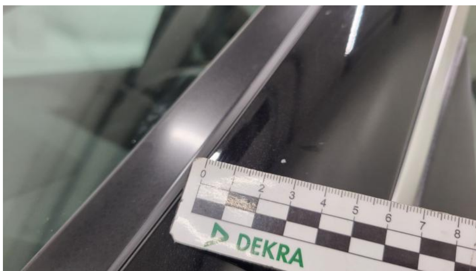
Fot. 70. Słupek przedni L - Rysa/odprysk 1
