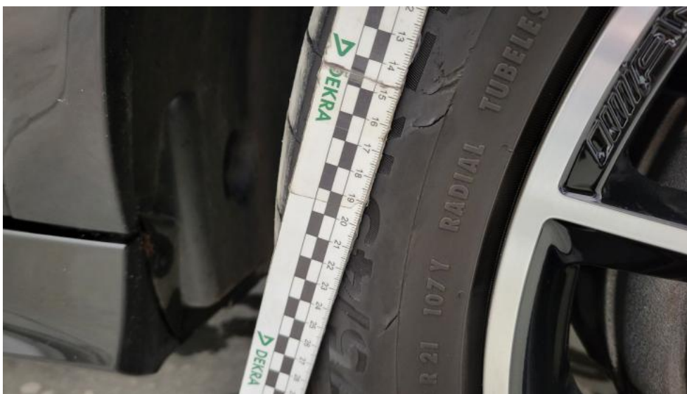
Fot. 56. Opona przednia P - Pęknięcie/rozerwanie 1
