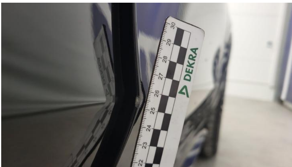
Fot. 57. Drzwi przednie P - Rysa/odprysk 1
