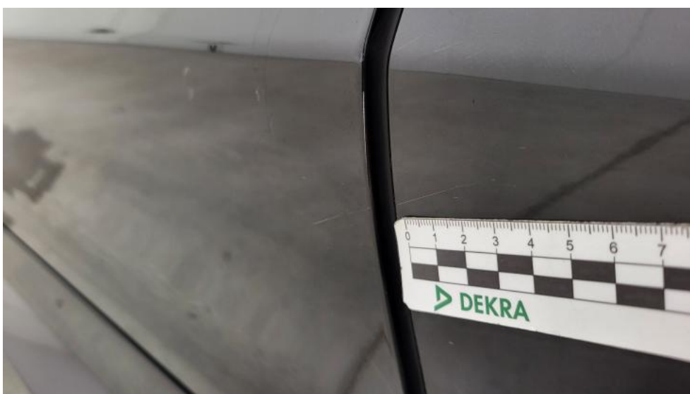
Fot. 68. Drzwi tylne L - Rysa/odprysk 2
