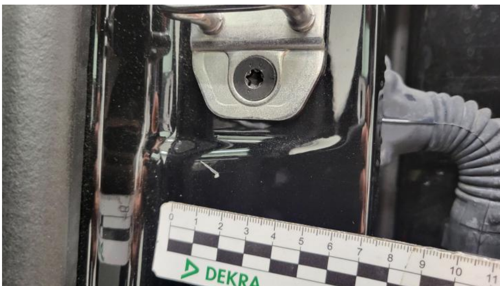
Fot. 71. Stupek środkowy L - Rysa/odprysk 1
