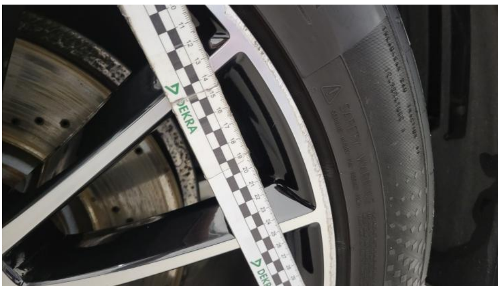
Fot. 55. Felga aluminiowa przednia P - Rysa/odprysk 2
