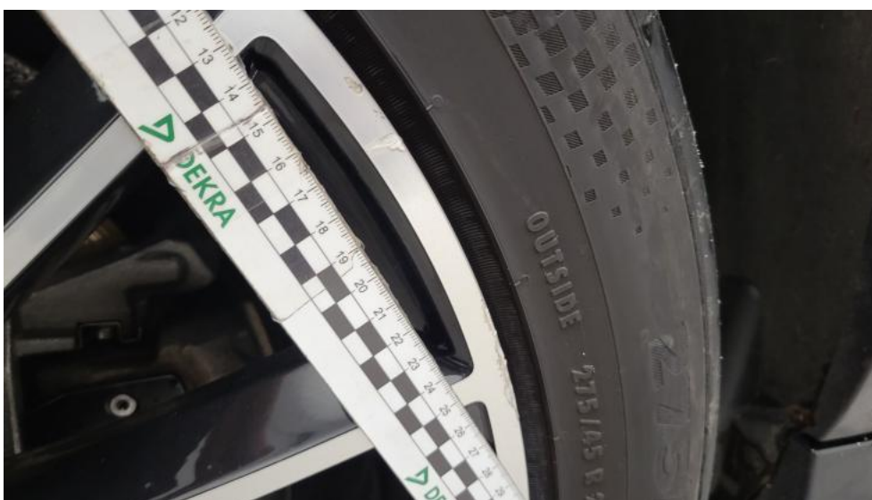
Fot. 72. Felga Aluminiowa przednia L - Rysa/odprysk 1
