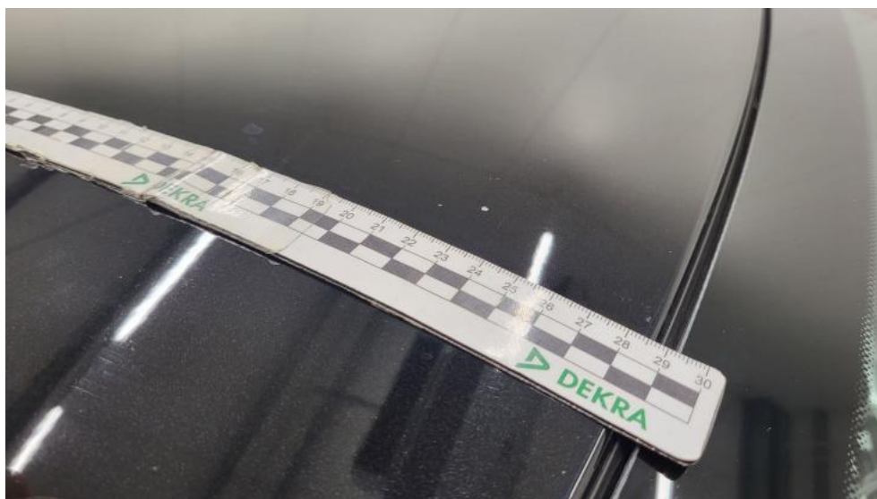
Fot. 62. Dach - Rysa/odprysk 1
