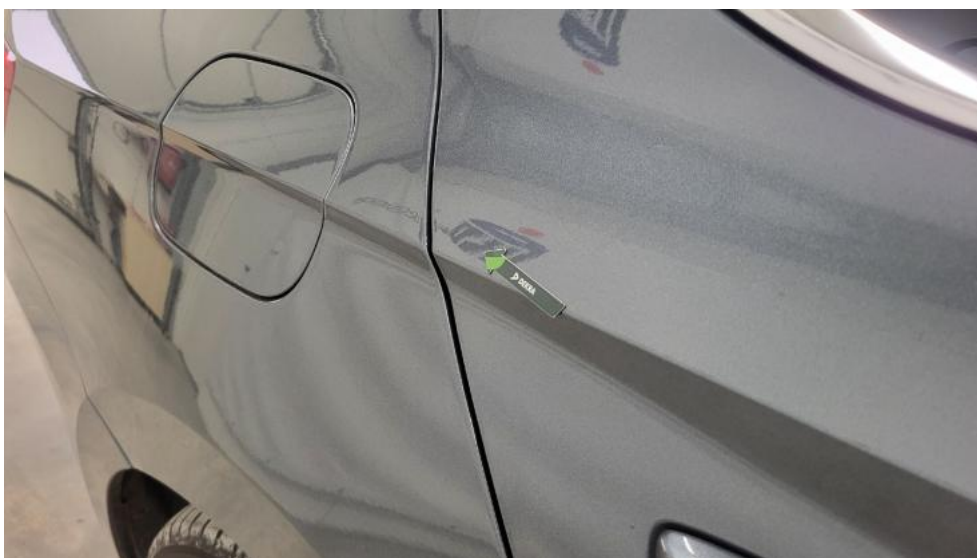
Photo 52. Drzwi tylne P - Wgniecenie/odkształcenie 1
