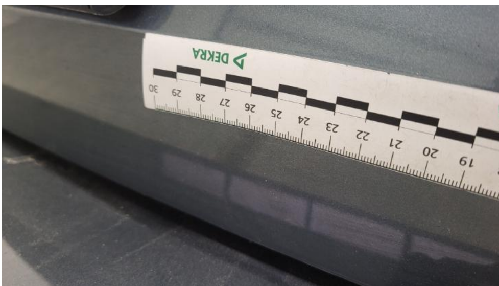
Photo 55. Pokrywy bagażnika - Rysa/odprysk 1
