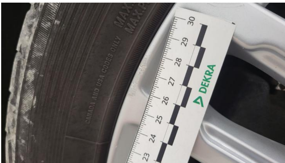
Photo 68. Felga Aluminiowa przednia L - Rysa/odprysk 1
