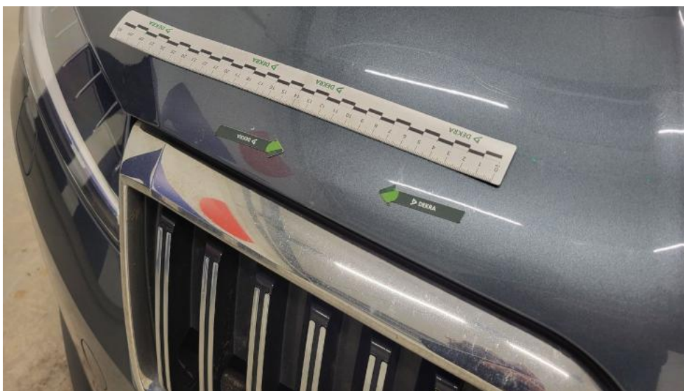
Photo 43. Pokrywa komory silnika - Wgniecenie/odkształcenie 1
