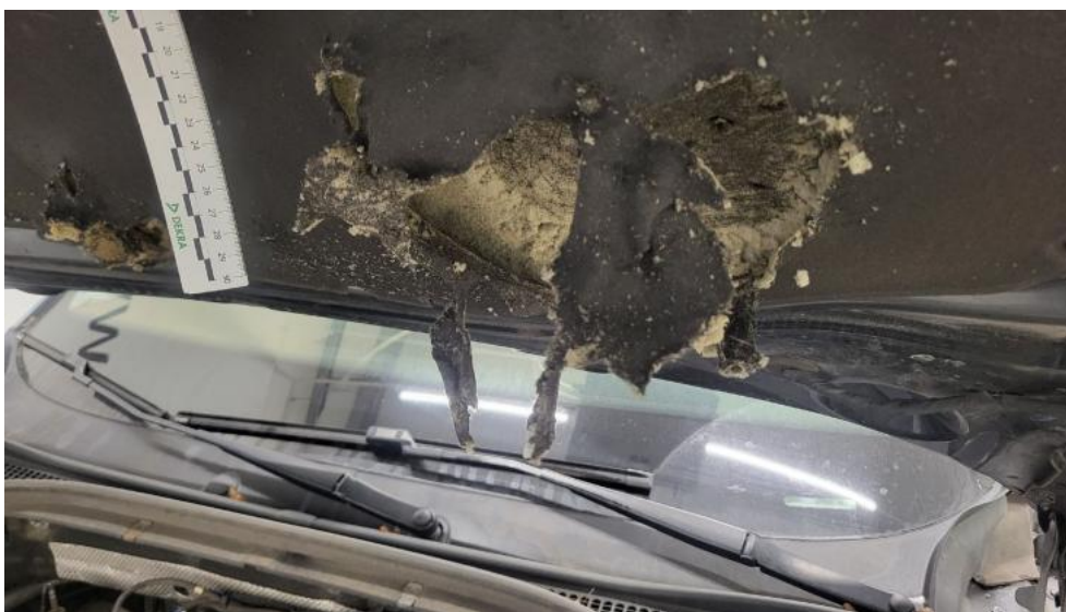
Photo 47. Wykładzina pokrywy komory silnika - Pęknięcie/rozerwanie 1
