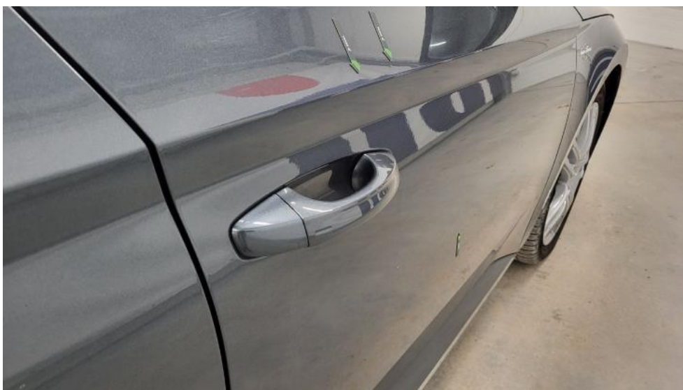
Photo 51. Drzwi przednie P - Wgniecenie/odkształcenie 1
