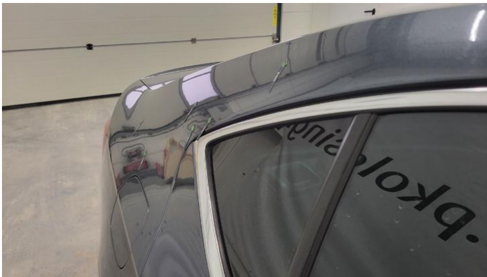
Photo 53. Błotnik tylny P / Ściana boczna P - Wgniecenie/odkształcenie 1
