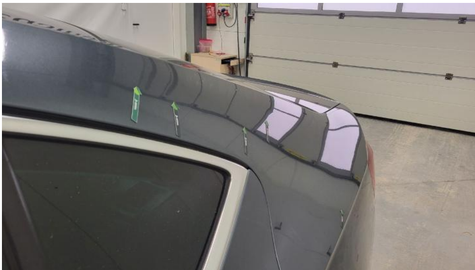
Photo 59. Błotnik tylny L / Ściana boczna L - Wgniecenie/odkształcenie 1
