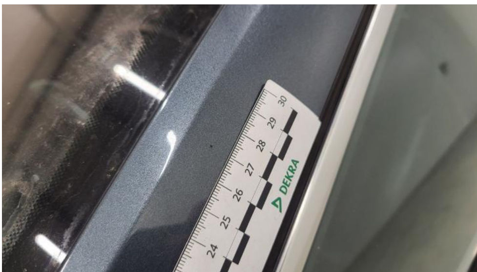
Photo 66. Słupek przedni L - Rysa/odprysk 1
