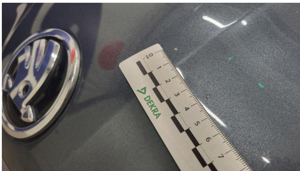
Photo 42. Pokrywa komory silnika - Rysa/odprysk 1
