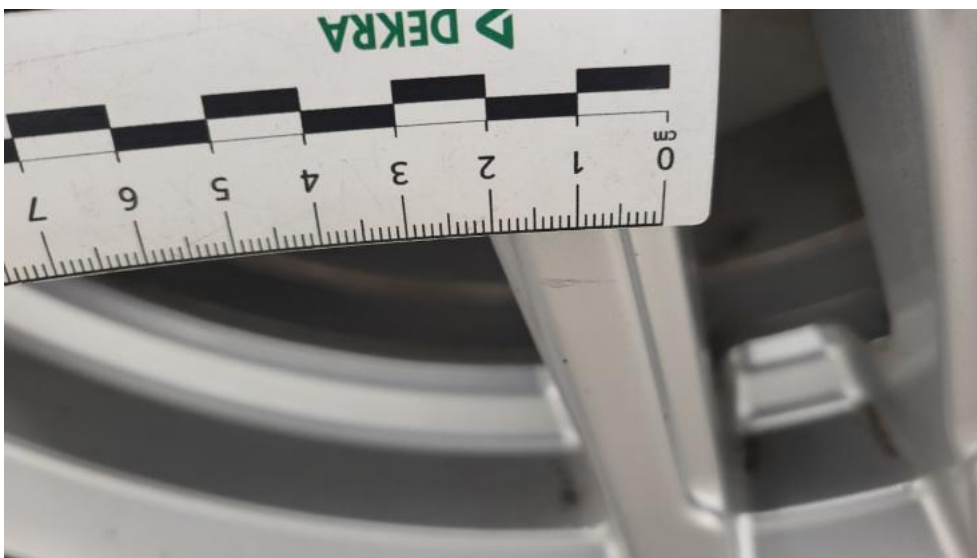
Photo 54. Felga aluminiowa tylna P - Rysa/odprysk 1
