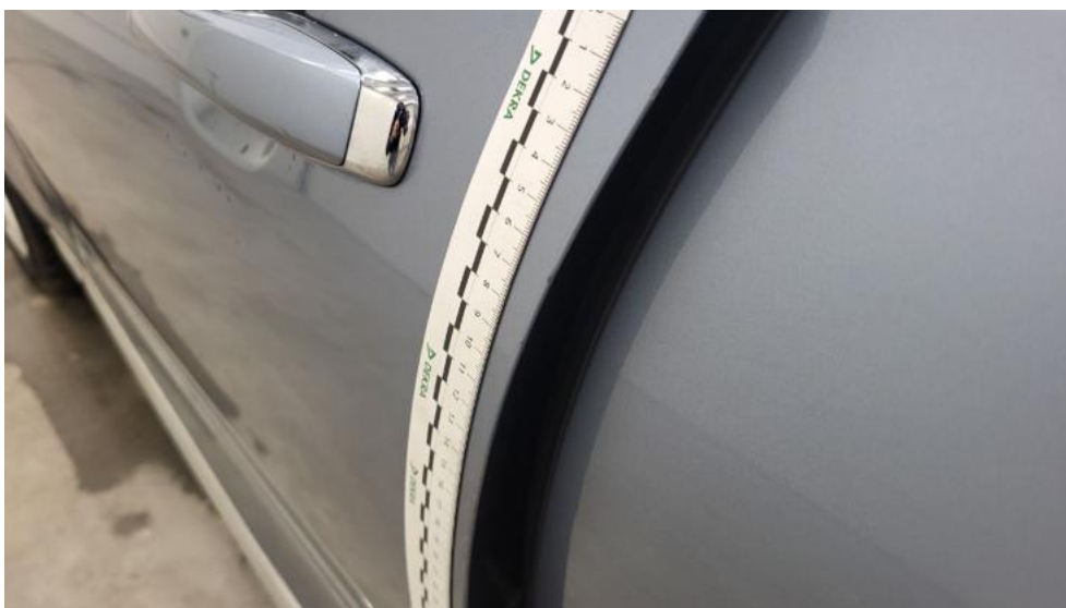
Photo 74. Drzwi przed L - Rysa/odprysk 1
