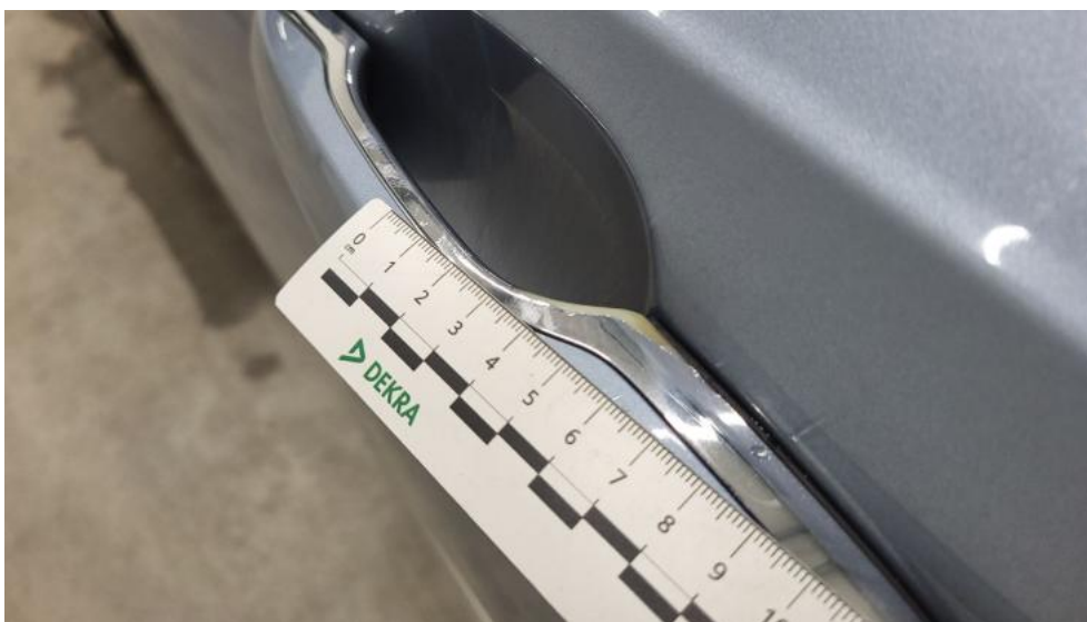
Photo 77. Klamka drzwi prz L - Rysa/odprysk 1
