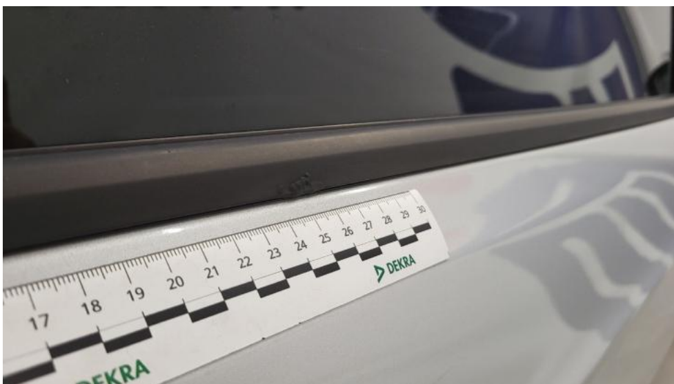
Fot. 54. Listwa drzwi tylnych P - Wgniecenie/odkształcenie 1
