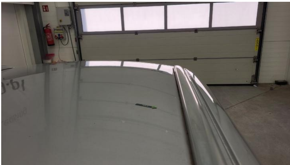
Fot. 69. Dach - Wgniecenie/odkształcenie 1
