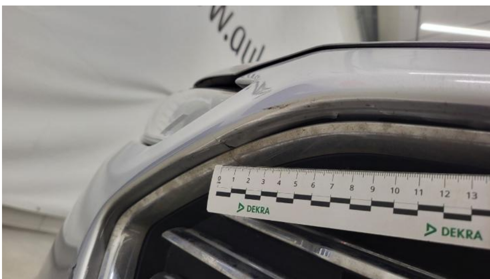
Fot. 44. Zderzak() - Pęknięcie/rozerwanie 3
