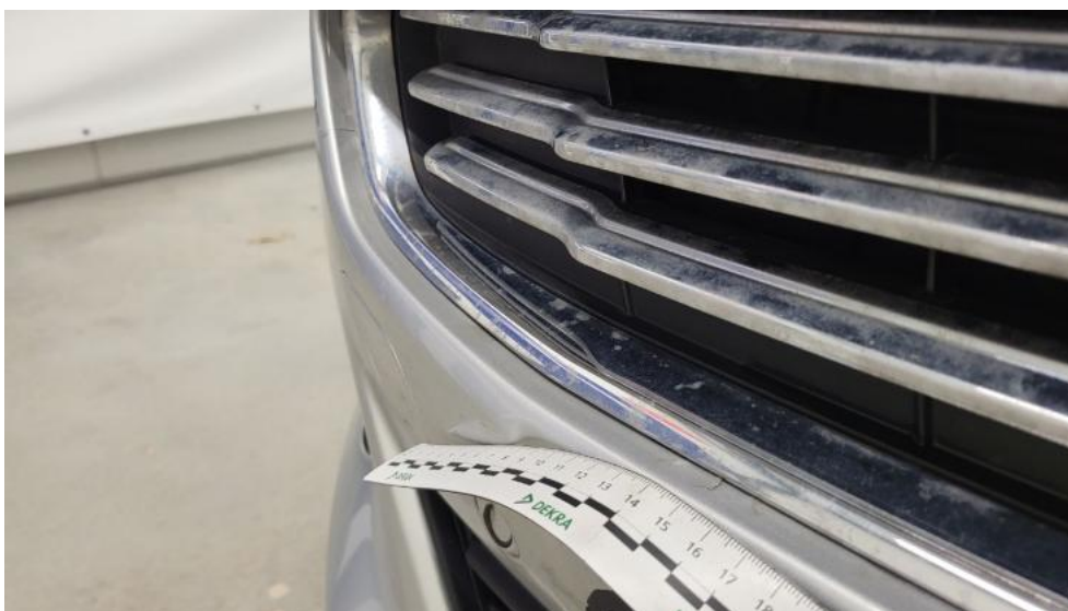
Fot. 43. Zderzak - Pęknięcie/rozerwanie 2
