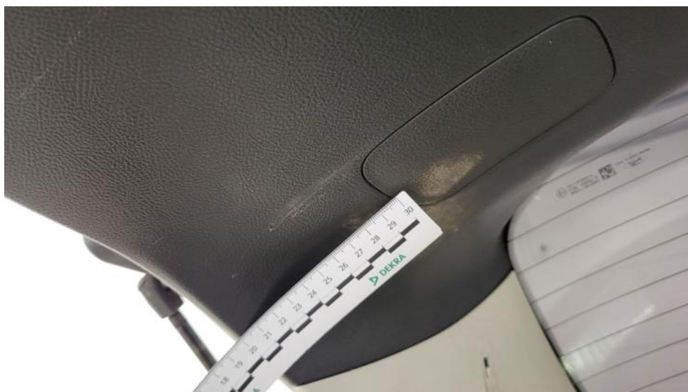
Fot. 99. Wykładzina pokrywy tylnej - Rysa/odprysk 1
