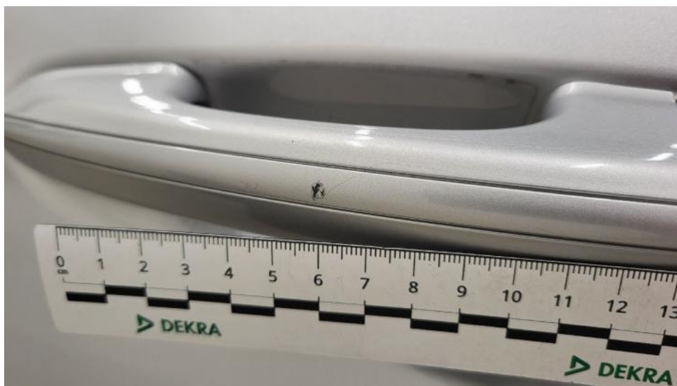
Fot. 81. Klamka drzwi prz L - Rysa/odprysk 1
