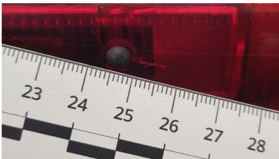
Fot. 62. Dodatkowa lampa stopu - Pęknięcie/rozerwanie 1
