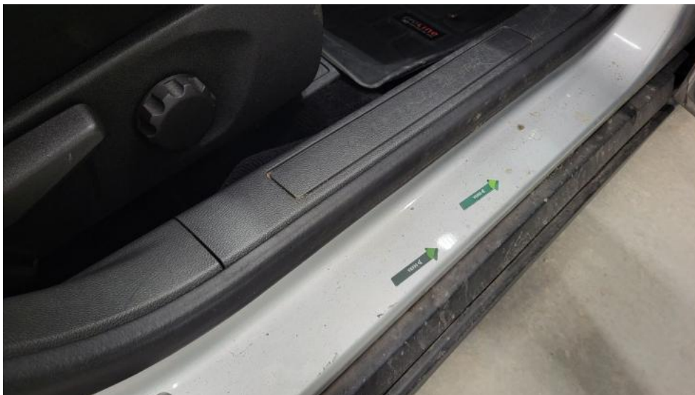
Fot. 55. Próg P - Wgniecenie/odkształcenie 1
