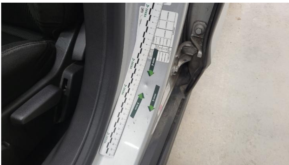
Fot. 84. Słupek środkowy L - Wgniecenie/odkształcenie 1
