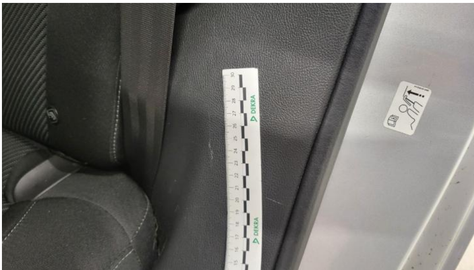
Fot. 97. Wykładzina(y) słupka tylnego L - Rysa/odprysk 1
