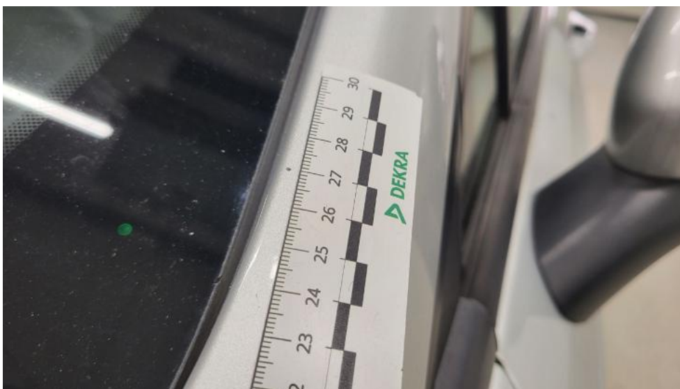
Fot. 83. Słupek przedni L - Rysa/odprysk 1
