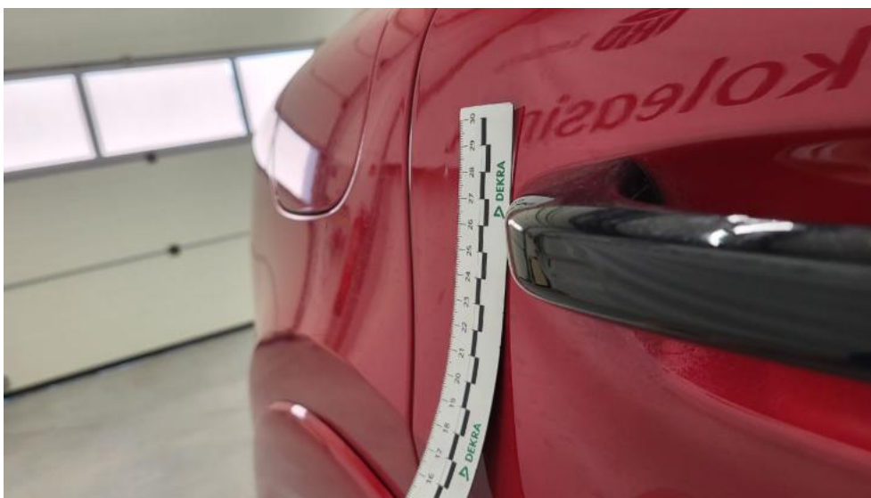
Photo 53. Drzwi tylne P - Wgniecenie/odkształcenie 2
