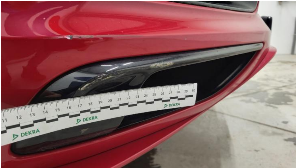
Photo 45. Kratka/zaślepka halogenu P - Rysa/odprysk 1
