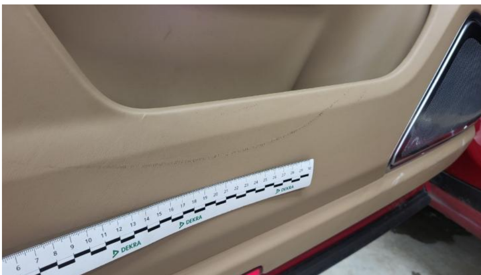
Photo 72. Tapicerka drzwi przednich L - Rysa/odprysk 1
