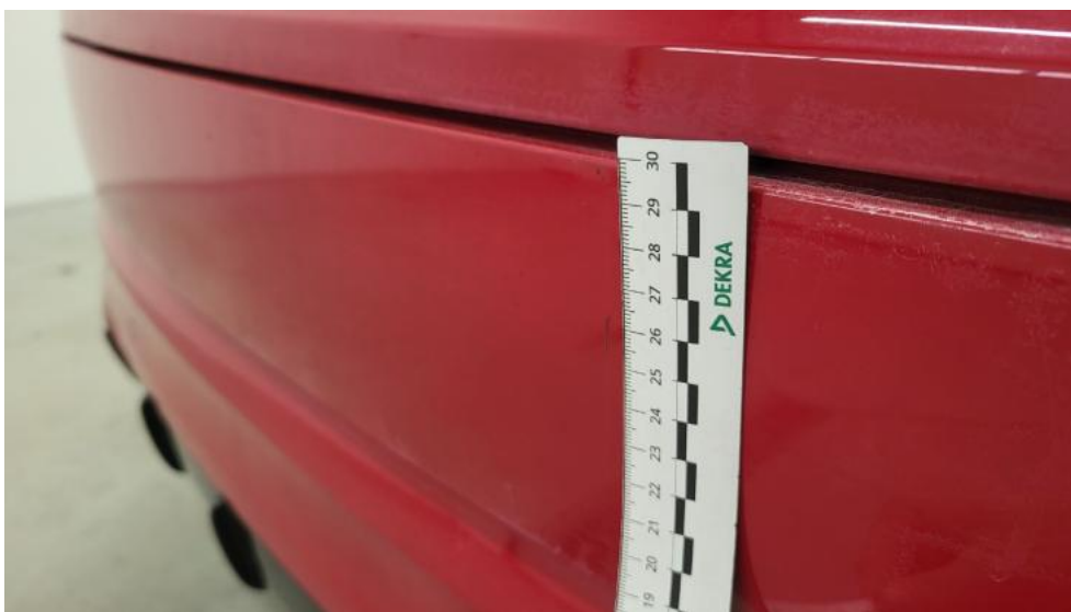
Photo 59. Zderzak tylny - Rysa/odprysk 1
