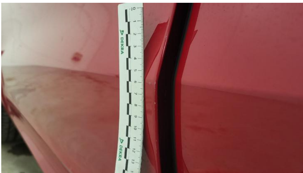
Photo 63. Drzwi przed L - Rysa/odprysk 1
