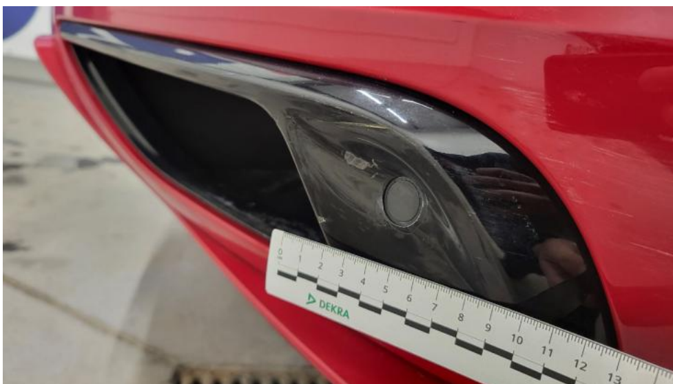
Photo 44. Kratka/zaślepka halogenu L - Rysa/odprysk 1
