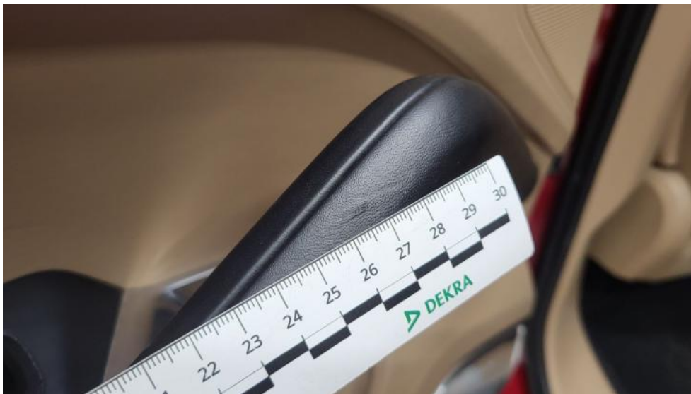
Photo 73. Uchwyt drzwi tyl L - Rysa/odprysk 1
