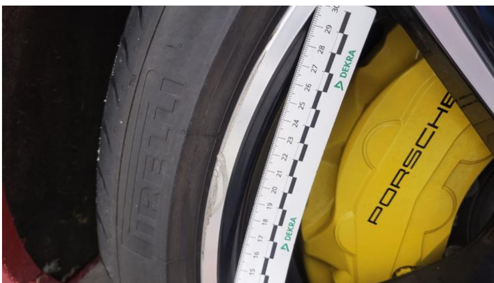
Photo 50. Felga aluminiowa przednia P - Rysa/odprysk 1
