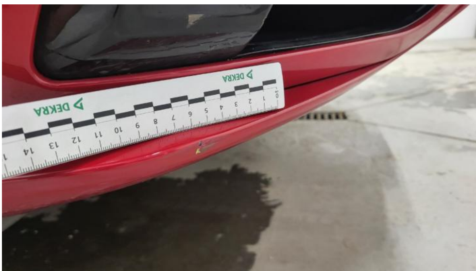
Photo 46. Spoiler zderzaka przedniego - Rysa/odprysk 1
