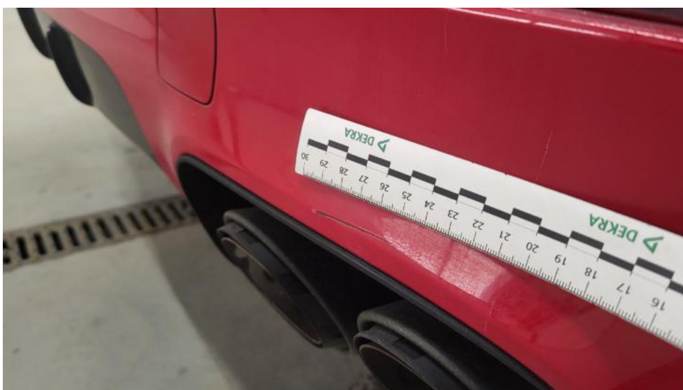
Photo 60. Zderzak tylny cz dolna - Rysa/odprysk 1
