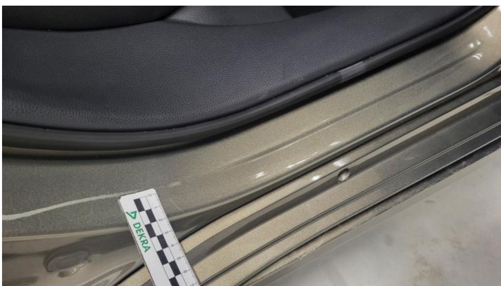
Fot. 44. Próg P - Rysa/odprysk 1
