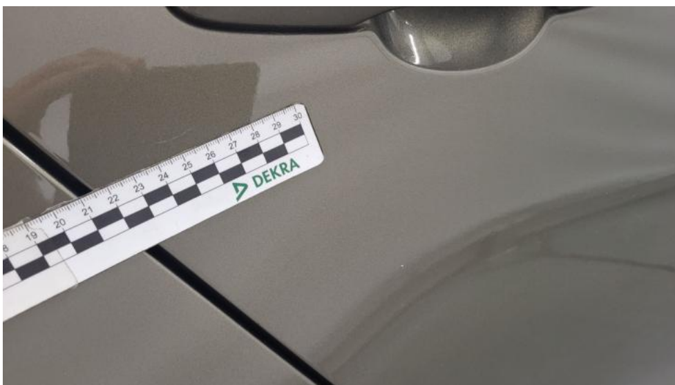
Fot. 42. Drzwi tylne P - Rysa/odprysk 1
