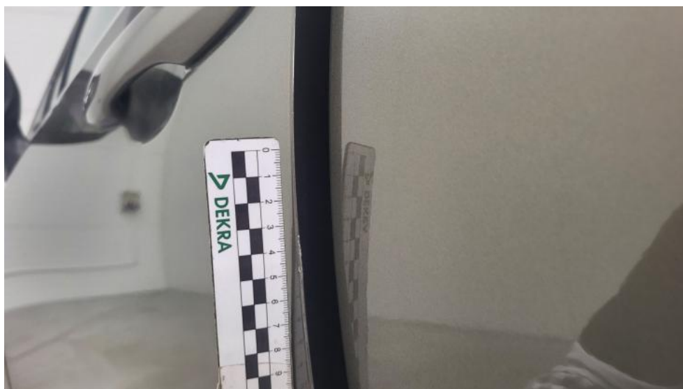
Fot. 50. Drzwi przed L - Rysa/odprysk 1
