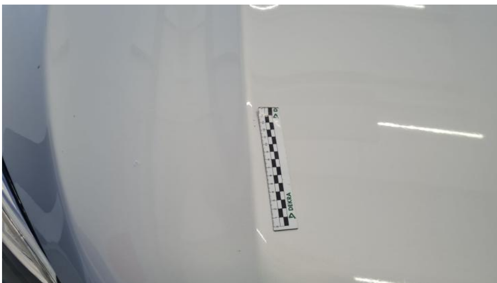
Photo 38. Pokrywa komory silnika - Rysa/odprysk 1
