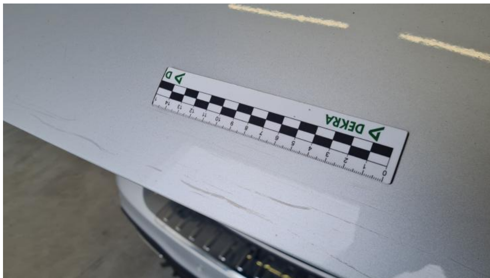
Photo 47. Pokrywy bagażnika - Rysa/odprysk 2
