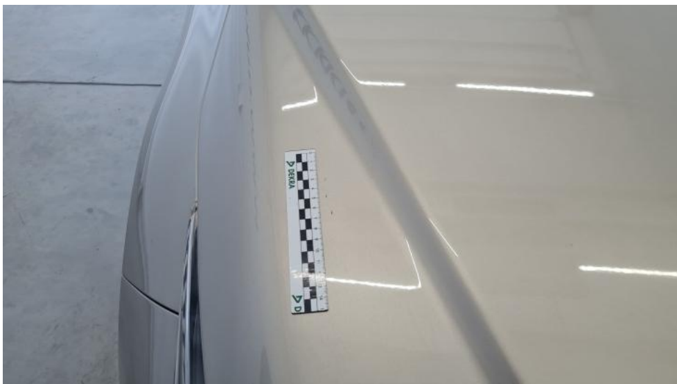
Fot. 35. Pokrywa komory silnika - Rysa/odprysk 1
