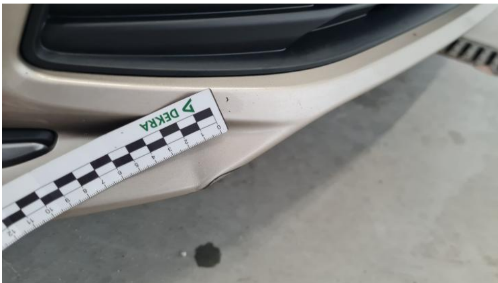
Fot. 39. Zderzak - Wgniecenie/odkształcenie 1
