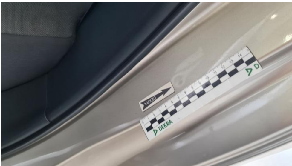
Fot. 45. Błotnik tylny L / Ściana boczna L - Wgniecenie/odkształcenie 1
