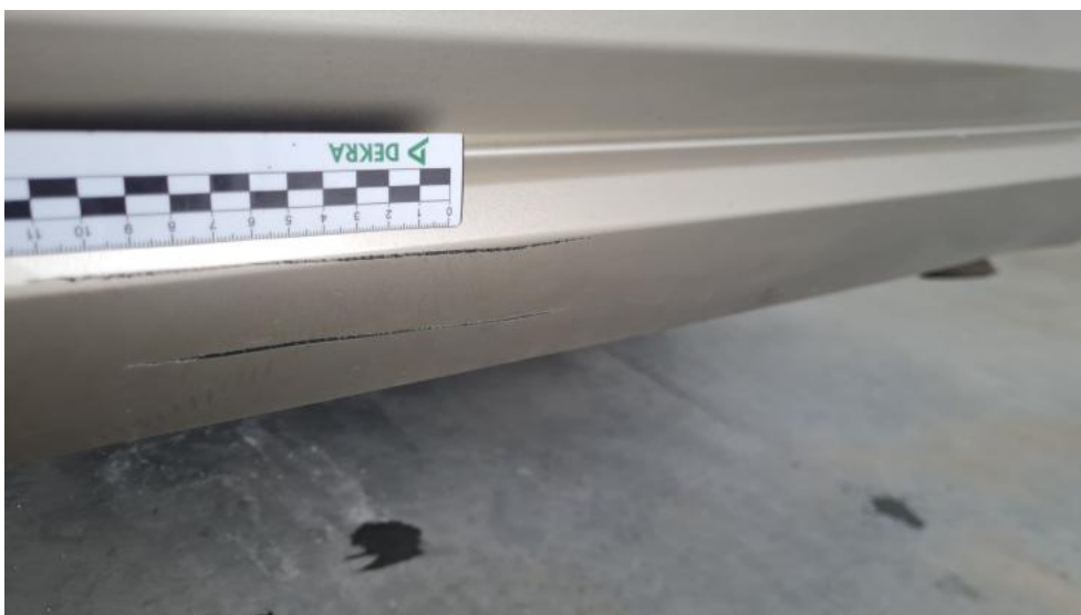
Fot. 44. Zderzak tylny - Rysa/odprysk 1
