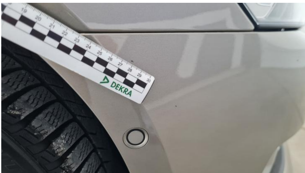
Fot. 36. Zderzak - Rysa/odprysk 1
