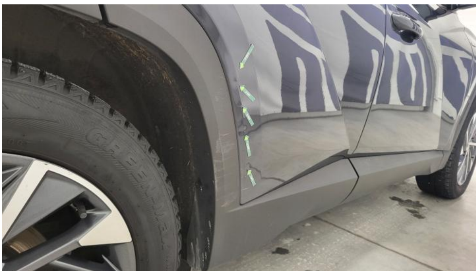
Photo 55. Drzwi tylne P() - Wgniecenie/odkształcenie 3
