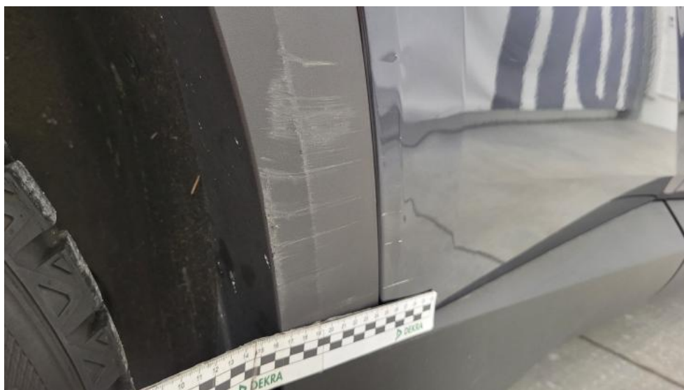
Photo 52. Drzwi tylne P - Rysa/odprysk 1
