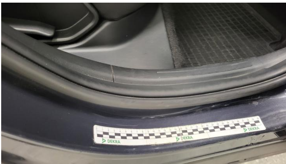
Photo 57. Próg P - Rysa/odprysk 1
