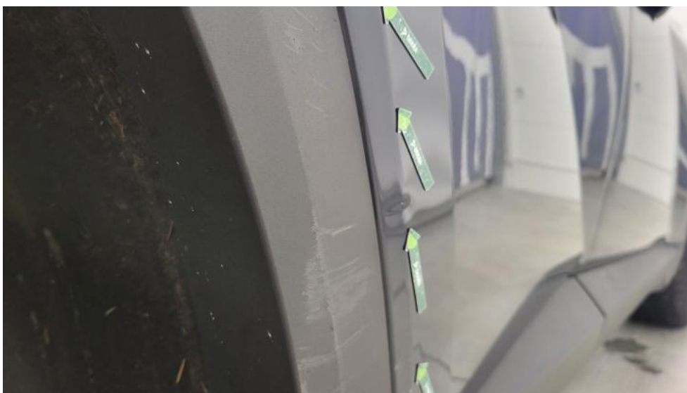
Photo 53. Drzwi tylne P - Wgniecenie/odkształcenie 1
