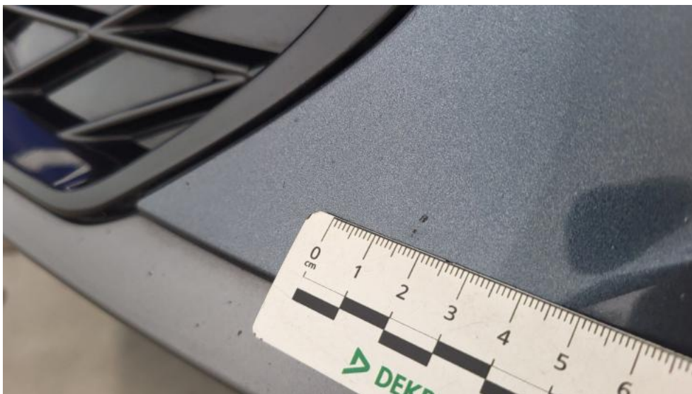
Fot. 53. Zderzak - Rysa/odprysk 1
