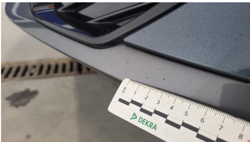
Fot. 54. Zderzak przedni cz L - Rysa/odprysk 1
