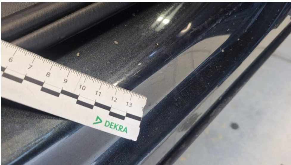
Fot. 61. Próg P - Rysa/odprysk 1
