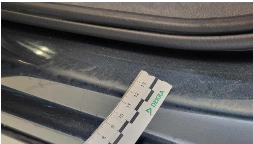
Fot. 76. Próg L - Rysa/odprysk 1
