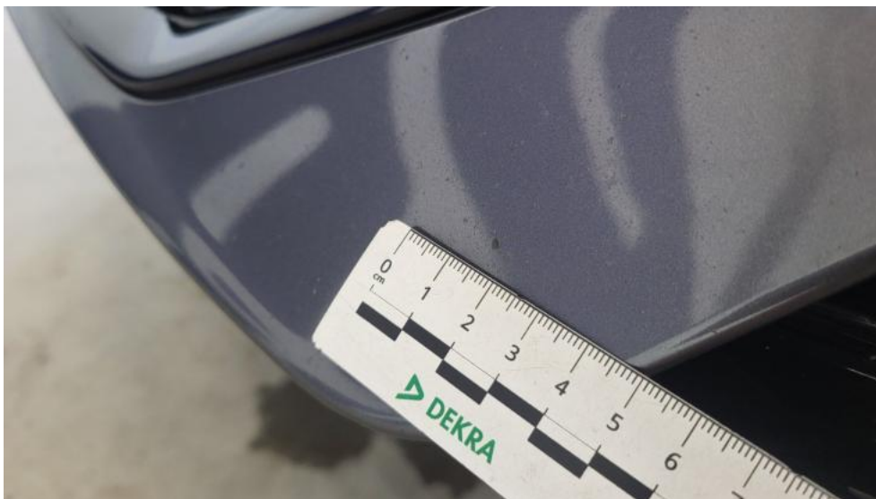
Fot. 55. Zderzak przedni cz P - Rysa/odprysk 1
