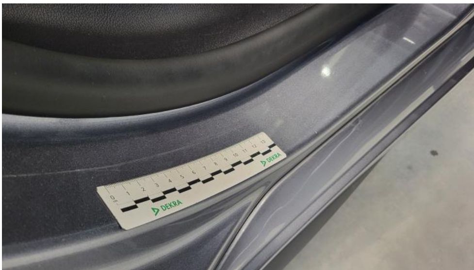
Photo 47. Próg P - Rysa/odprysk 1
