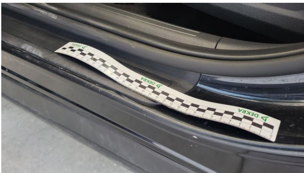
Fot. 65. Próg L - Rysa/odprysk 1
