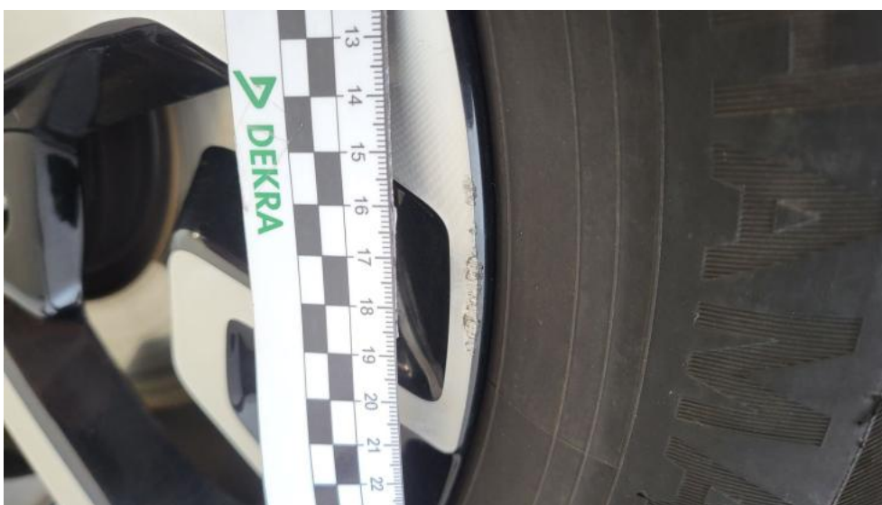
Fot. 66. Felga Aluminiowa przednia L - Rysa/odprysk 1
