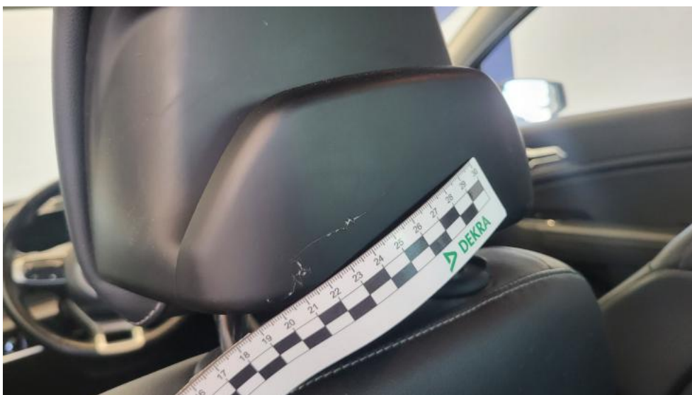
Fot. 72. Zaglówek fotela prz. L - Rysa/odprysk 1
