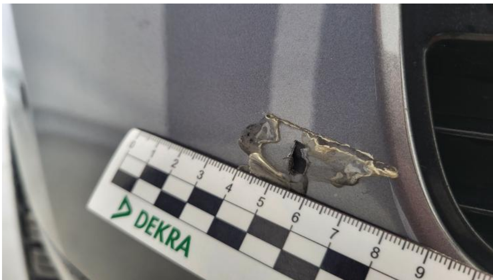
Fot. 60. Zderzak - Rysa/odprysk 1
