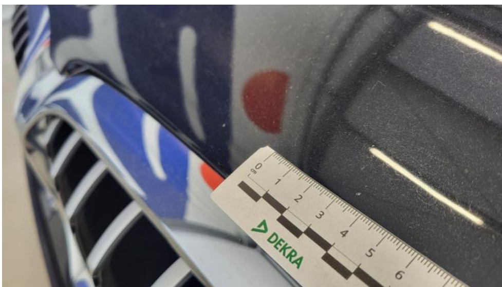
Photo 41. Pokrywa komory silnika - Rysa/odprysk 1
