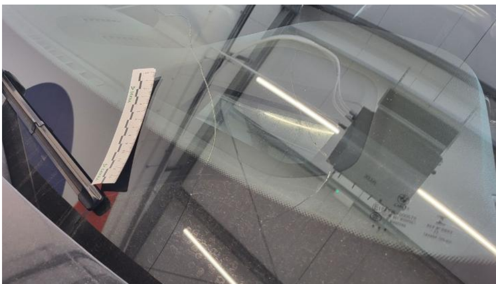
Photo 43. Szyba czołowa - Pęknięcie/rozerwanie 1
