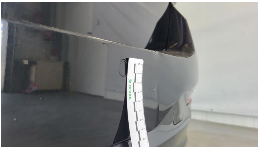
Photo 52. Zderzak tylny - Wgniecenie/odkształcenie 2
