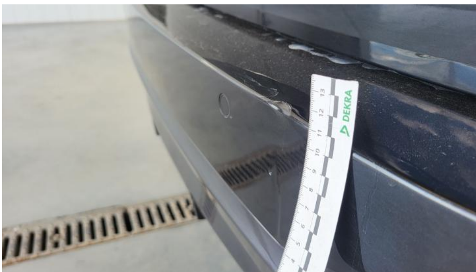
Photo 51. Zderzak tylny - Wgniecenie/odkształcenie 1
