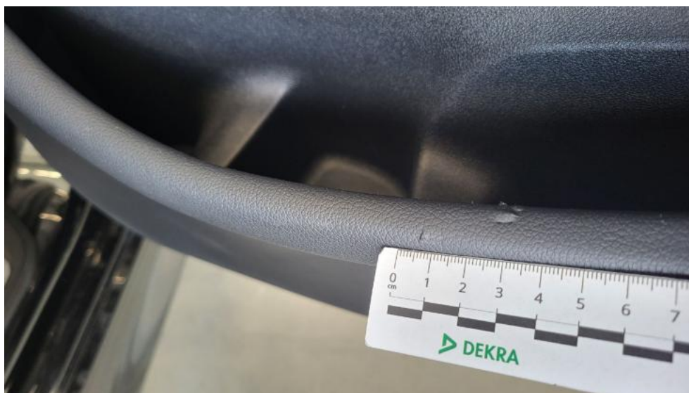
Photo 57. Tapicerka drzwi tylnych P - Pęknięcie/rozerwanie 1
