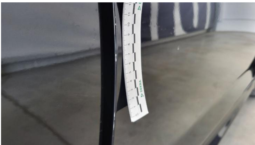
Photo 48. Drzwi przednie P - Rysa/odprysk 1
