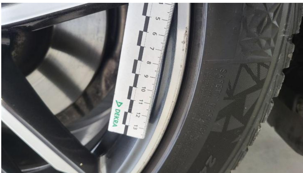
Photo 47. Felga aluminiowa przednia P - Rysa/odprysk 1
