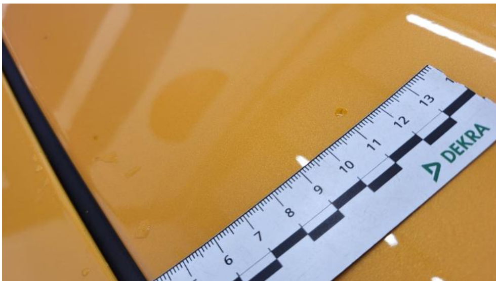
Photo 38. Pokrywa komory silnika - Rysa/odprysk 1
