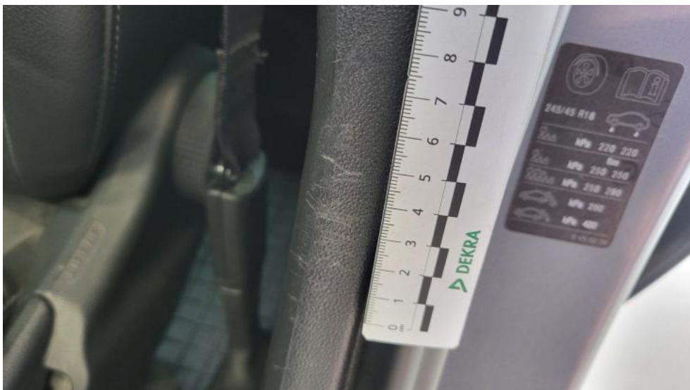
Photo 72. Wykładzina(y) słupka środkowego L - Rysa/odprysk 1
