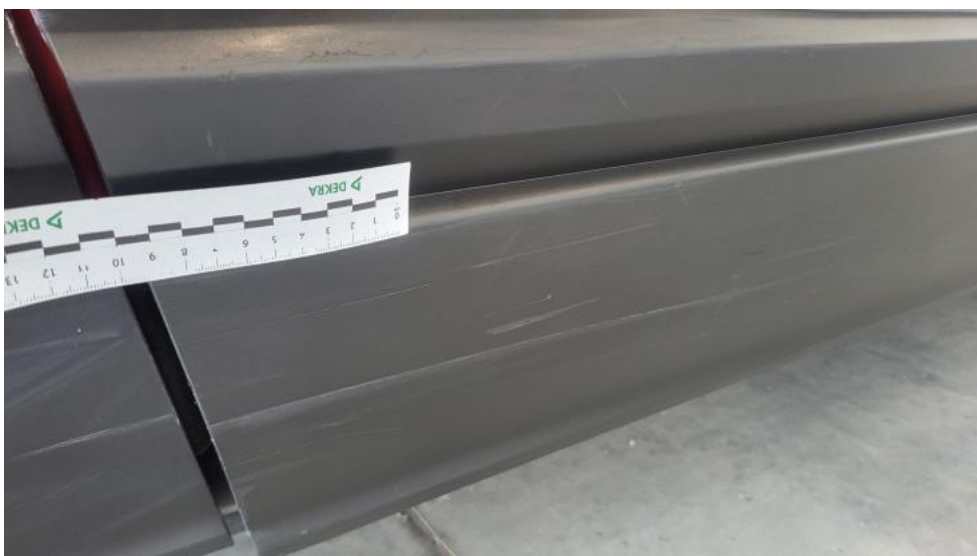
Photo 66. Listwa drzwi przednich P - Rysa/odprysk 1
