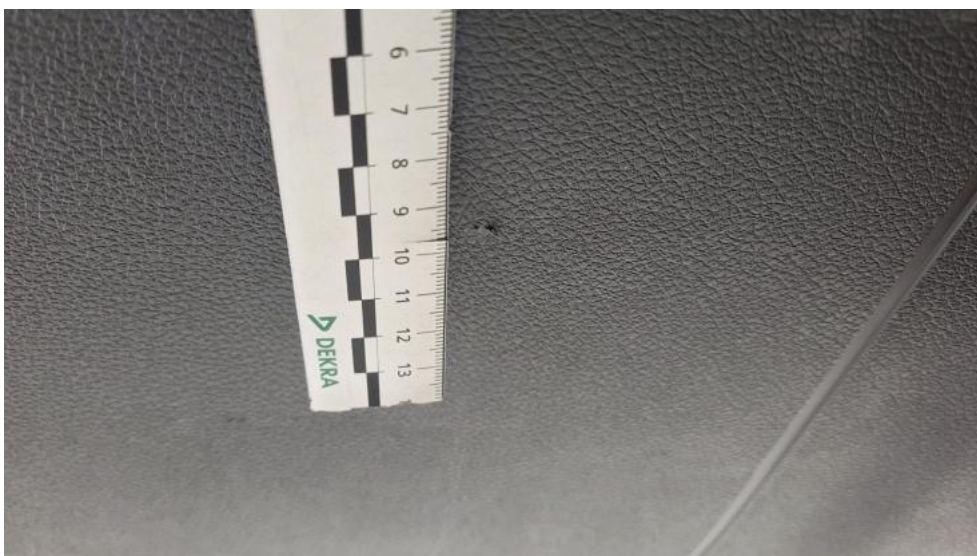
Fot. 80. Wykładzina pokrywy tylnej - Rysa/odprysk 1
