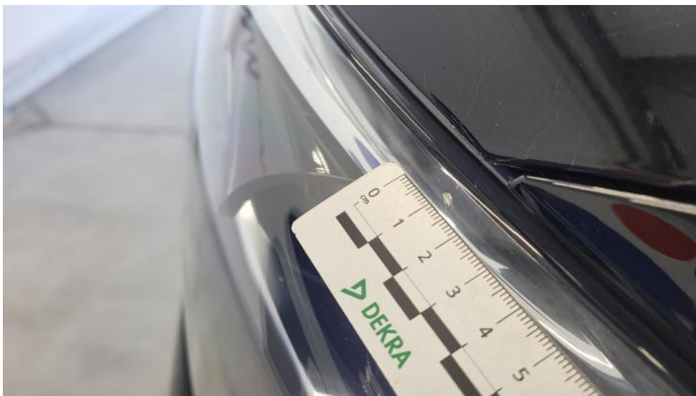
Fot. 49. Reflektor P - Rysa/odprysk 1
