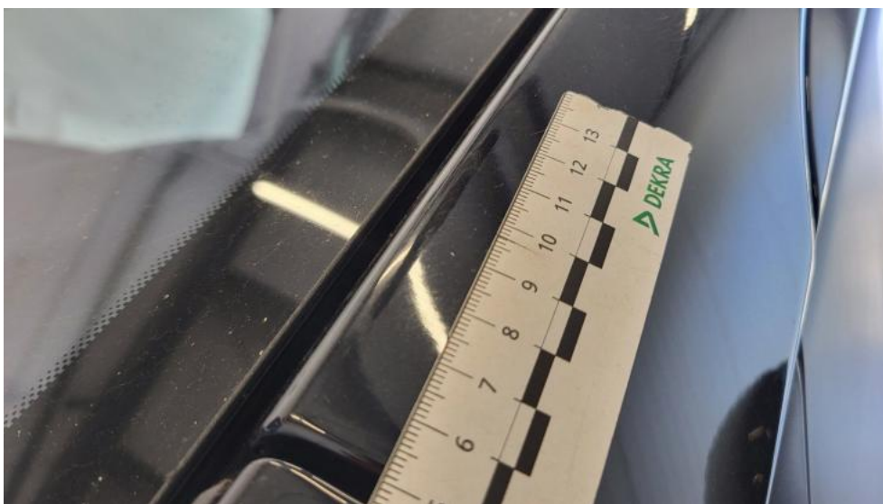
Fot. 76. Słupek przedni L - Rysa/odprysk 1
