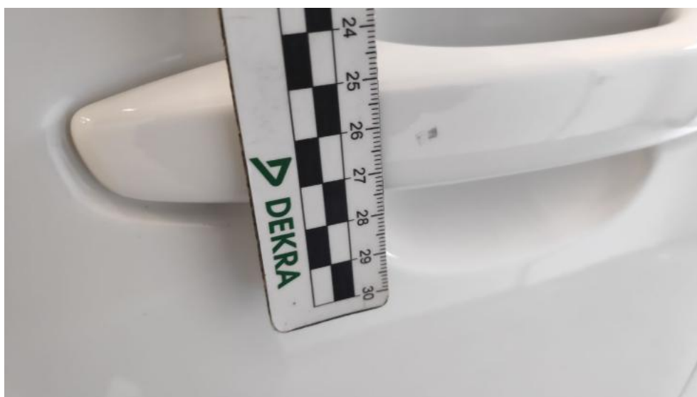
Fot. 54. Klamka drzwi prz L - Rysa/odprysk 1
