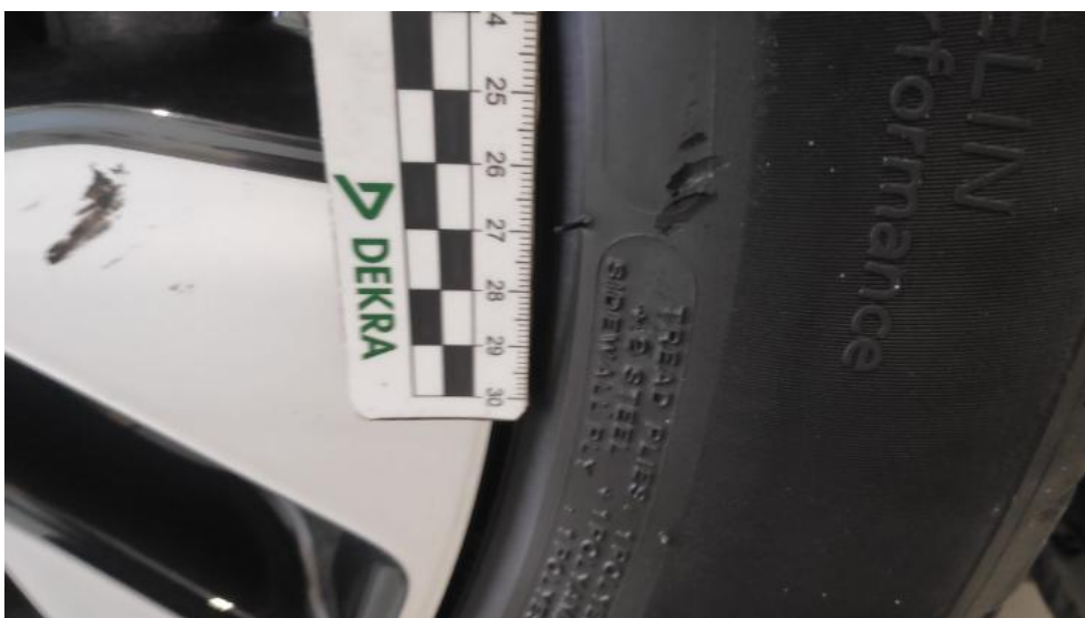
Fot. 45. Opona przednia P - Rysa/odprysk 1
