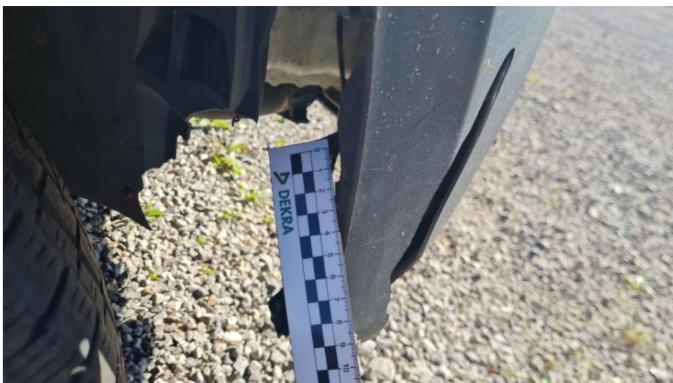
Fot. 36. Nadkole przednie P - Pęknięcie/rozerwanie 1
