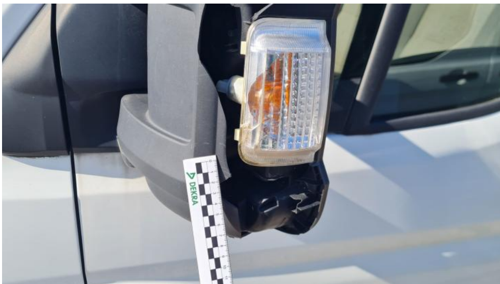
Fot. 59. Lusterko zew L - Pęknięcie/rozerwanie 1
