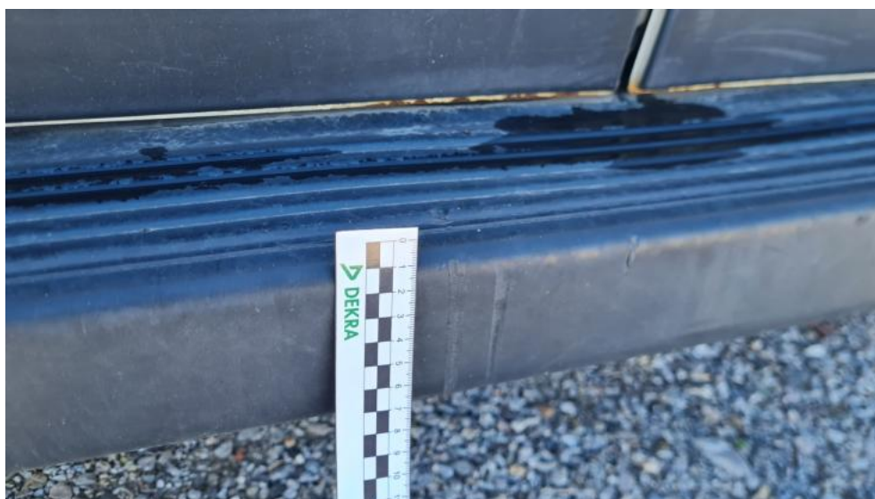
Fot. 53. Zderzak tylny - Rysa/odprysk 2
