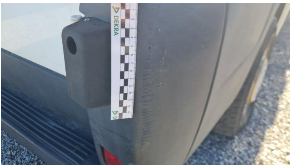
Fot. 52. Zderzak tylny - Rysa/odprysk 1
