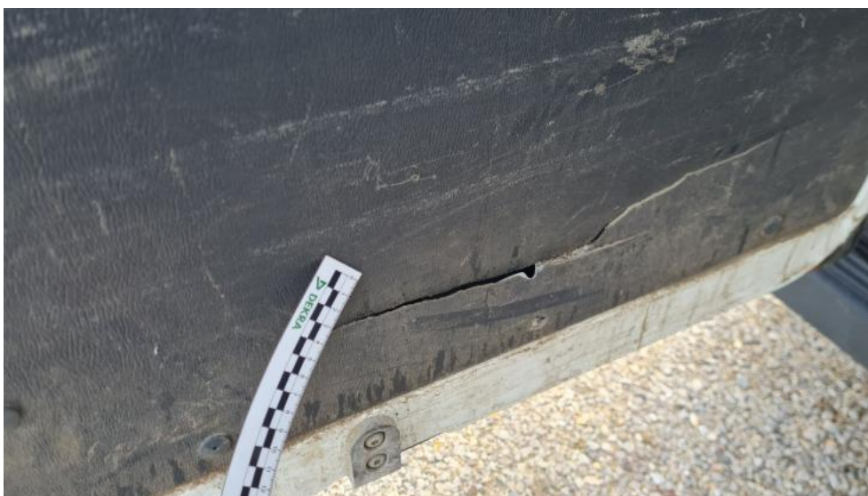
Fot. 68. Drzwi tyłu lewe - Pęknięcie/rozerwanie 1
