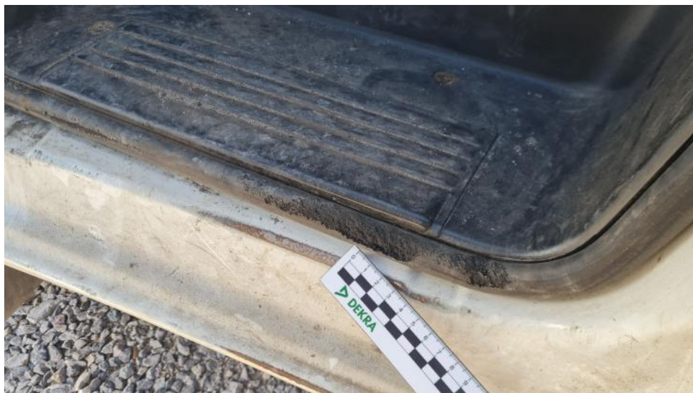
Fot. 63. Uszczelka drzwi przednich L - Pęknięcie/rozerwanie 1
