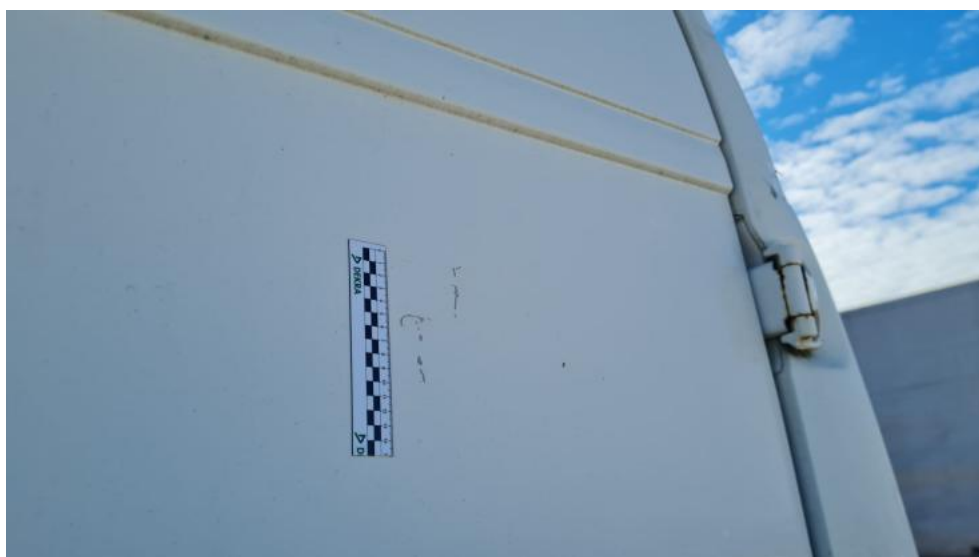
Fot. 71. Drzwi tyłu prawe - Rysa/odprysk 1
