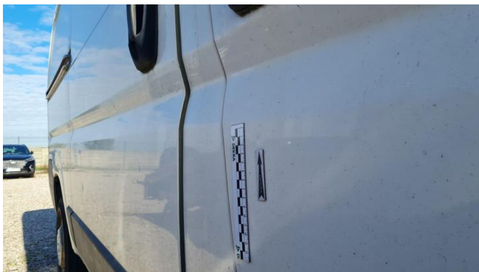
Fot. 38. Drzwi przednie P - Wgniecenie/odkształcenie 1
