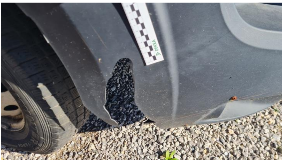
Fot. 34. Zderzak - Pęknięcie/rozerwanie 2
