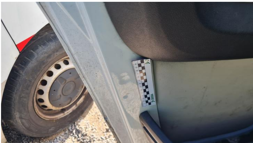
Fot. 57. Drzwi przed L - Wgniecenie/odkształcenie 1
