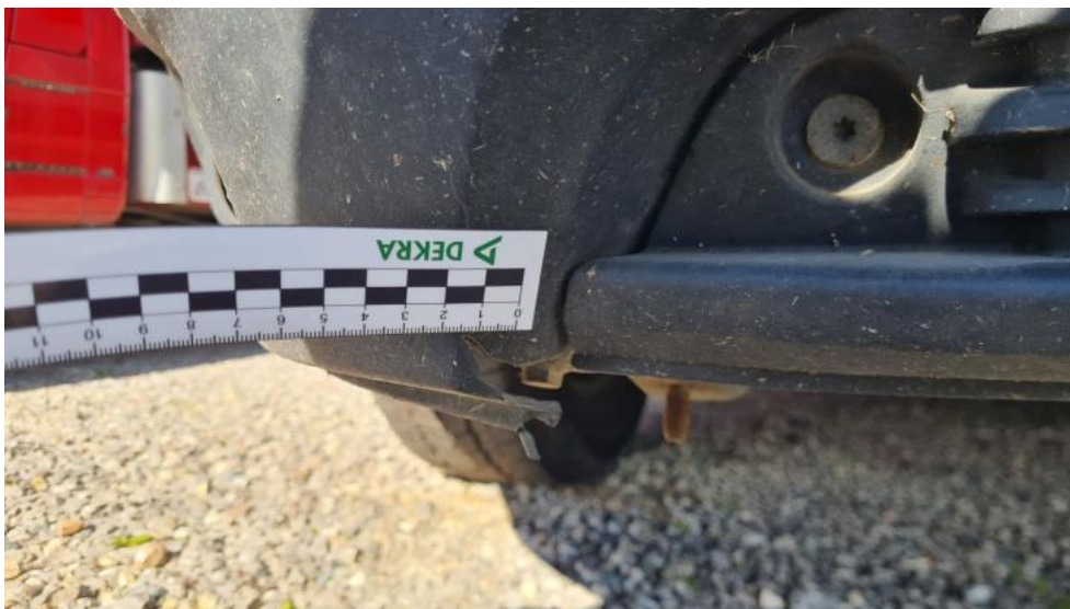
Fot. 33. Zderzak - Pęknięcie/rozerwanie 1
