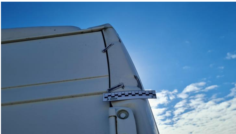
Fot. 51. Błotnik tylny P / Ściana boczna P - Wgniecenie/odkształcenie 2
