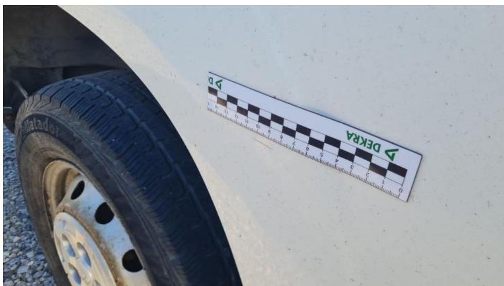
Fot. 49. Błotnik tylny P / Ściana boczna P - Rysa/odprysk 1
