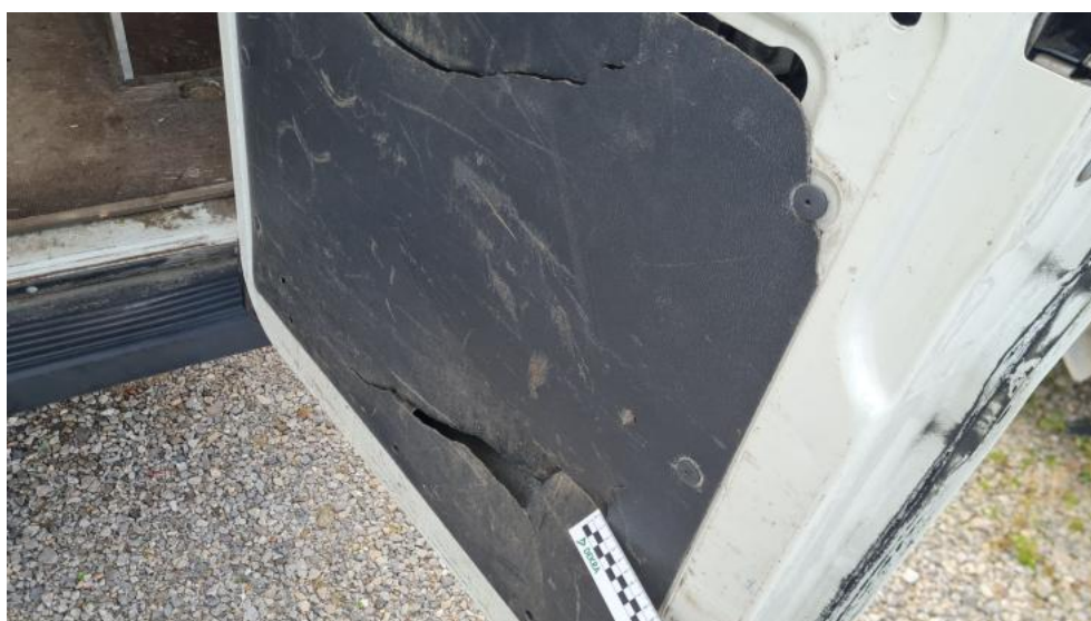
Fot. 72. Drzwi tyłu prawe - Pęknięcie/rozerwanie 1
