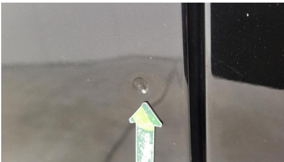
Fot. 79. Drzwi przed L - Rysa/odprysk 2
