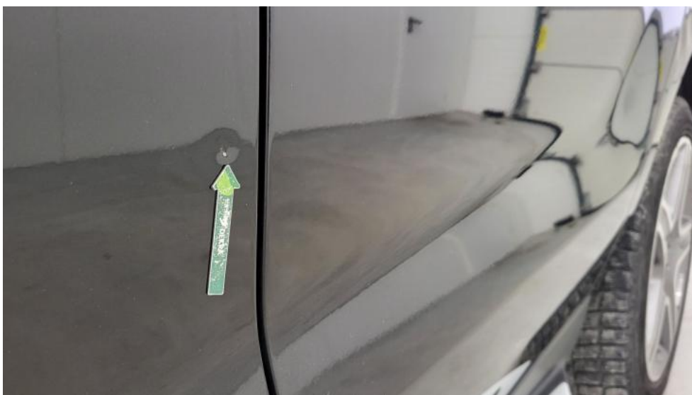
Fot. 80. Drzwi przed L - Wgniecenie/odkształcenie 1
