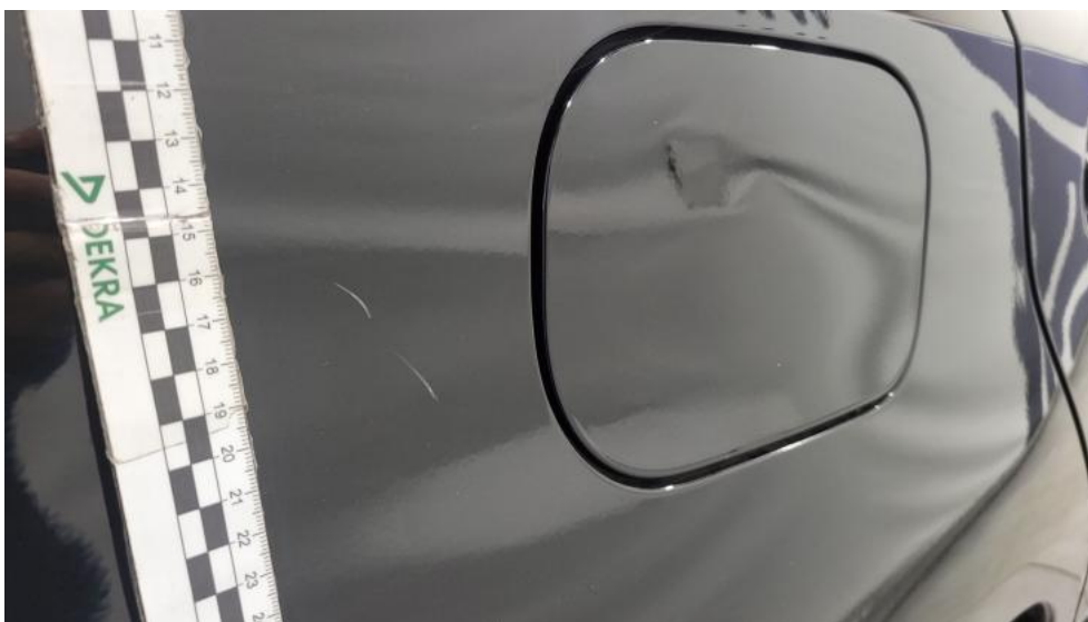
Fot. 65. Błotnik tylny P / Ściana boczna P - Rysa/odprysk 1
