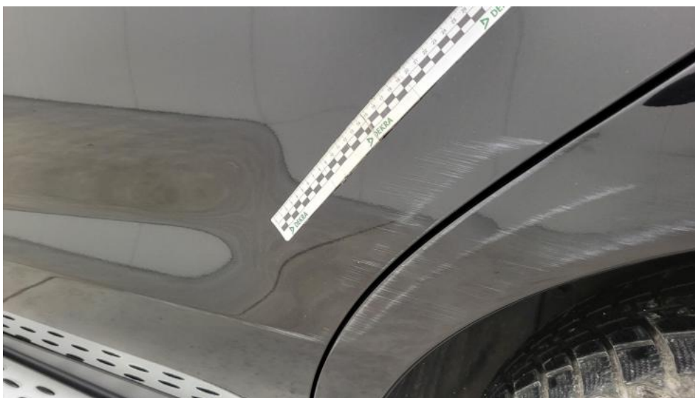
Fot. 81. Drzwi tylne L - Rysa/odprysk 1
