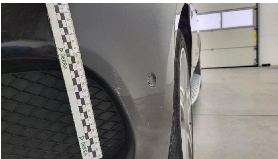
Fot. 51. Zderzak - Rysa/odprysk 2
