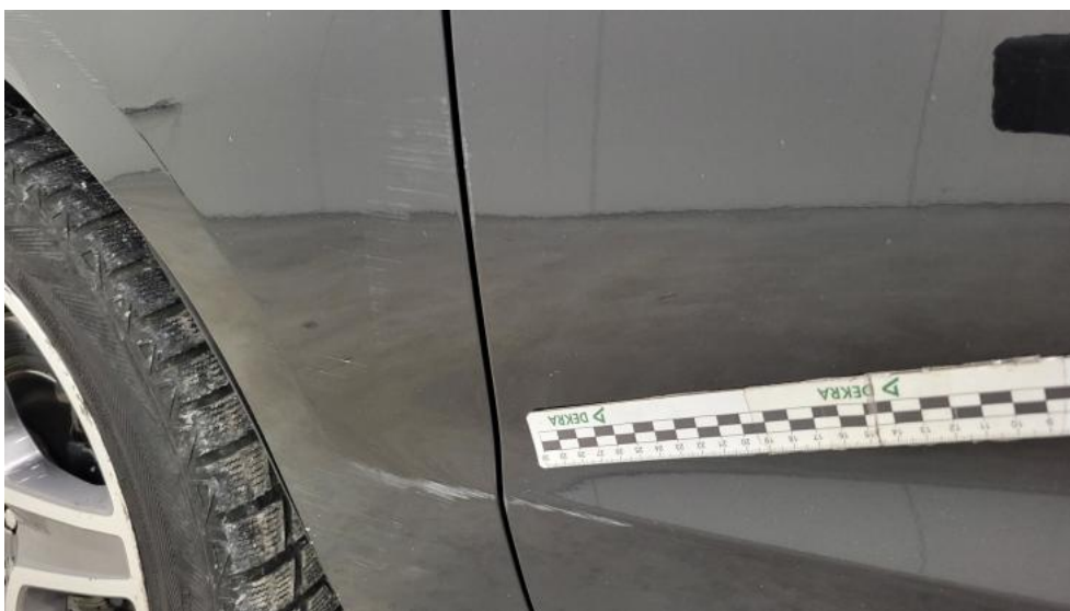
Fot. 78. Drzwi przed L - Rysa/odprysk 1
