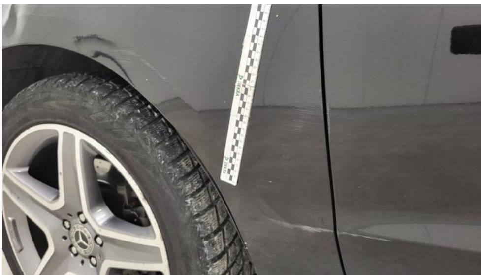
Fot. 86. Błotnik przedni L() - Rysa/odprysk 3
