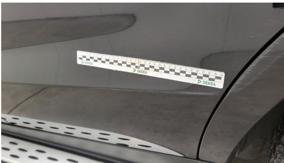
Fot. 82. Drzwi tylne L - Rysa/odprysk 2
