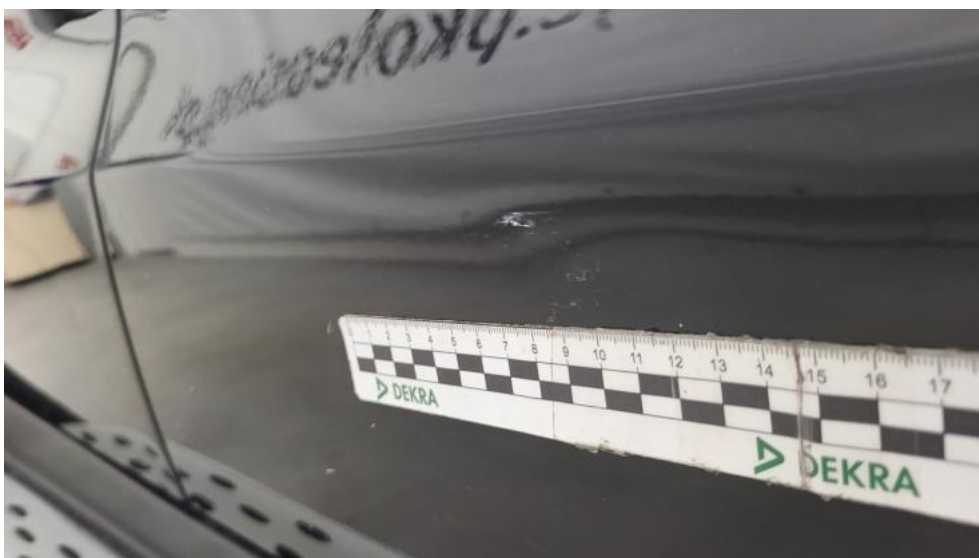
Fot. 60. Drzwi przednie P - Rysa/odprysk 2
