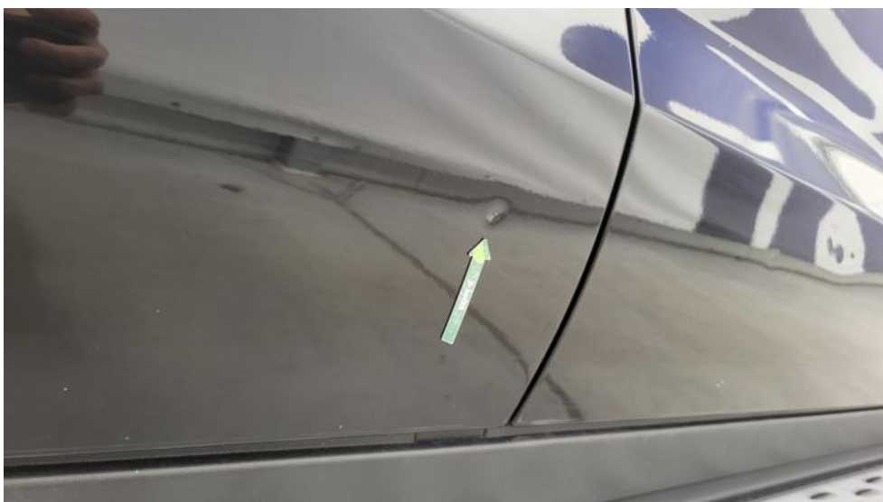
Fot. 64. Drzwi tylne P - Wgniecenie/odkształcenie 1
