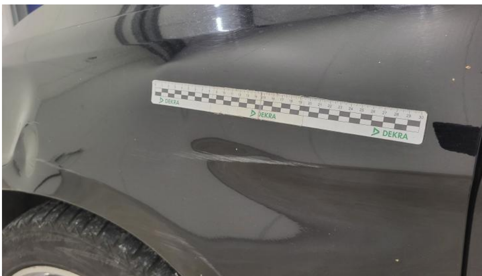
Fot. 85. Błotnik przedni L - Rysa/odprysk 2
