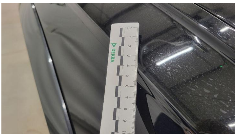
Fot. 48. Błotnik przedni P - Rysa/odprysk 1
