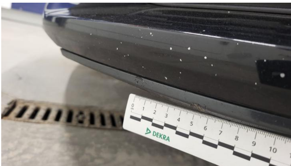
Fot. 46. Zderzak przedni cz L - Rysa/odprysk 1
