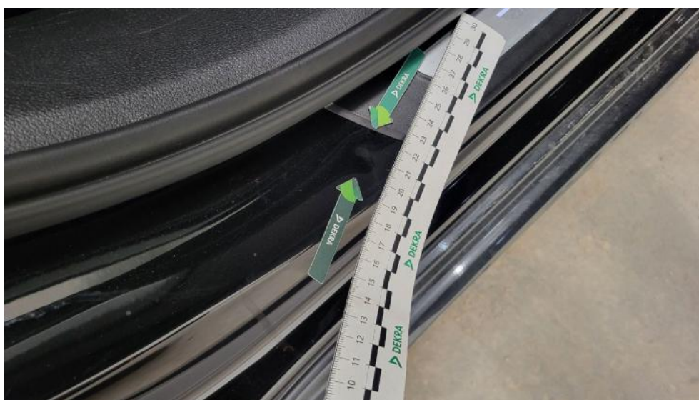
Fot. 52. Próg P - Wgniecenie/odkształcenie 1
