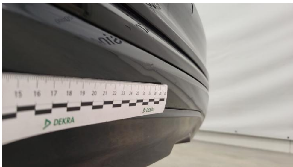
Fot. 56. Zderzak tylny cz dolna - Wgniecenie/odkształcenie 1
