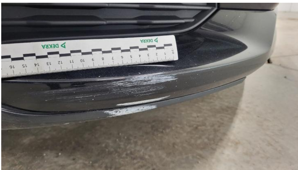
Fot. 45. Zderzak przedni cz dolna - Rysa/odprysk 1
