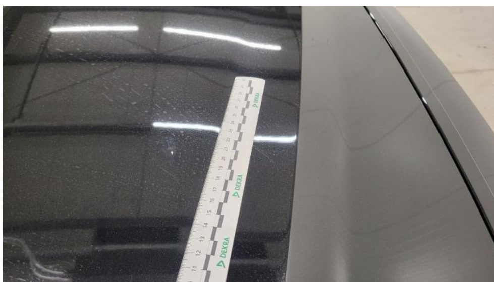
Fot. 44. Pokrywa komory silnika - Rysa/odprysk 2
