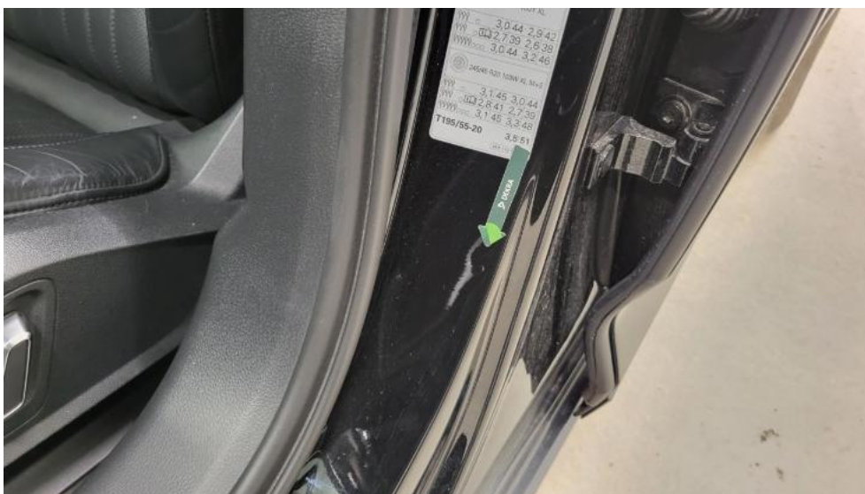
Fot. 63. Stupek środkowy L - Wgniecenie/odkształcenie 1
