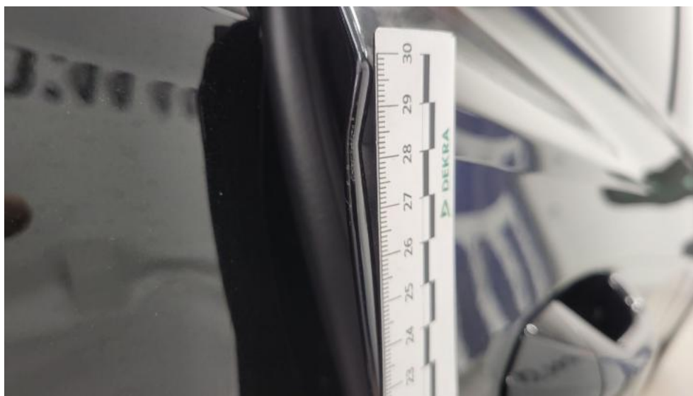
Fot. 51. Drzwi tylne P - Rysa/odprysk 2
