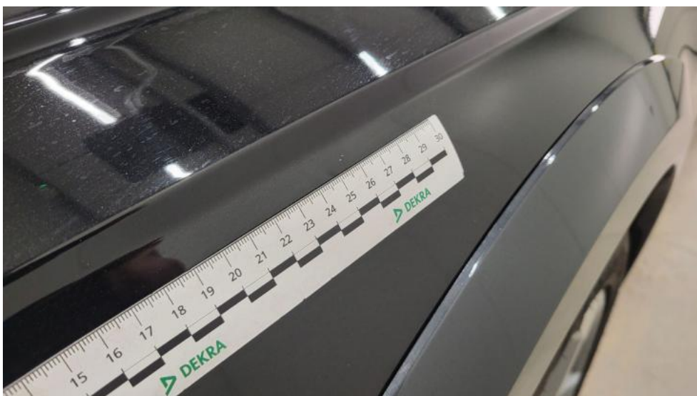
Fot. 64. Błotnik przedni L - Rysa/odprysk 1
