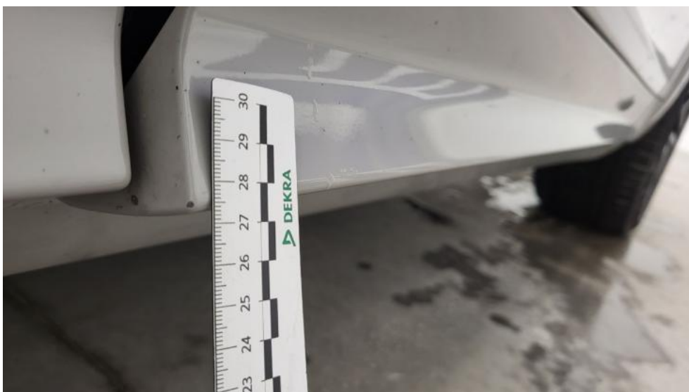
Fot. 60. Listwa drzwi przednich P - Rysa/odprysk 1
