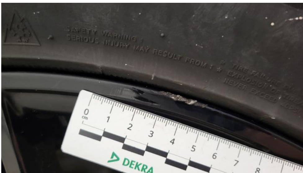
Fot. 56. Felga aluminiowa przednia P - Rysa/odprysk 1
