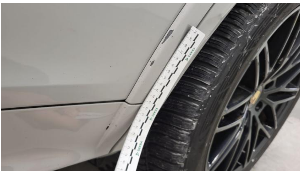
Fot. 73. Listwa drzwi tylnych L - Rysa/odprysk 2
