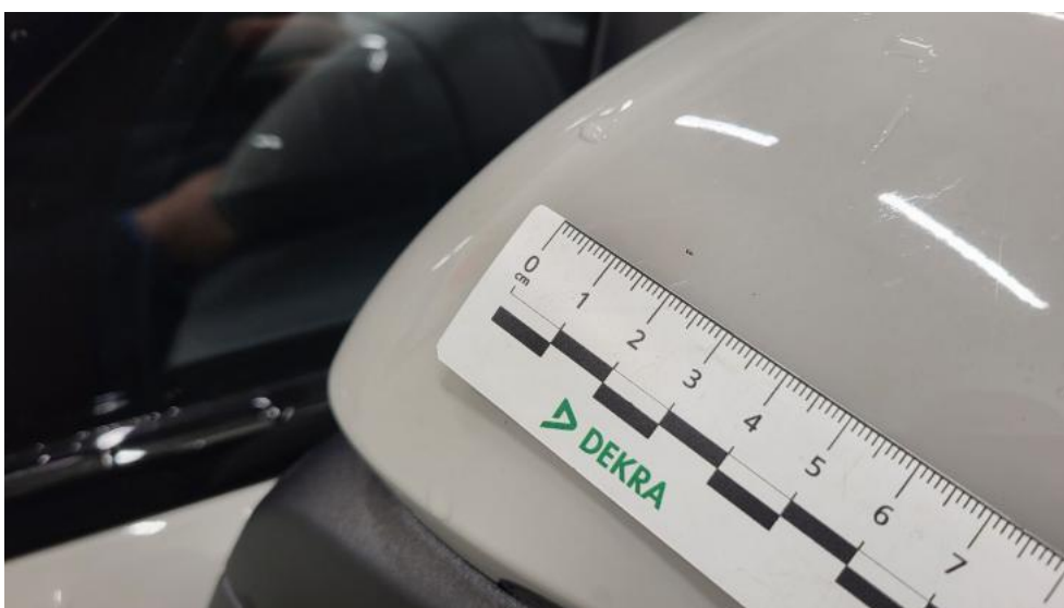
Fot. 74. Lusterko zew L - Rysa/odprysk 1
