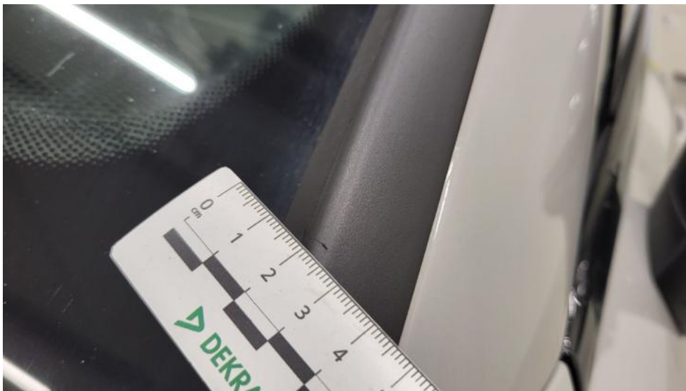
Fot. 53. Uszczelka/listwa szyby czołowej - Rysa/odprysk 1
