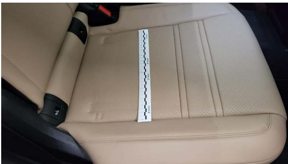
Fot. 76. Kanapa tyl. - Wgniecenie/odkształcenie 1
