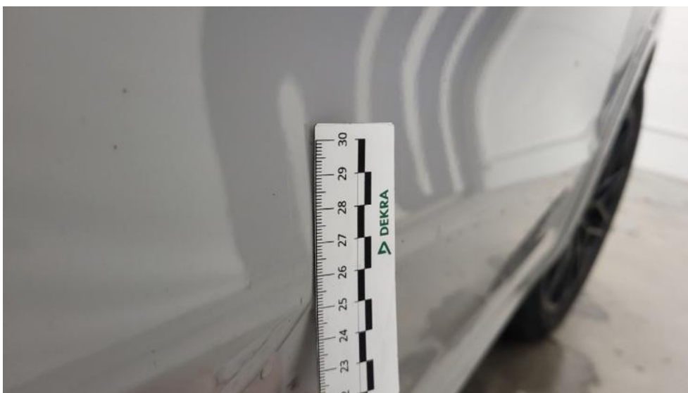
Fot. 58. Drzwi przednie P - Rysa/odprysk 1
