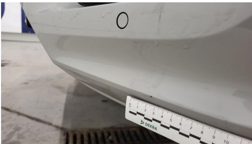
Fot. 54. Zderzak - Rysa/odprysk 1
