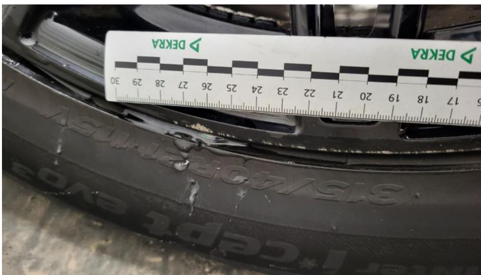
Fot. 63. Felga aluminiowa tylna P - Rysa/odprysk 1
