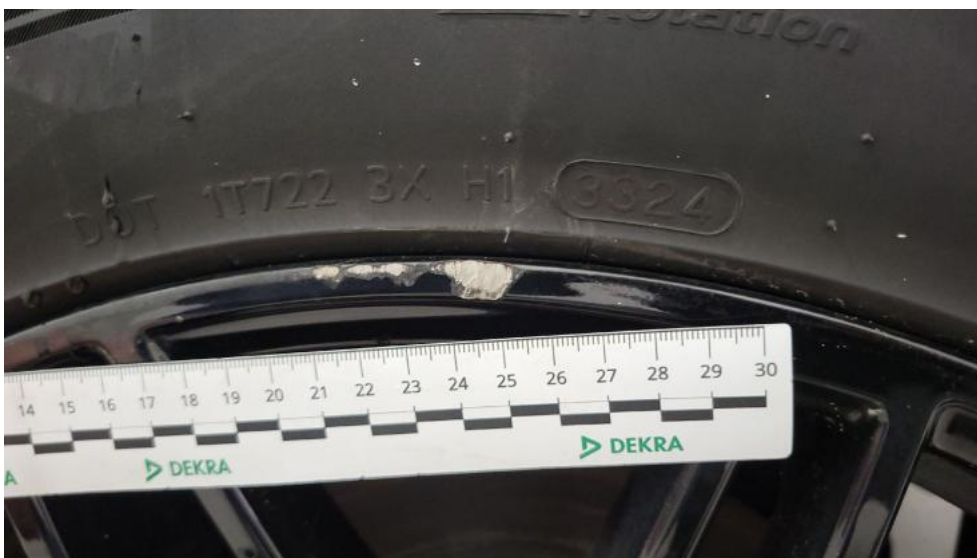
Fot. 70. Felga aluminiowa tylna L - Rysa/odprysk 1
