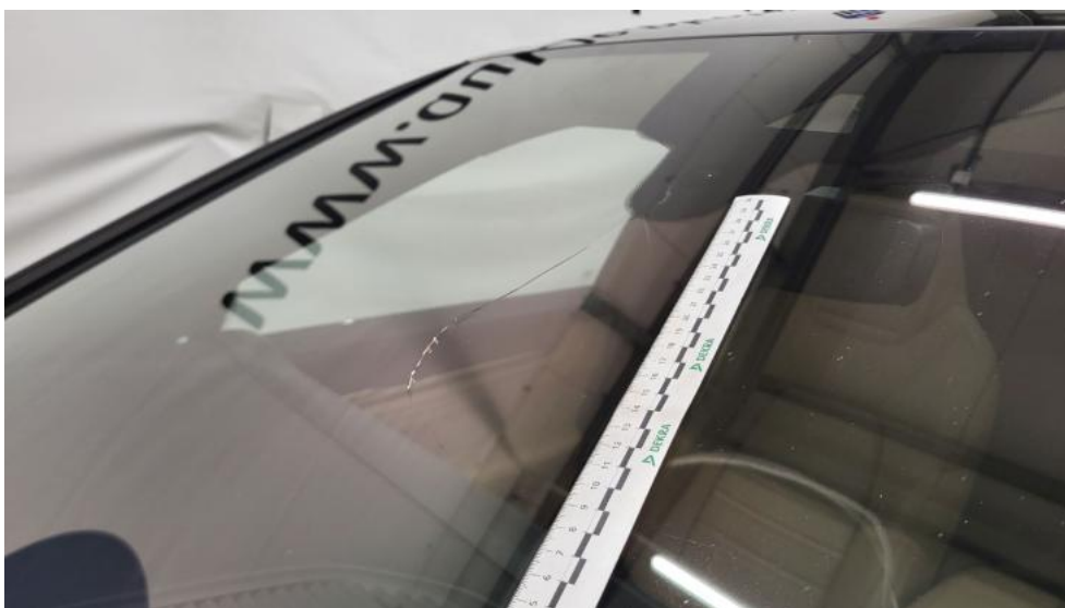
Fot. 52. Szyba czołowa - Pęknięcie/rozerwanie 1
