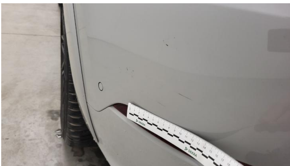
Fot. 68. Zderzak tylny cz L - Rysa/odprysk 2
