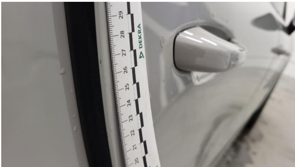
Fot. 59. Drzwi tylne P - Rysa/odprysk 1
