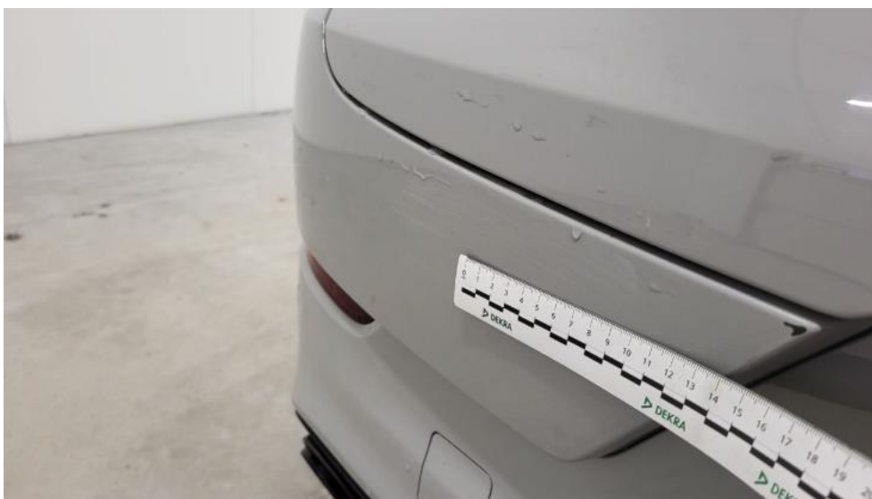
Fot. 67. Zderzak tylny cz L - Rysa/odprysk 1
