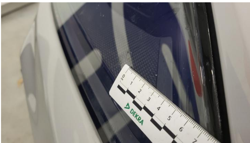
Fot. 57. Reflektor P - Rysa/odprysk 1
