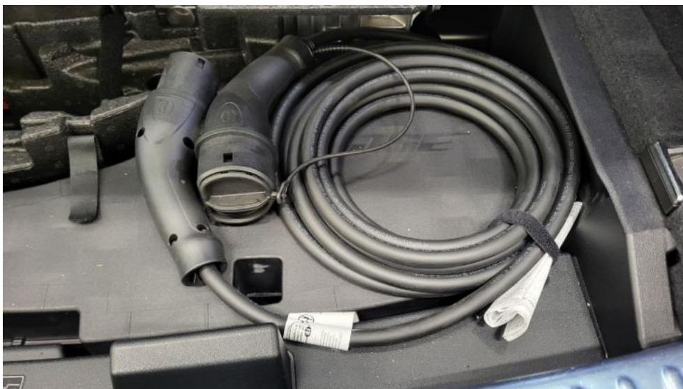
Fot. 36. Przewód ładowania baterii trakcyjnej
