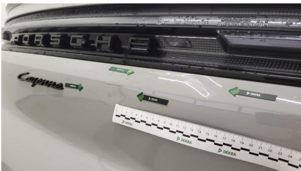
Fot. 66. Pokrywy bagażnika - Wgniecenie/odkształcenie 1
