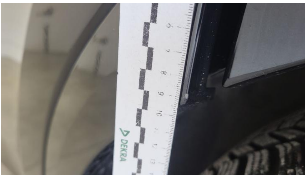
Photo 63. Listwa drzwi tylnych L - Rysa/odprysk 1
