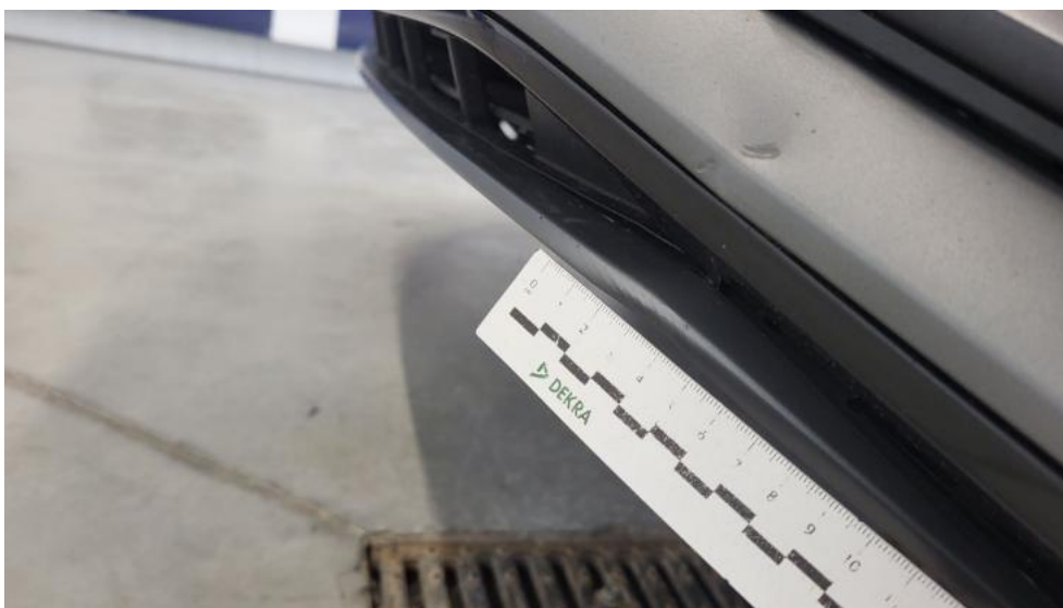
Photo 47. Spoiler zderzaka przedniego - Wgniecenie/odkształcenie 1
