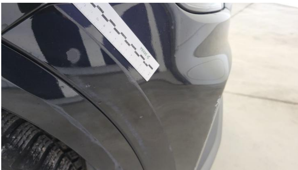
Photo 51. Zderzak przedni cz L - Rysa/odprysk 1
