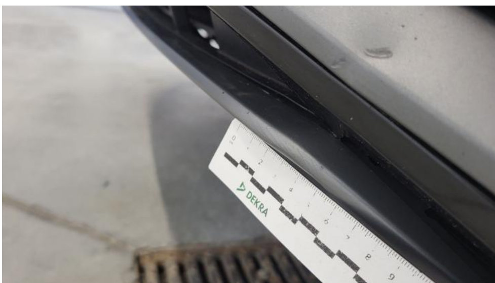
Photo 48. Spoiler zderzaka przedniego - Pęknięcie/rozerwanie 1
